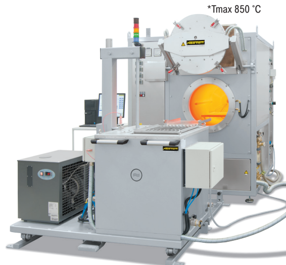
Installation de revenu semi-automatique avec four moufle NR 50/11 et bac de trempé à l'eau sur rails
