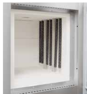
排胶系统的垂直悬挂式 SiC 棒和可选配的多孔进气管
