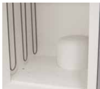
通过炉底进行充气的过程用罩保护炉膛免遭污染，或防止在批料和加热元件之间出现化学性相互作用
