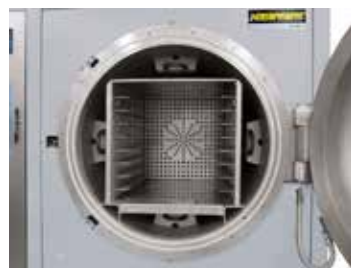
带有内加热装置和工艺腔的反应罐
