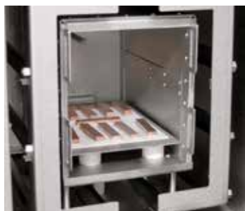
在氢气环境下，在 VHT 8/16-MO 炉型内对铜棒进行热处理
