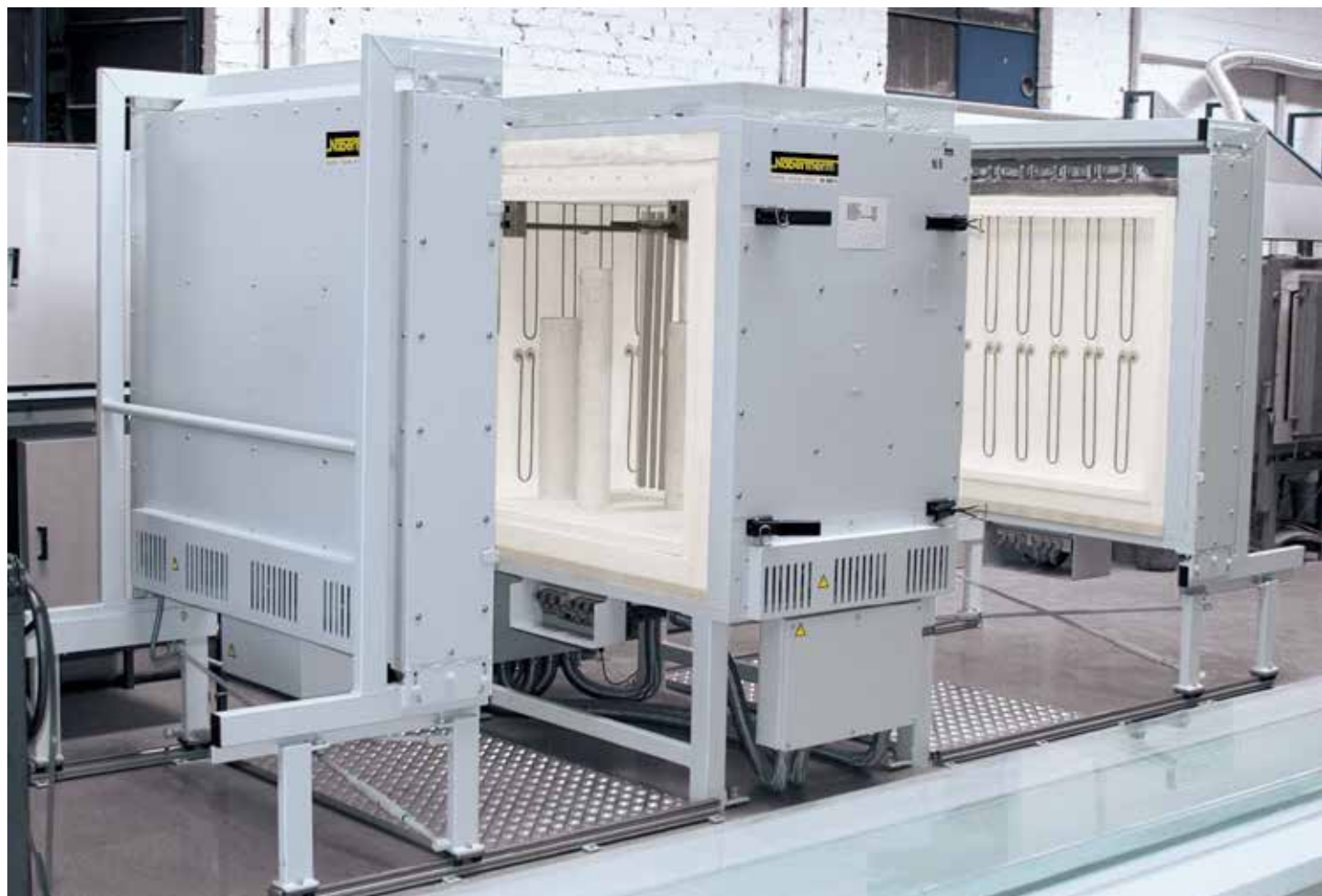
HT 1000/17 带有两个可移动门和四侧加热装置，可用于对悬挂的陶瓷管进行烧结，最高温度可达 1700 °C
