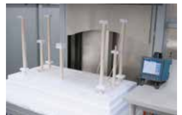
用于确定高温升降底盖炉温度分配的测量装置
