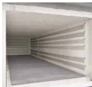
适于短时工艺的蜿蜒形加热元件
