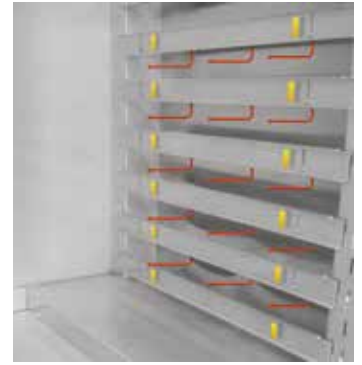
进气百叶窗板可调，用于调整吹向物料的空气的导向
