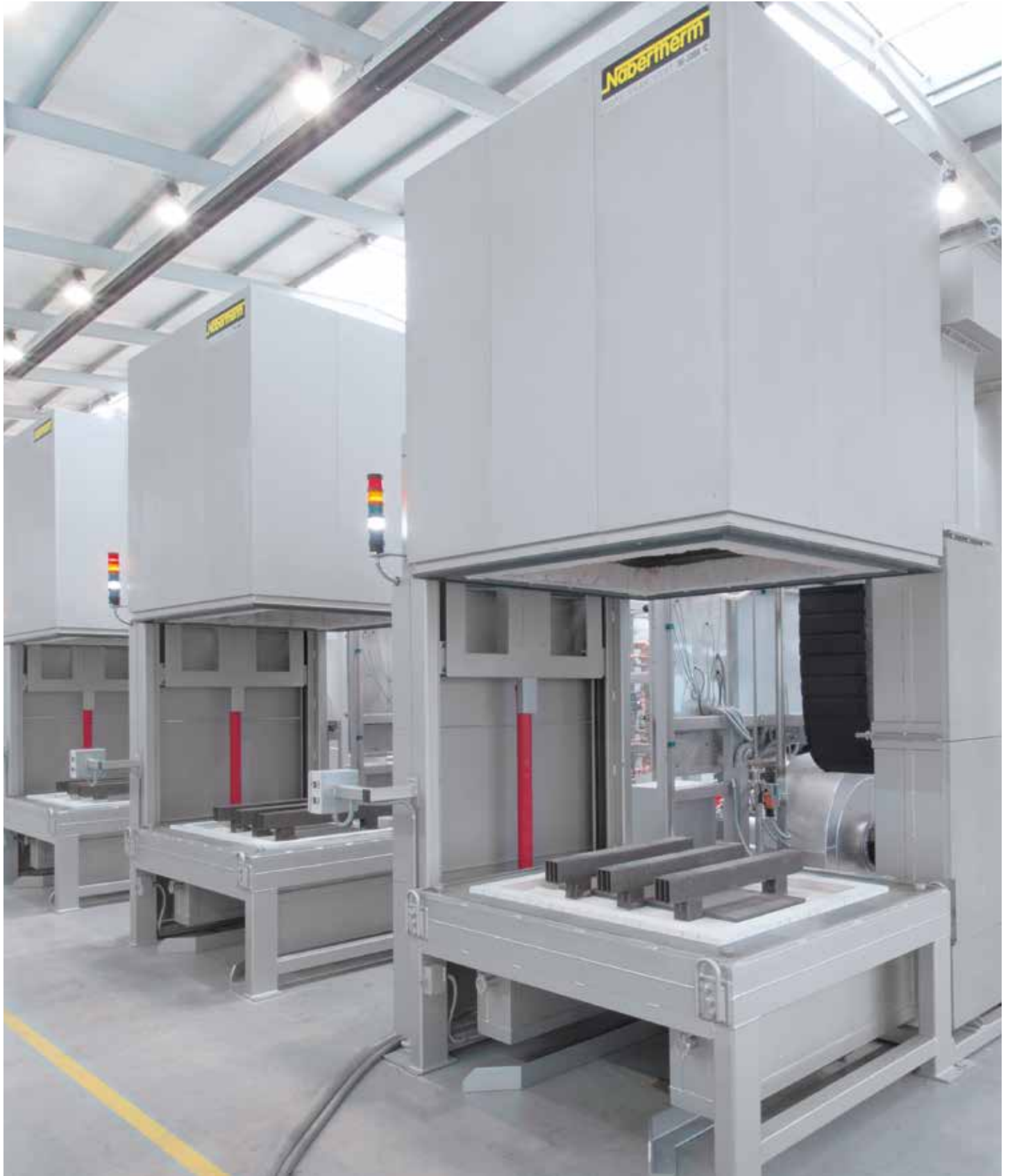
生产设备，由 3 台带炉壳密封的 HAS 1560/95S 型罩式炉组成，用于在氮气下运行。包含用于缩短冷却时间的空气 / 气体热交换器
