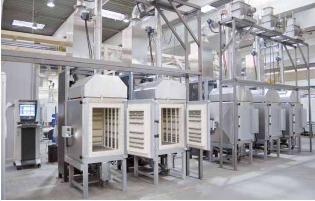
生产设备，由 5 个 N 300/H DB200 型组合箱式炉连同催化后燃烧装置组成
