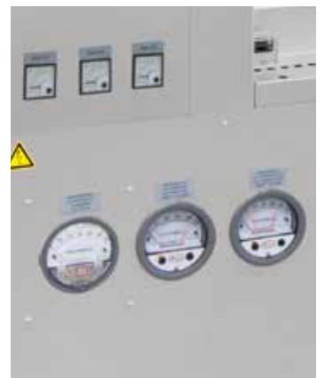
在排胶工序包 DB200 中显示压力和流量
