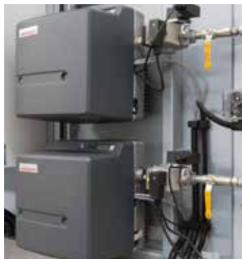
电炉加热装置和热力式后燃烧器的气体燃烧器
