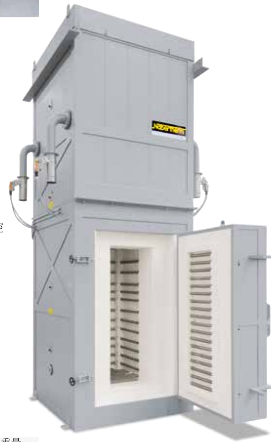
井式炉 S 1775/13 S，从上部装料，带额外的检修门
