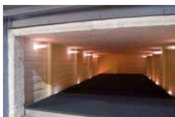
带有八个高速燃烧器的炉腔
