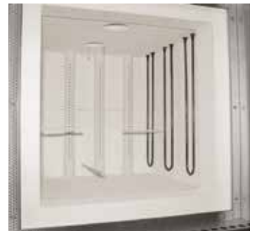
在排胶工序包 DB200 中，通过开孔的进气管导入新鲜空气
