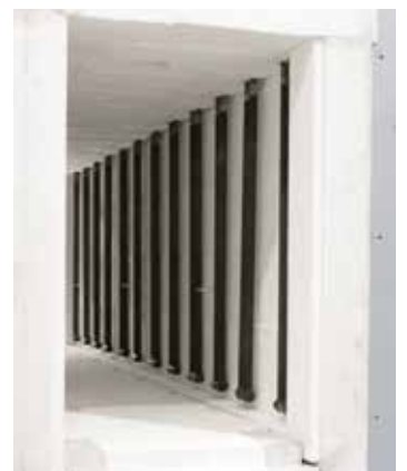
电炉纵向两侧的 SiC 加热元件
