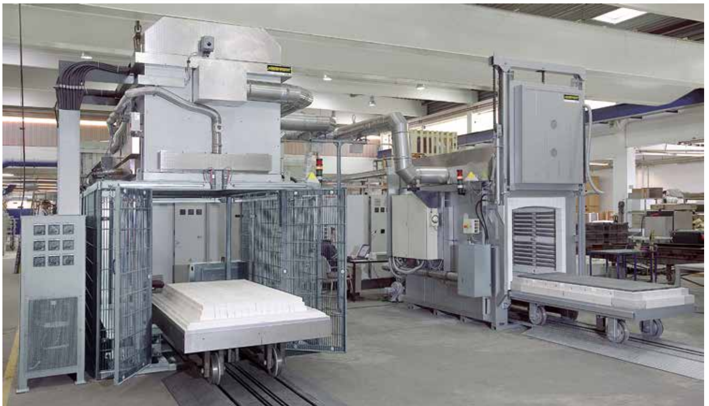
生产设备，由用于排胶的台车炉和用于结合催化再燃烧设备进行剩余排胶和烧结的高温炉组成
