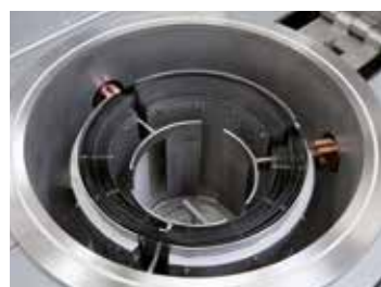
带钨丝加热装置的圆柱形气密罐
