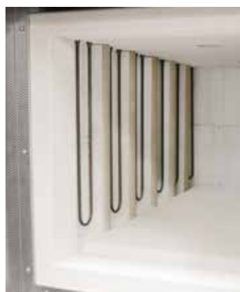
用于防止加热元件机械损坏的防护装置
