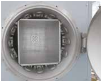
NRA ../06 炉型设有内置加热元件
