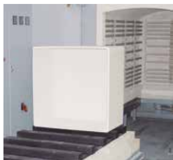
W 3300 台车炉，用于对太阳能工业中的熔炼坩埚上釉
