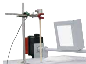
作为附加装备的排气门和带支架的炉料热电偶
