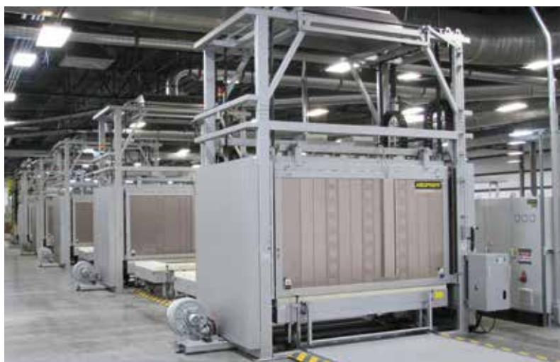
H 3630/LT DB200 型顶部升降炉用于在生产中进行排胶和烧结
