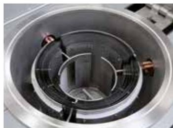
Storta cilindrica con riscaldamento al tungsteno
