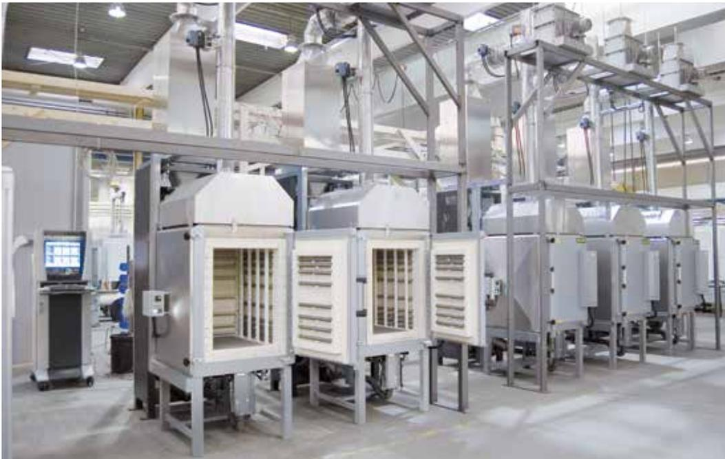
Impianto di produzione formato da cinque forni a camera combinati N 300/H DB200 con dispositivo di post-combustione catalitica
