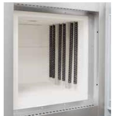
Barre in SiC montate verticalmente e tubi perforati opzionali per ingresso aria del sistema di deceraggio
