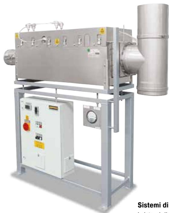
Per la depurazione dell'aria di scarico, in particolare per il deceraggio, Nabertherm offre sistemi di depurazione realizzati su misura. Il dispositivo di post-combustione viene fissato saldamente ai bocchettoni di scarico gas del forno e collegato al sistema di regolazione e alla matrice di sicurezza del forno. Per gli impianti di forno già esistenti possiamo offrire anche sistemi di depurazione dei gas indipendenti, che possono essere regolati e gestiti separatamente.
