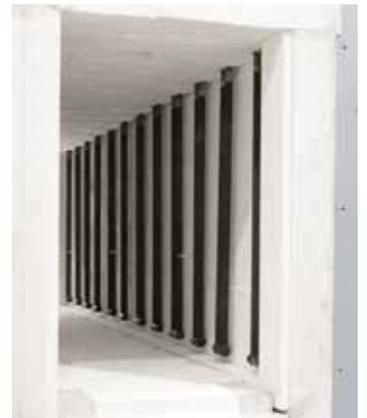
Resistenze riscaldanti SiC su entrambi i lati longitudinali del forno
