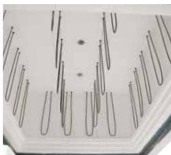
Riscaldamento da tutti i lati e tra le pile per l'ottimizzazione dell'uniformità della temperatura
