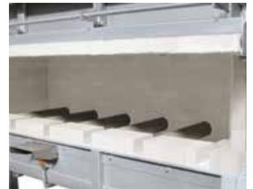
Riscaldamento indiretto a gas con tubi radianti
