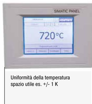
La precisione del sistema si ottiene sommando le tolleranze del controller, della termocoppia e dello spazio utile
