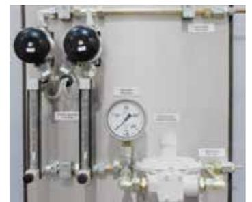
Sistema di gasaggio per gas inerti o di reazione non infiammabili
