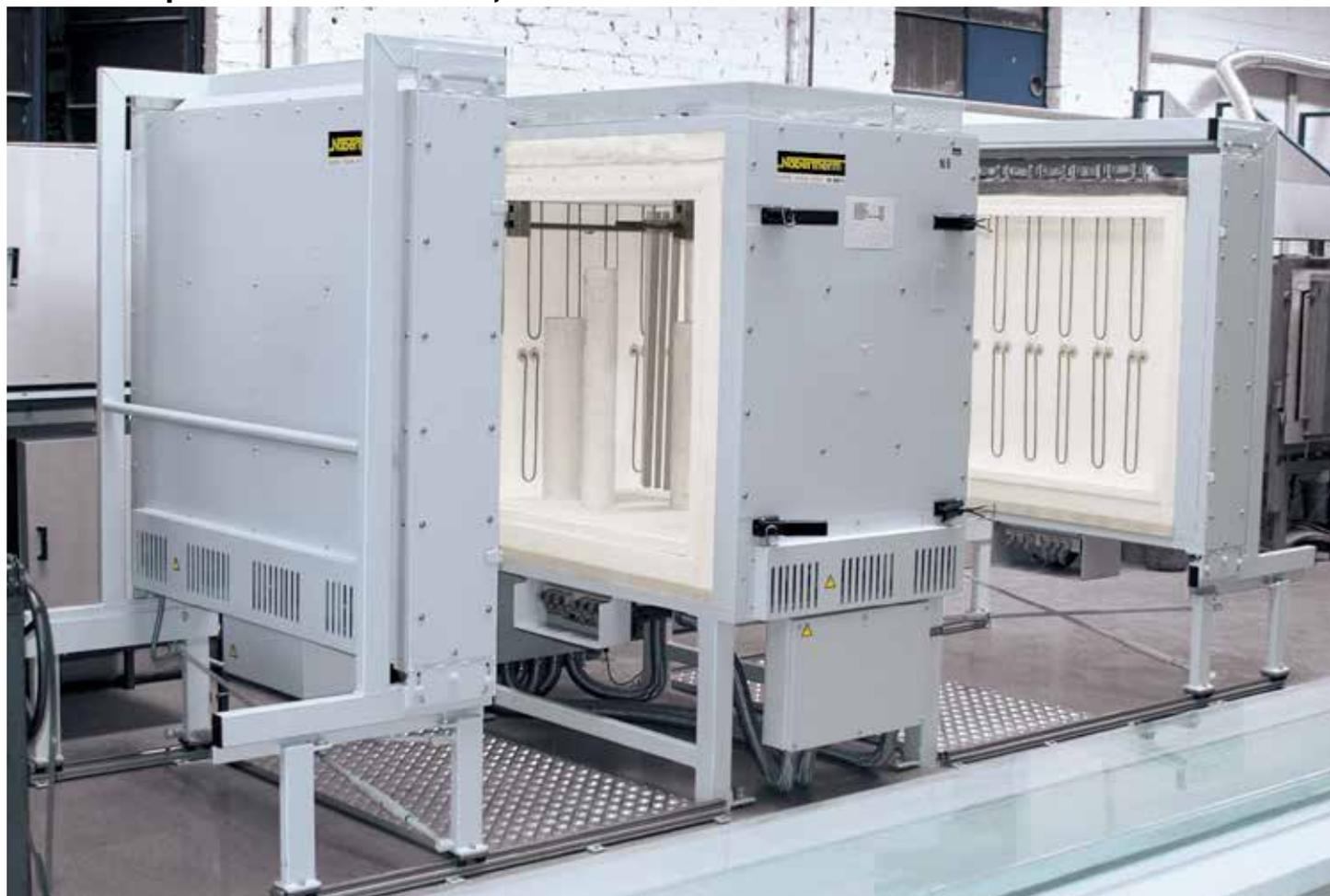
HT 1000/17 con due porte scorrevoli e riscaldamento perimetrale per il sinteraggio di tubi in ceramica sospesi fino a 1700 °C
