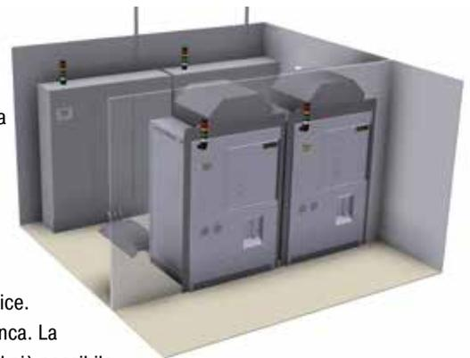
Forni ad alta temperatura con caricamento dalla camera bianca; impianto di distribuzione e forno installati in camera grigia
