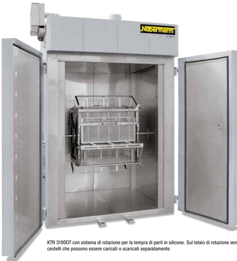
KTR 3100DT con sistema di rotazione per la tempra di parti in silicone. Sul telaio di rotazione vengono collocati 4 cestelli che possono essere caricati o scaricati separatamente
