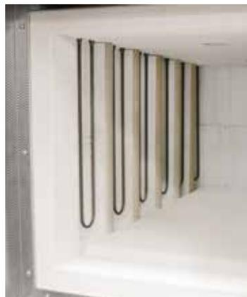
Dispositivo di protezione da danni meccanici per gli elementi riscaldanti
