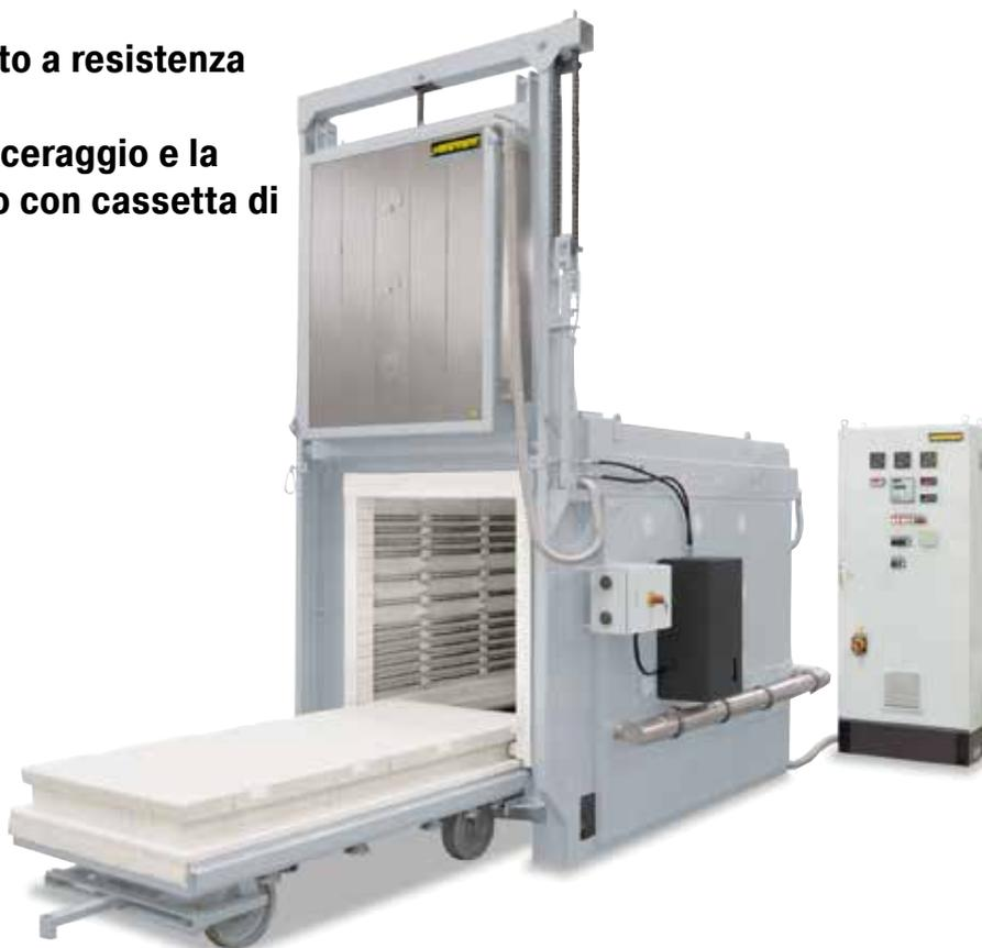
Forno a suola mobile W 2060/S senza riscaldamento del carrello per il preriscaldamento di stampi per fusione
