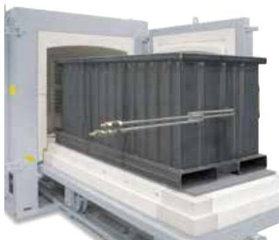
Forno a suola mobile in esecuzione IDB con cassetta di gasaggio per il deceraggio e la sinterizzazione in gas inerti e di reazione non infiammabili
