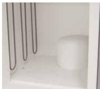
Calotta di processo con fornitura gas attraverso il fondo del forno per la protezione del vano forno da impurità e per prevenire un'interazione chimica tra carica ed elementi riscaldanti
