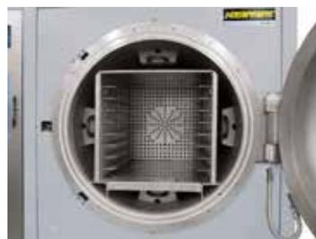
Storta con riscaldamento interno e contenitore di processo
