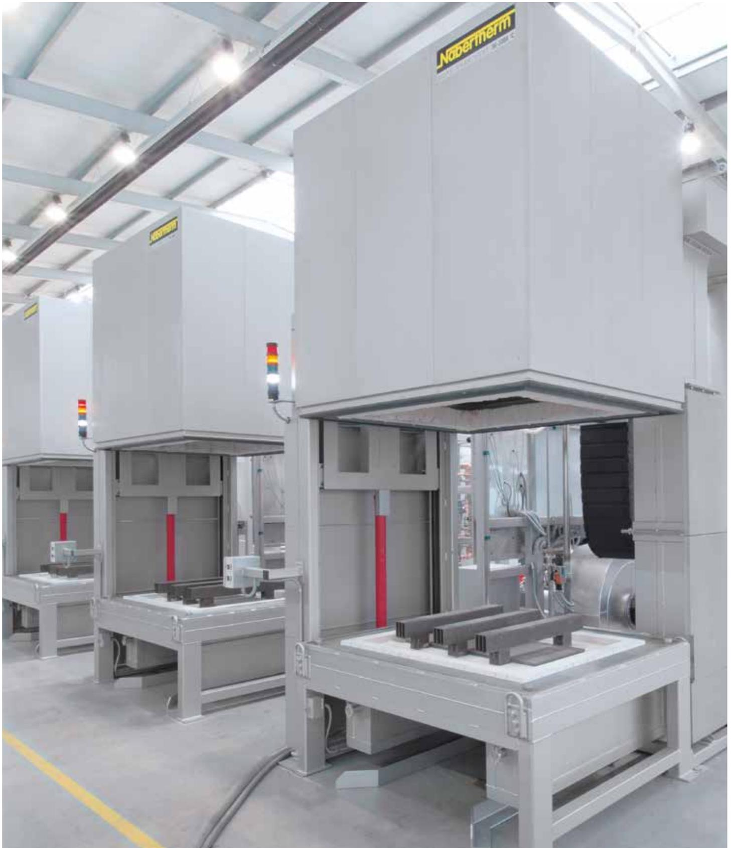
Impianto di produzione composto da 3 forni a campana HAS 1560/95S con struttura a tenuta, per il funzionamento in azoto e scambiatore di calore aria/gas per abbreviare i tempi di raffreddamento
