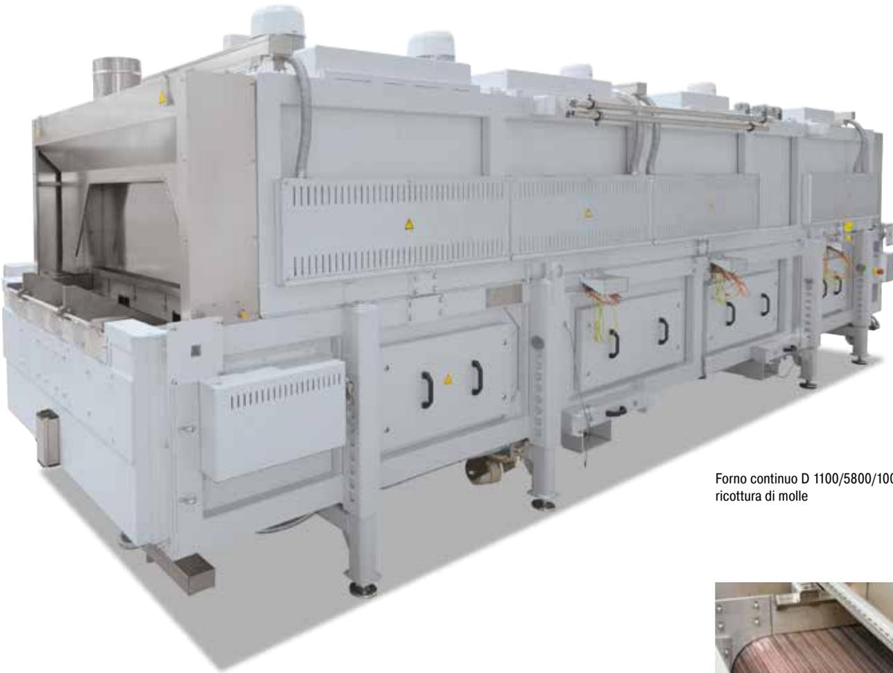
Forno continuo D 1100/5800/100/50 AS per la ricottura di molle
