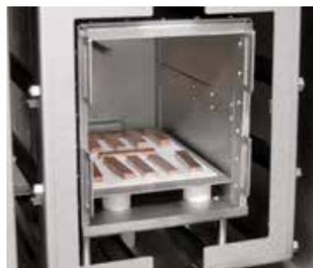
Trattamento termico di barrette di rame con idrogeno in VHT 8/16-MO
