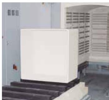
Forno a suola mobile W 3300 per la vetrinatura di crogioli di fusione per l'industria solare
