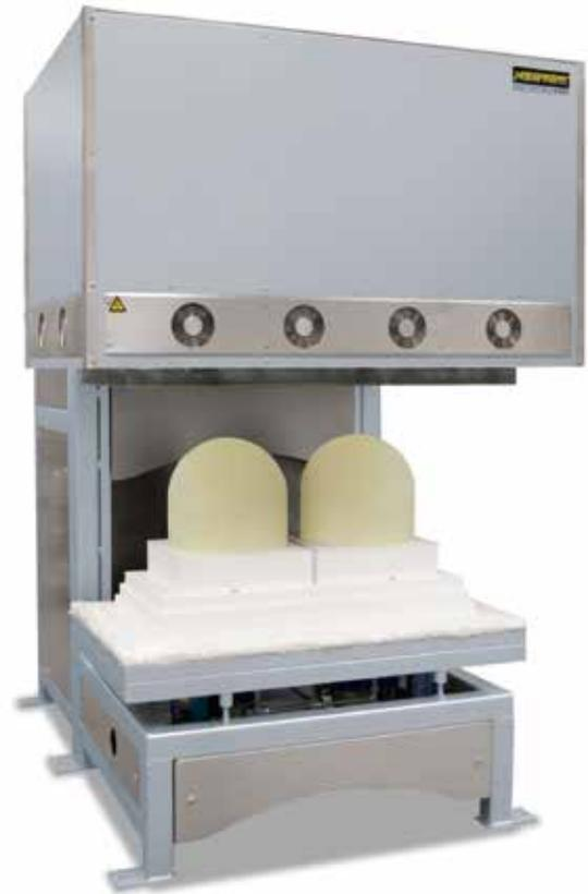
HT 276/18 LTS con due calotte di processo per la sinterizzazione in gas inerti o di reazione non infiammabili
