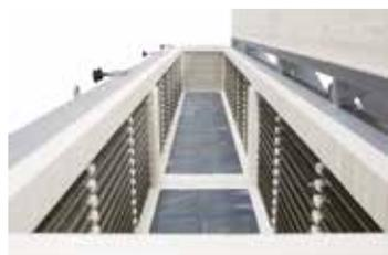
Camera del forno S 5120/GS con supporto che accoglie la piastra isolante per dividere a metà la camera del forno
