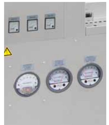
Visualizzazione di pressione e portata con il sistema di deceraggio DB200
