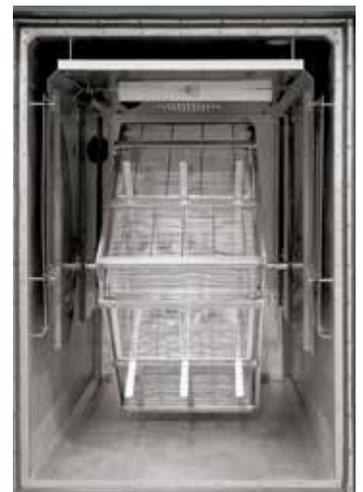
Telaio rotante a motore con cestelli integrati per la movimentazione della carica durante il trattamento termico
