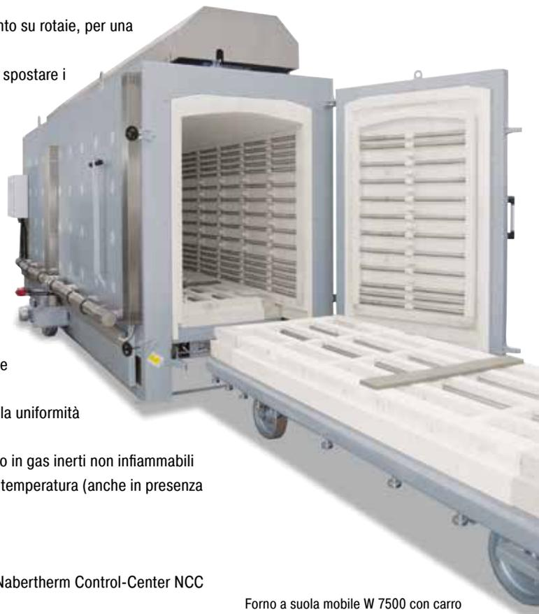
Forno a suola mobile W 7500 con carro separato in tre parti
