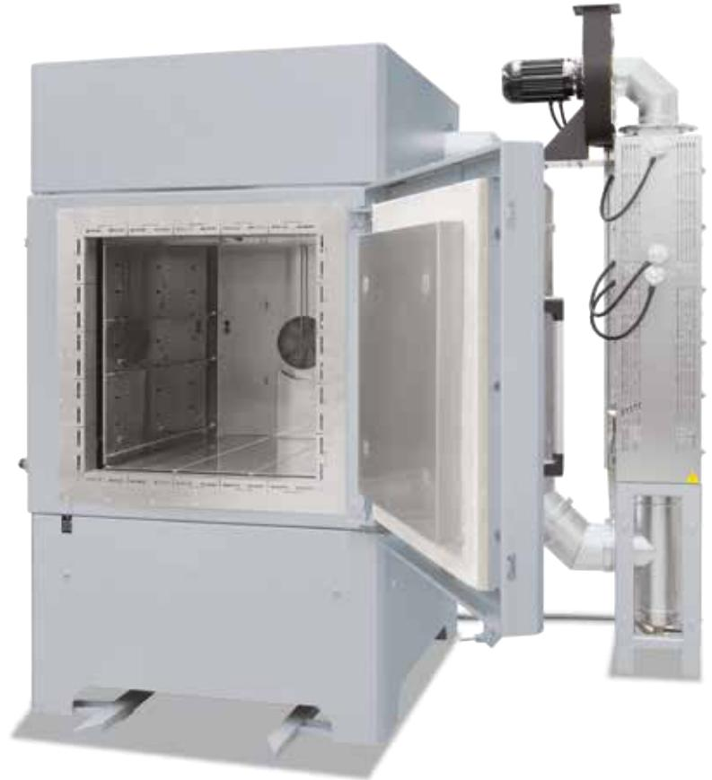
Forno a camera a convezione N 250/65 HA IDB con cassetta di gasaggio per deceraggio in gas protettivi
