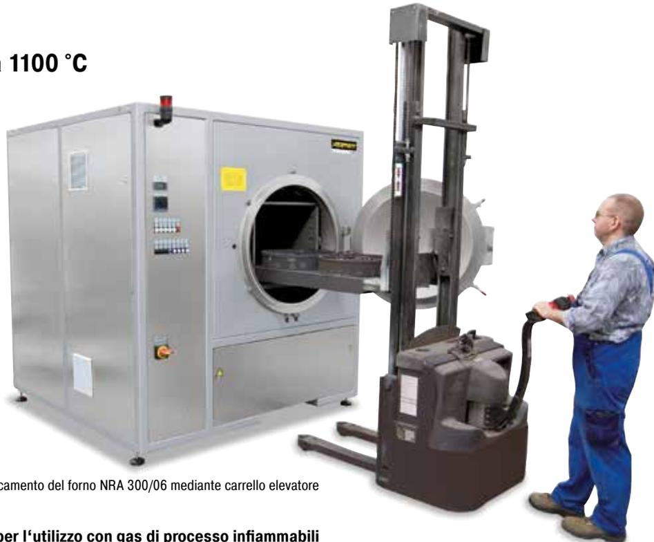
Caricamento del forno NRA 300/06 mediante carrello elevatore
