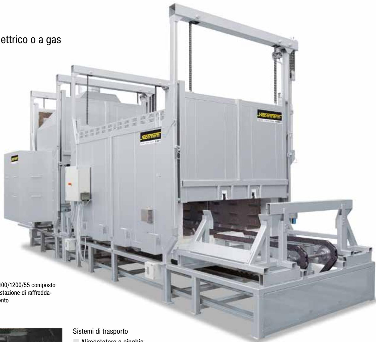
Impianto di carico D 1600/3100/1200/55 composto da forno di solubilizzazione, stazione di raffreddamento e sistema di caricamento
