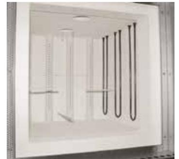
Immissione di aria fresca mediante apposito tubo perforato con il sistema di deceraggio DB200
