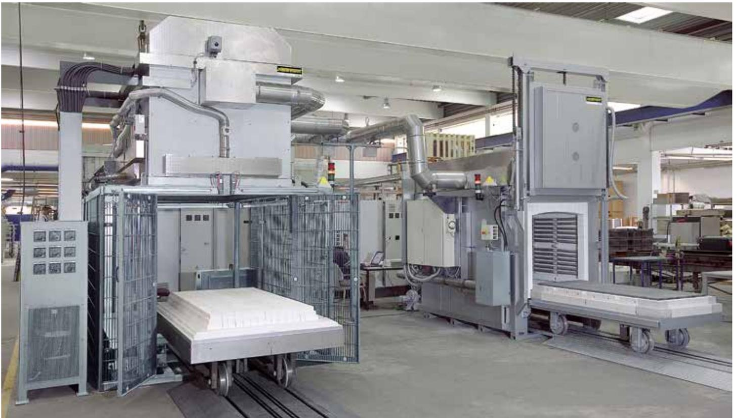
Impianto di produzione formato da forno a suola mobile per il deceraggio e forno ad alta temperatura per il deceraggio dei residui e la sinterizzazione, con impianto comune di post-combustione catalitica
