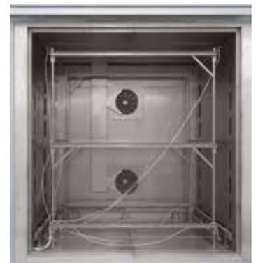
Telaio da assemblare per la misurazione nel forno a circolazione d'aria N 7920/45 HAS
