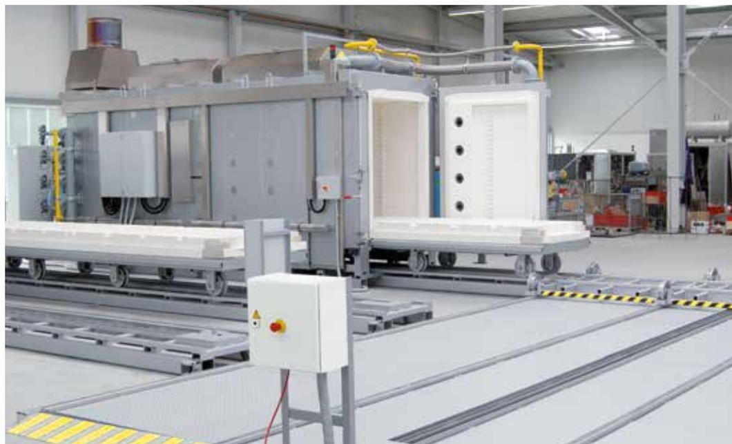
Impianto di forno multiuso composto da due forni a suola mobile WB 11000/HS riscaldati a gas, sistema di smistamento dei carrelli e due carrelli aggiuntivi con i necessari binari di deposito
