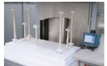
Struttura di misurazione per il rilevamento della uniformità della temperatura in un forno lift-bottom ad alta temperatura
