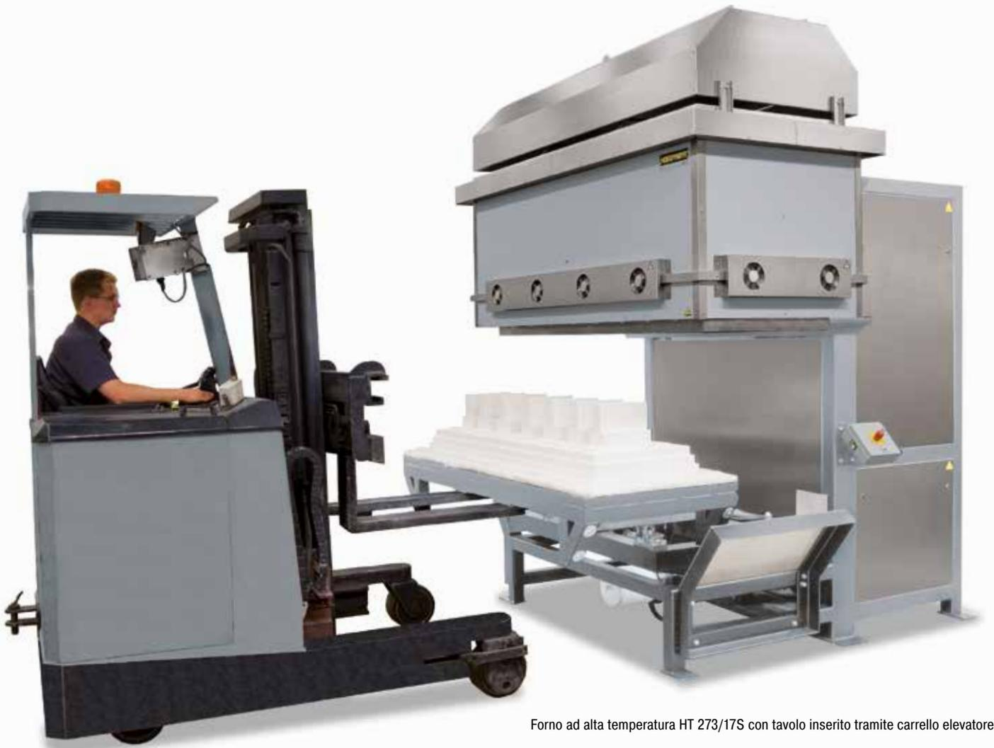
Forno ad alta temperatura HT 273/17S con tavolo inserito tramite carrello elevatore a forca
