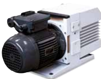
Двухступенчатый пластинчатый насос для термической обработки в вакууме до 10 -2 мбар
