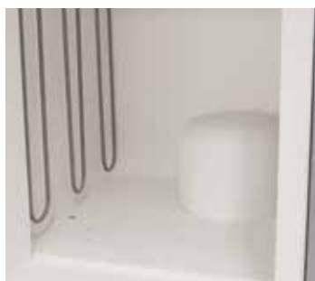
Технологический кожух с подачей газа через под печи защищает пространство печи от загрязнений, а также предотвращает химическое взаимодействие между изделиями и нагревательными элементами
