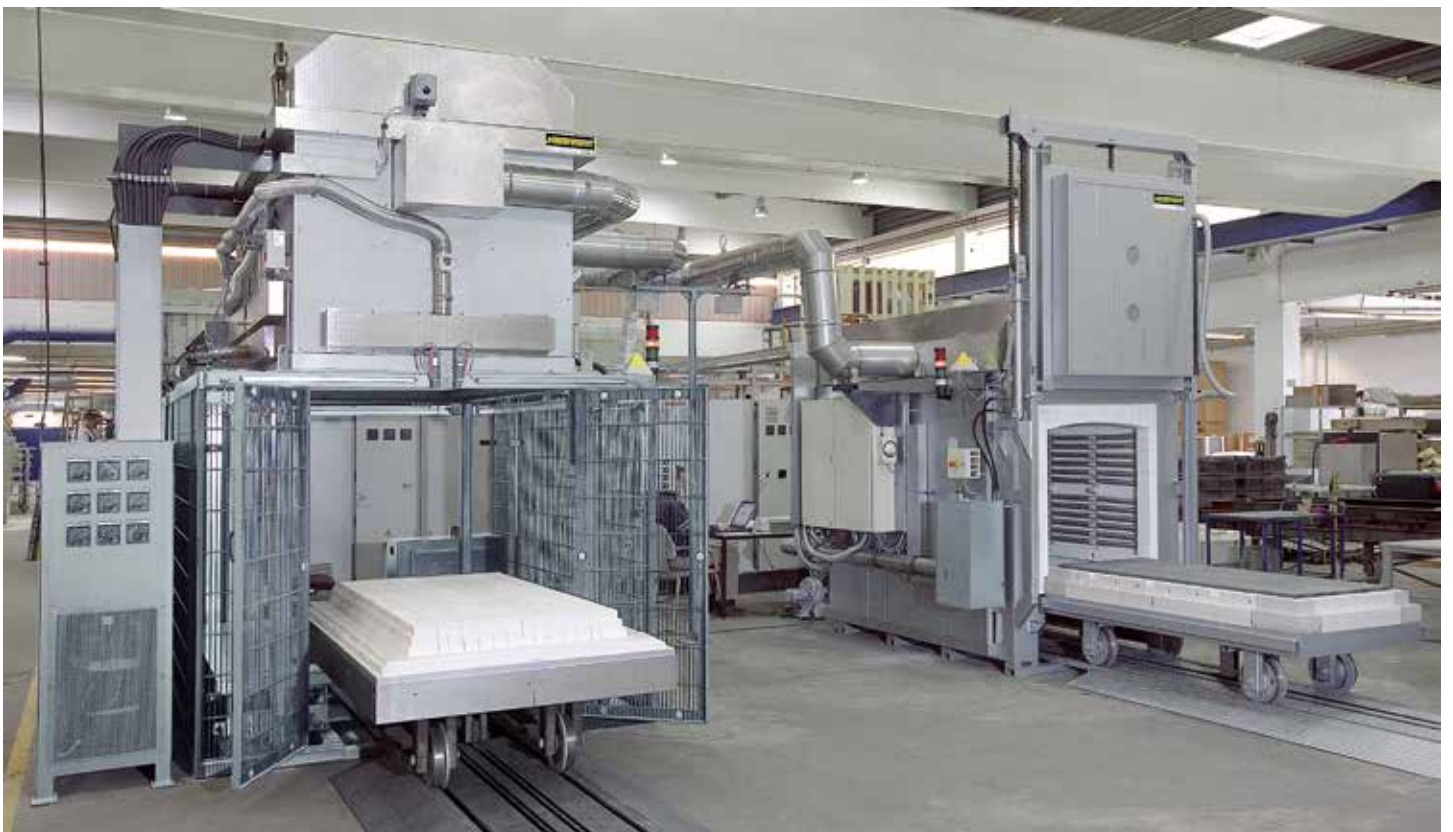
Производственная установка, состоящая из печи с выдвигаемым подом для выжигания и высокотемпературной печи для дополнительного выжигания и спекания и с общей установкой каталитического дожигания
