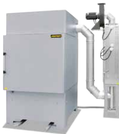
Камерная печь с циркуляцией воздуха NA 500/65 DB200 с установкой для каталитического дожигания
