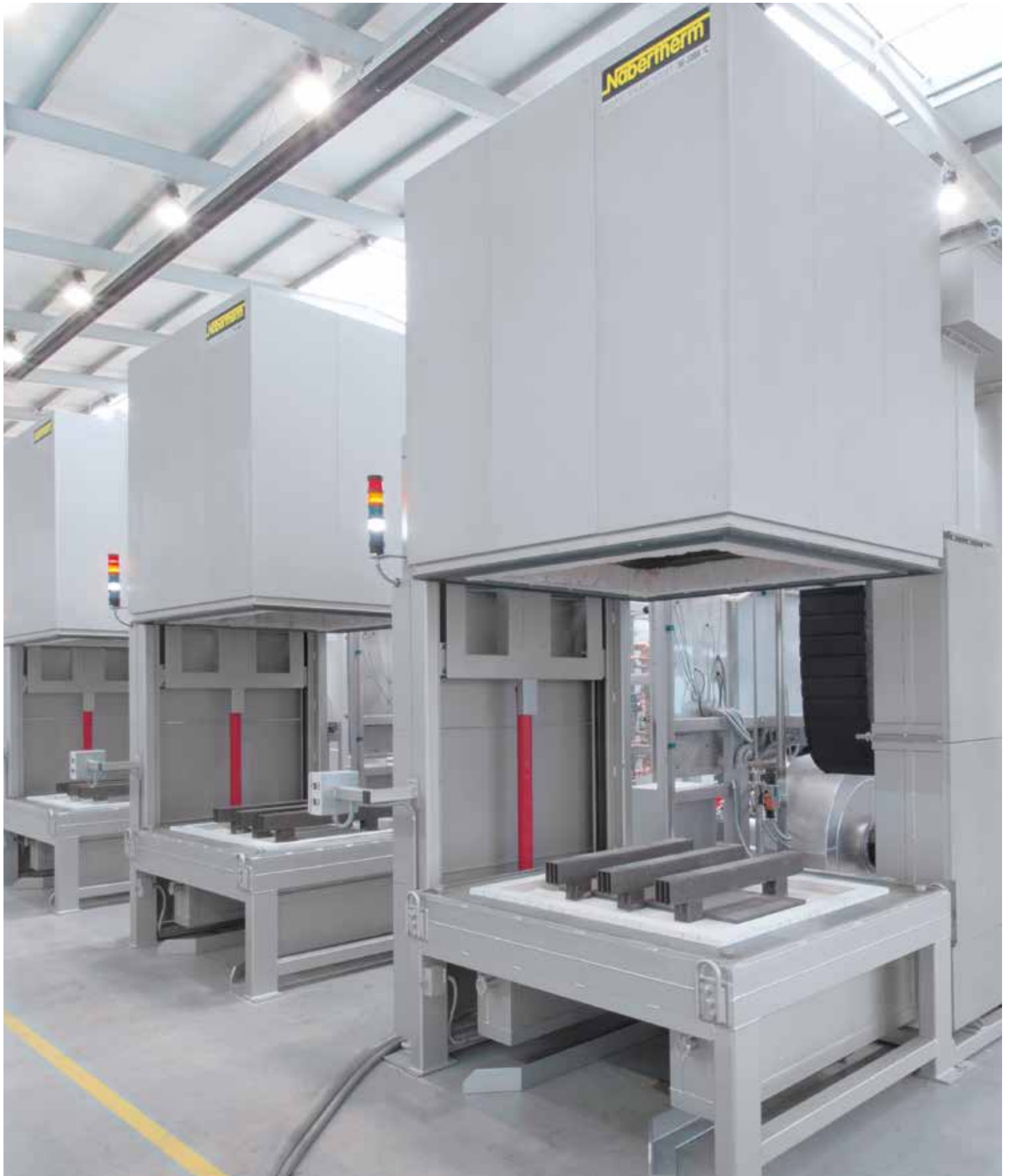
Производственная установка, состоящая из трех колпаковых печей HAS 1560/95S с герметизированным корпусом для использования с азотом. Прилагается газоздушный теплообменник, позволяющий сократить время охлаждения
