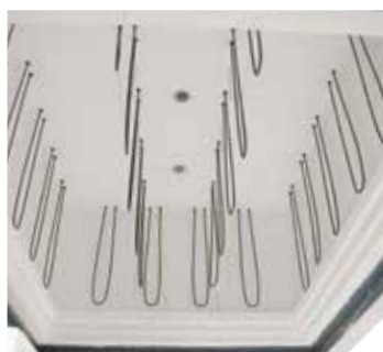
Обогрев со всех сторон и между штабелем для оптимизации температурной равномерности
