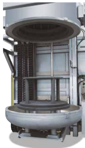
LBVHT с графитовым нагревательным элементом
