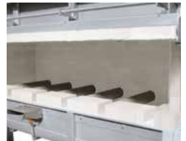
Непрямой газовый обогрев с помощью труб радиационного нагрева
