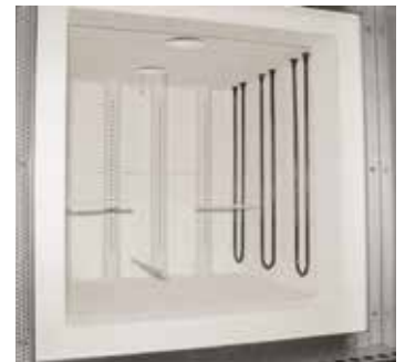
Впуск свежего воздуха через перфорированные нагнетательные трубки, входящие в комплектацию для выжигания DB200
