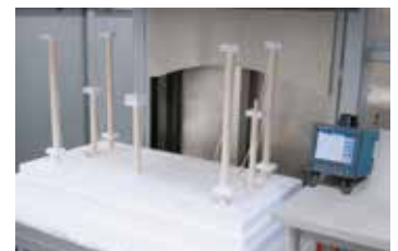
Измерительная установка для установления распределения температур в высокотемпературной печи с элеваторным механизмом для нижней крышки
