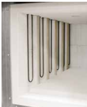
Защитная установка для нагревательных элементов для защиты от механического повреждения
