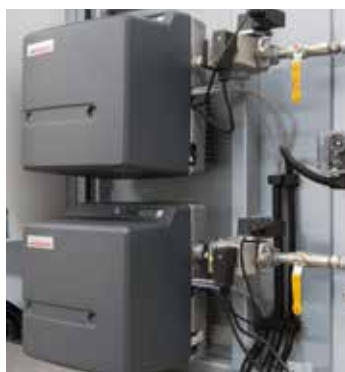
Газовая горелка для отопления печи и термического дожигания
