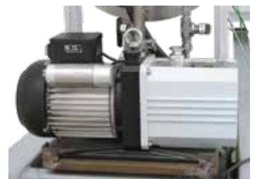
Вакуумный насос для холодного вакуумирования реторты
