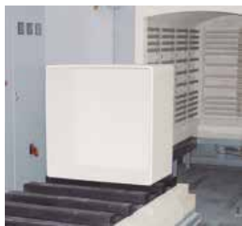
Печь с выдвижным подом W 3300 для глазирования плавильных тиглей в соляризации
