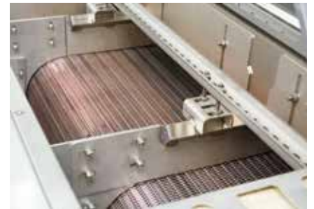
Привод с проволочным ленточным транспортером в проходной печи D 1100/3600/100/50 AS
