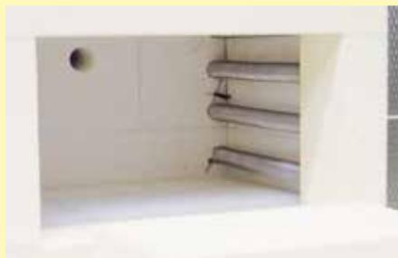
Interior del horno con aislamiento de ladrillos refractarios de alta calidad
