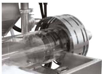
Brida con suplemento de protección contra la radiación térmica (sistema de alimentación de gas 15)
