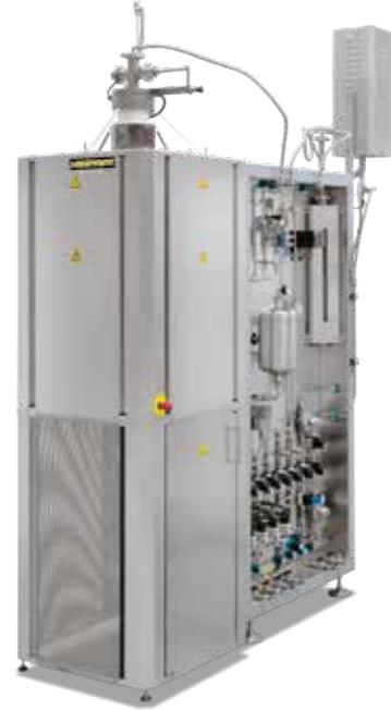
RHTV 120/600/17 H<sub>2</sub> con paquete de gasificación 4 para gases inflamables, gancho oscilante para colgar la carga y puerta de seguridad ante la brida inferior
