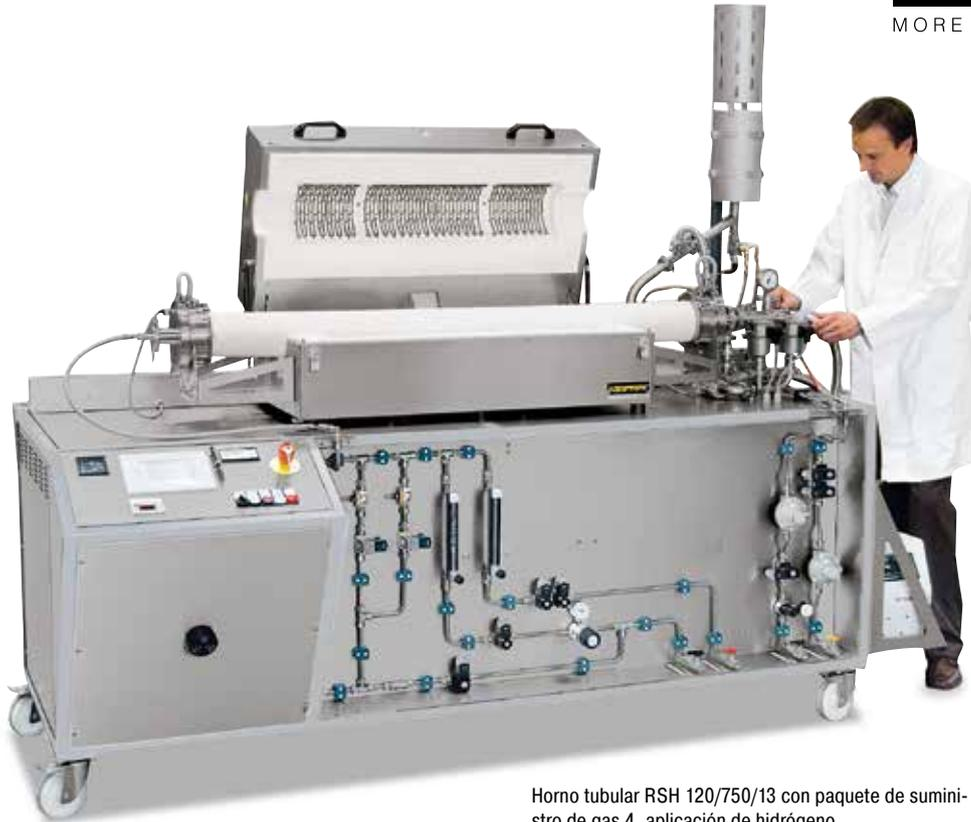
Horno tubular RSH 120/750/13 con paquete de suministro de gas 4, aplicación de hidrógeno
