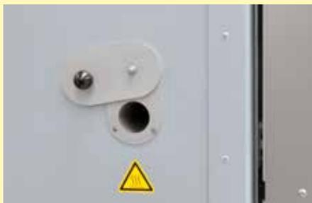
Orificio para termopar
