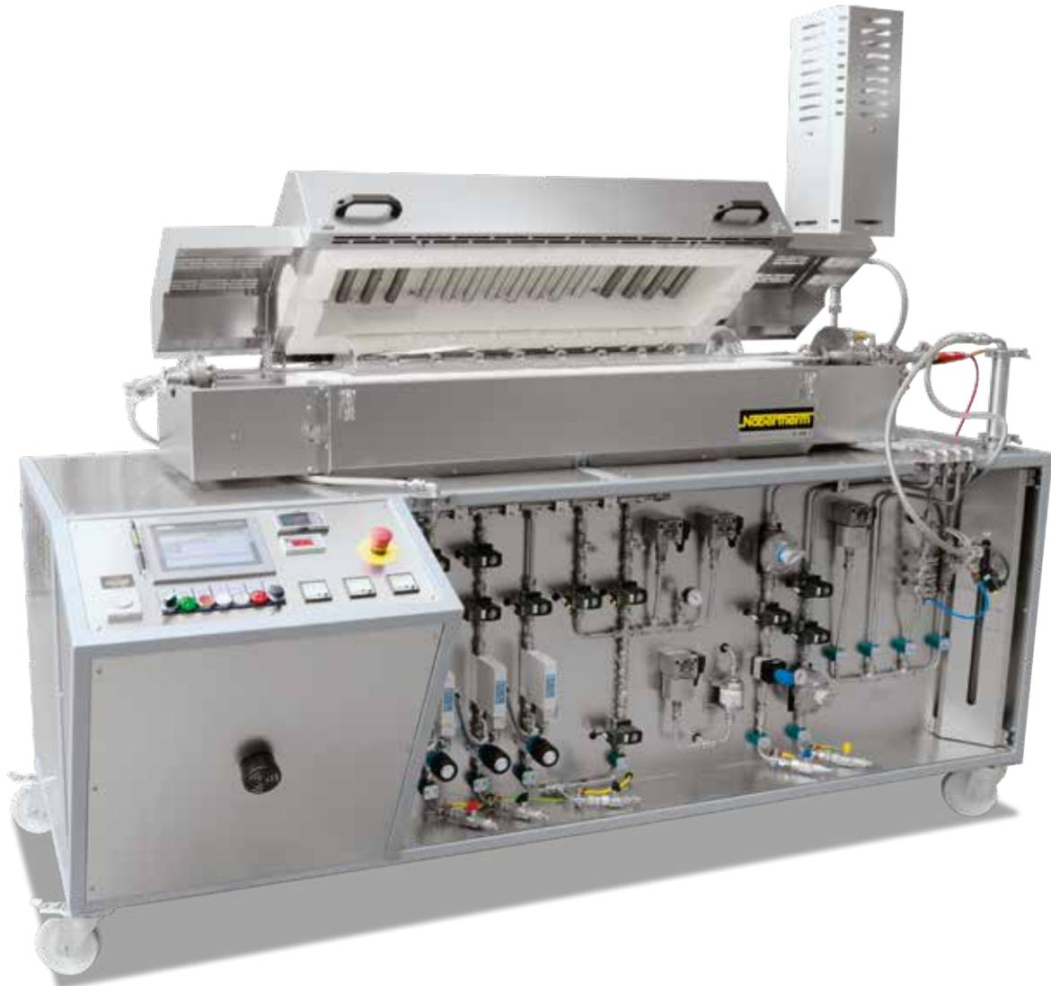
RSRB 170/1000/11 H<sub>2</sub> con paquete de gasificación 4 para aplicación de hidrógeno
