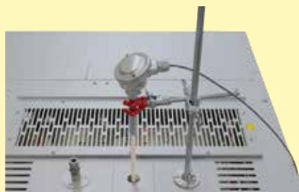
Orificio para termopiar en el techo con soporte
