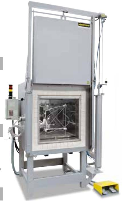
Estructura de medición para determinar la homogeneidad de la temperatura
