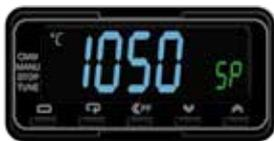
Ejemplo de un limitador de sobre-temperatura
