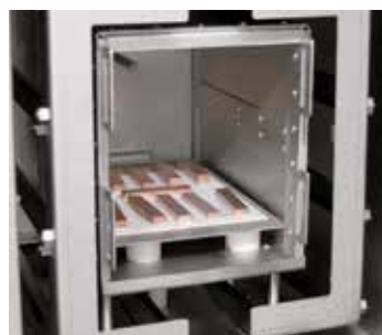
在氢气环境下，在 VHT 8/16-MO 型气密罐式炉内对铜棒进行热处理
