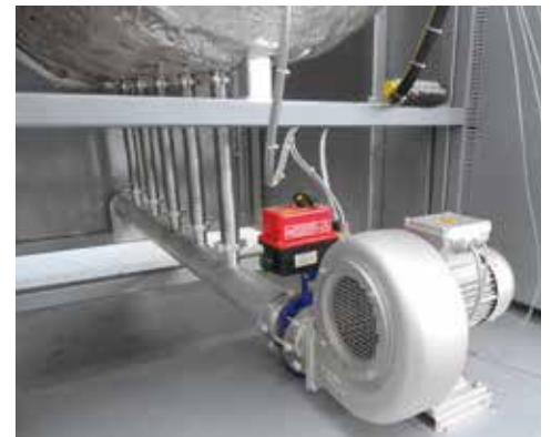
NRA 400/03型热壁罐式炉的鼓风机冷却
