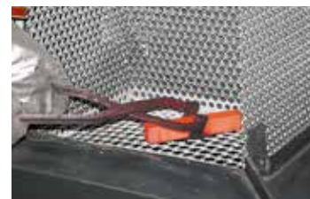
保温池淬火的实际应用
