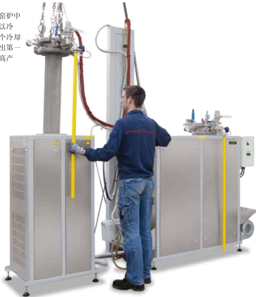
SR 170/1000/11 型罐式炉，带可更换的气密罐和冷却系统
