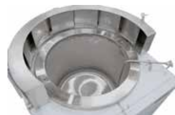
TS 90/80带有盐浴热电偶的型用于钢的热处理
