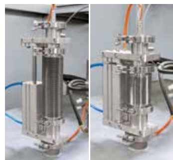
S 型热电偶，带有自动取出装置，确保了在较低温度范围内非常好的控温效果
