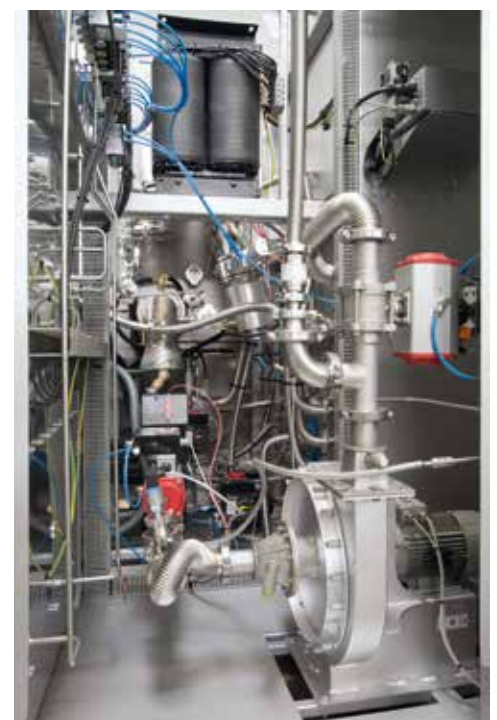
VHT 8/16-MO型冷壁罐式炉的气体快速冷却
