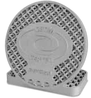
被打印的铝制部件，在N 250/85 HA型窑炉中经过热处理（在SUPCHAD平台上的制造商CETIM CERTEC）
