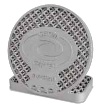
被打印的铝制部件，在N 250/85 HA型窑炉中经过热处理（在SUPCHAD平台上的制造商CETIM CERTEC）
