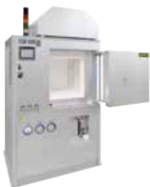
HT 160/17 DB200 型用于排胶以及在 3D 打印后烧结陶瓷
