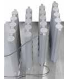
Tiges de traction en titane après le traitement thermique au four NR 50/11 sous atmosphère à l'argon
