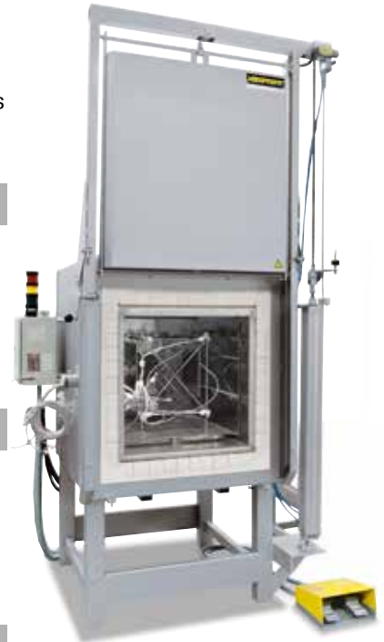
Messgestell zur Ermittlung der Temperaturgleichmäßigkeit
