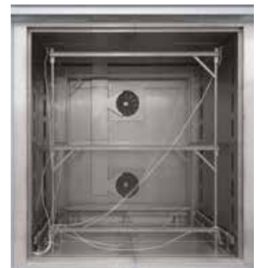
Steckbares Messgestell für Umluft-Kammerofen N 7920/45 HAS
