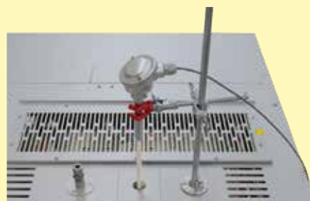
Thermoelement-Durchführung in der Decke mit Stativ
