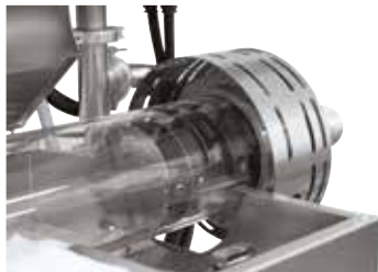
Flansch mit Strahlenschutzinsatz (Begasungspaket 15)
