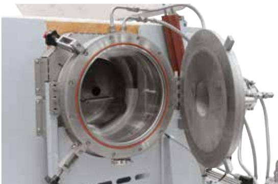
Flansch mit Scharnier
