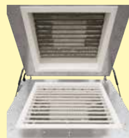
Beheizung von Boden und Deckel, getrennt regelbar
