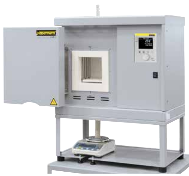
Hochtemperaturofen LHT 04/16 SW mit Waage zur Glühverlustbestimmung
