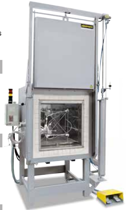
Messgestell zur Ermittlung der Temperaturgleichmäßigkeit
