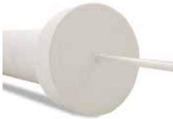
Faserstopfen mit Schutzgasanschluss, geeignet für viele Laboranwendungen (Begasungspaket 1)
