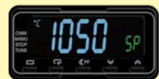
Beispiel eines Temperaturwählbegrenzers
