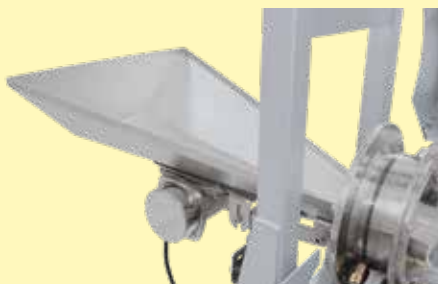
Vibrationsrinne am Drehrohr zur einfachen Materialzuführung
