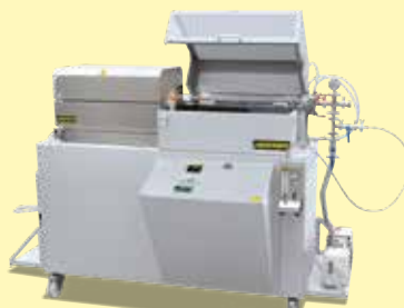
RSH 120/500/13S mit verschiebbarem Ofen
