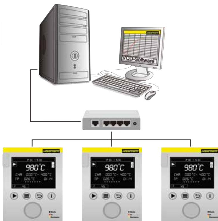
Esempio di configurazione con 3 forni
