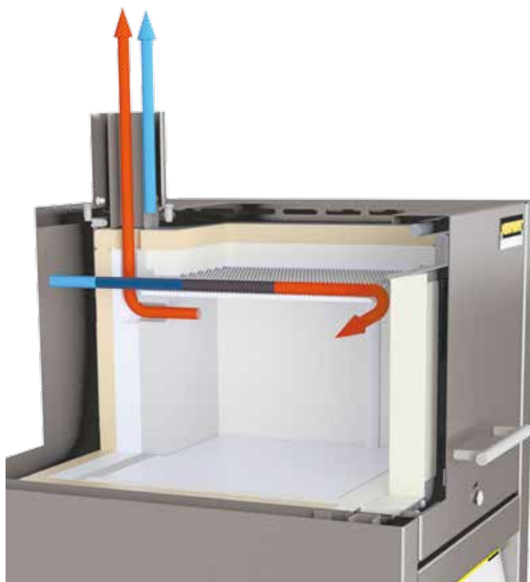
Principio di alimentazione e scarico dell'aria per forni per incenerimento
