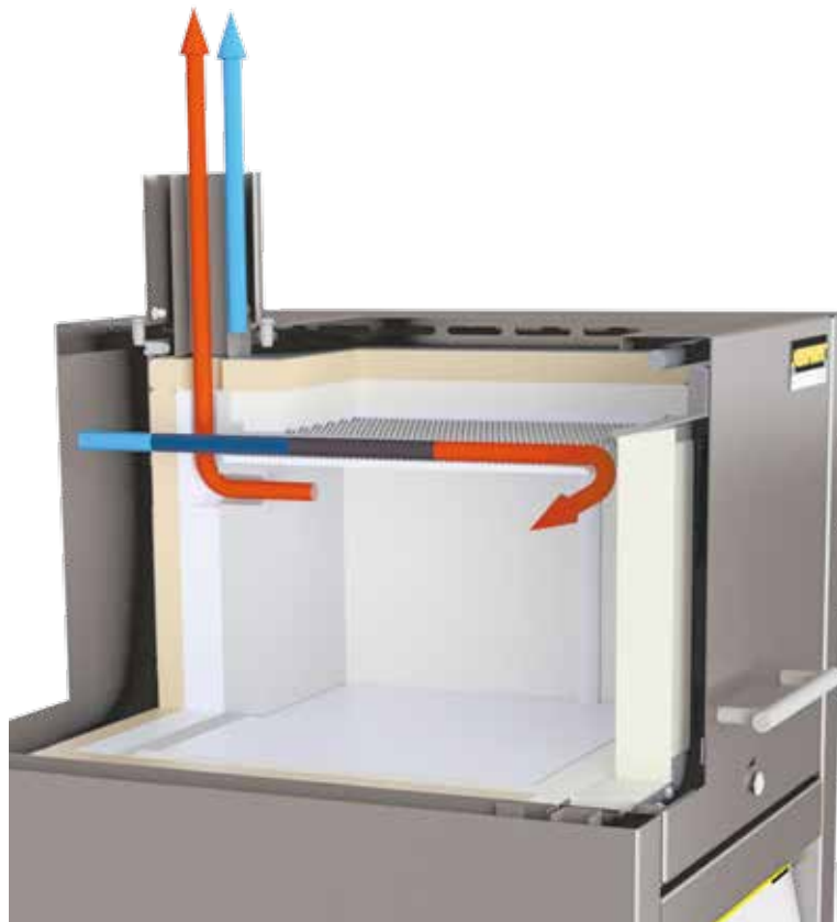
Esquema de aire de escape o aire adicional en hornos de incineración
