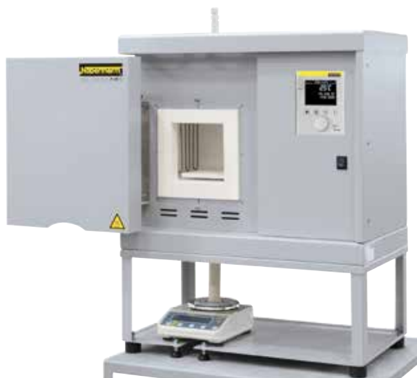
Horno de alta temperatura LHT 04/16 SW con báscula para la determinación de la pérdida por recocido
