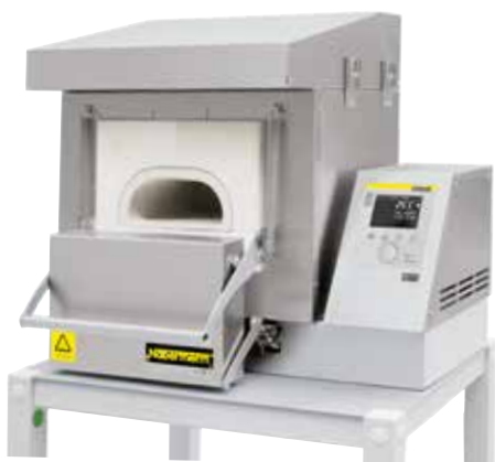
Horno de copelación N 4/13 CUP como modelo de sobremesa
