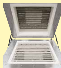
Calentamiento de la solera y la tapa, regulable de manera independiente
