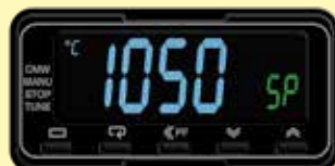
Ejemplo de un limitador de sobre-temperatura
