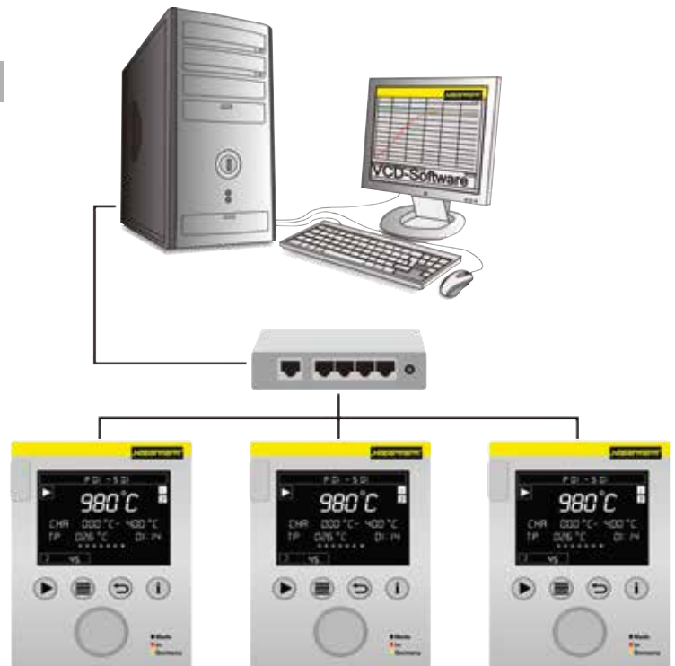
Ejemplo de instalación con 3 hornos
