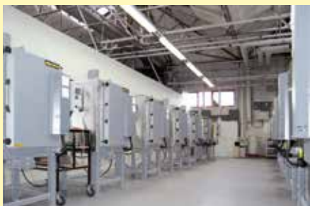
N 200/14 型箱式炉，用于烧结半导体
