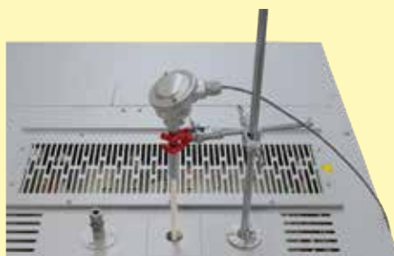
安装在顶盖内的热电偶套管，带支架
