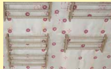
采用织物布料遮盖纤维隔热装置，以减少炉内的粉尘负载
