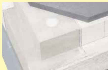
台车前侧边角位置的热电偶贯通管(Ø 40 mm)
