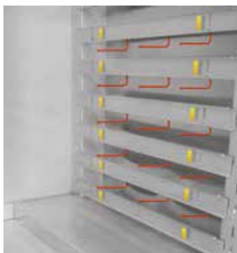
进气百叶窗板可调，用于调整吹向物料的空气的导向
