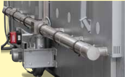
配备新风机的冷却系统
