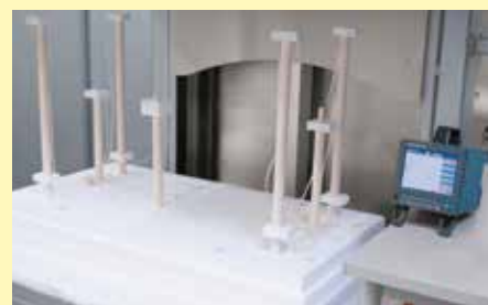
用于确定高温升降底座炉温度分配的测量装置
