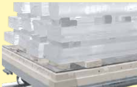
用于石英棒回火的台车炉
