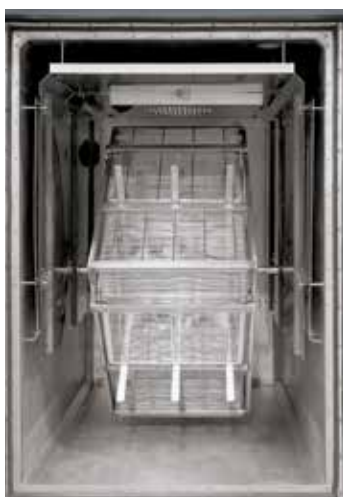
电机传动的旋转底架，带有内置篮筐，用于在热处理时移动装料
