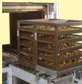
Horno continuo para material a granel en cestas
