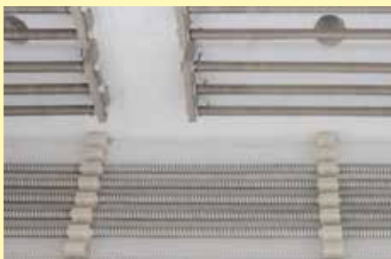
Aislamiento de fibra para reducir los tiempos de calentamiento y enfriamiento
