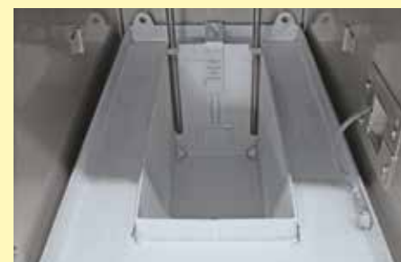
Crisol para baño salino de acero CrNi de alta calidad
