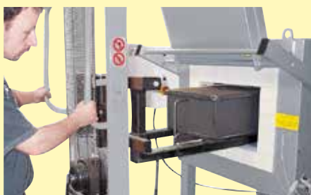
Trabajo con caja de inyección de gas para atmósferas de gas de protección con ayuda de un carro de carga
