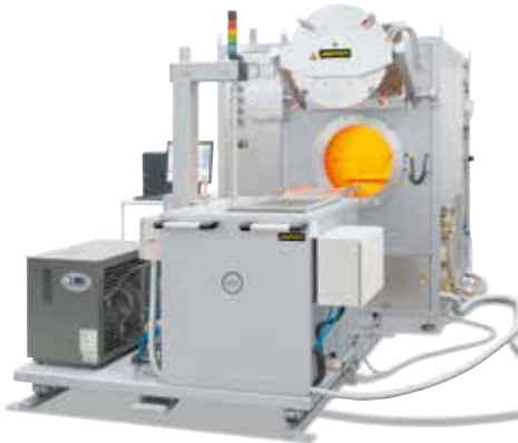
Equipo de revenido semiautomático con horno de retorta NR 50/11 y baño de enfriamiento por agua en un sistema de rieles
