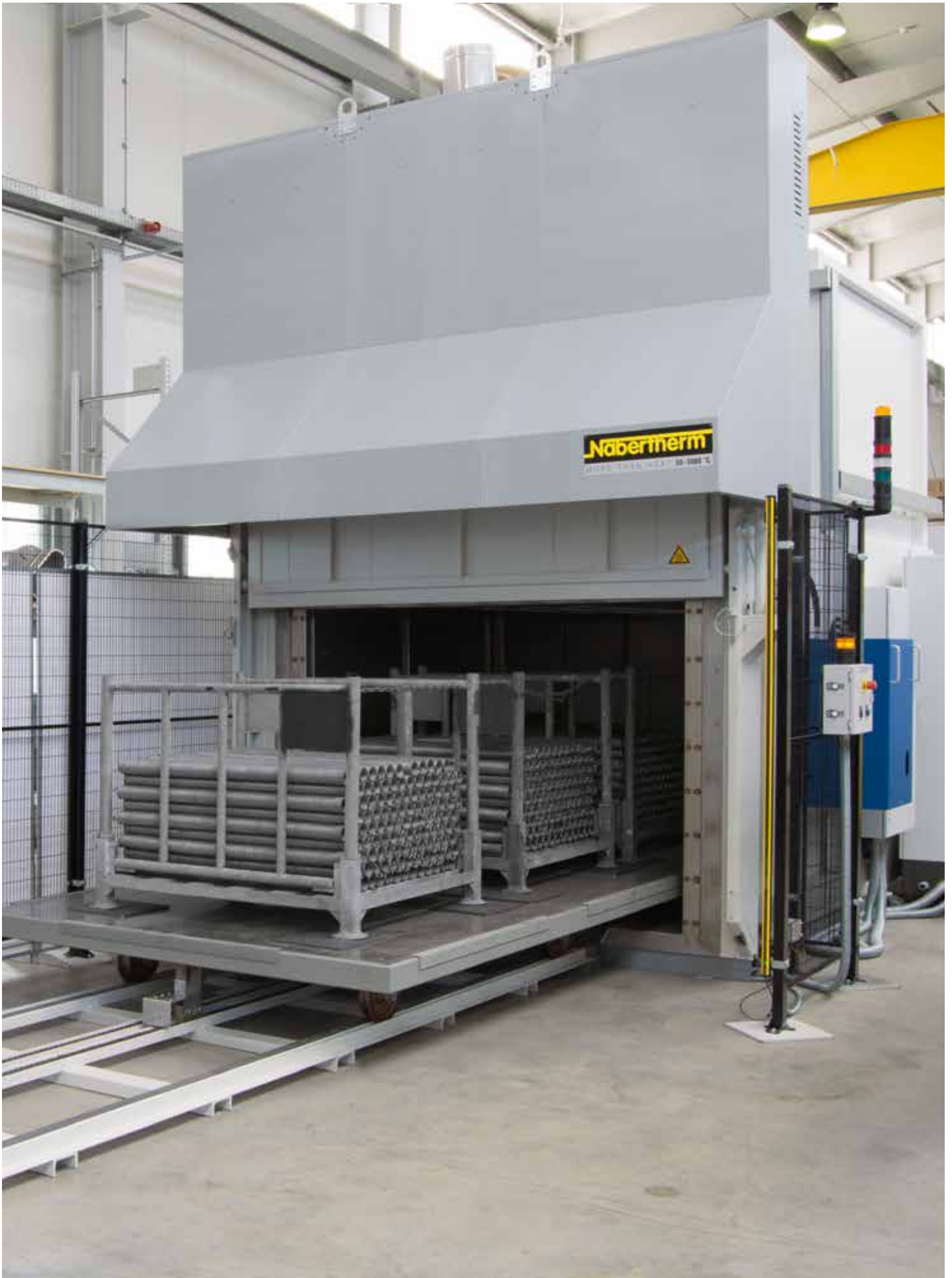
Horno de cámara por convección directa por gas NB10080/26HAS con vagoneta de carga motorizada
