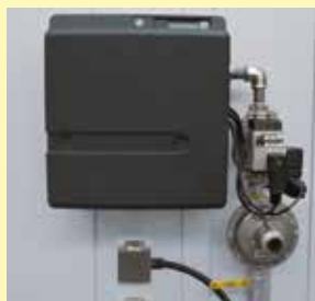
Hornos de cámara con circulación de aire y calentamiento por gas, por ejemplo, con quemador compacto
