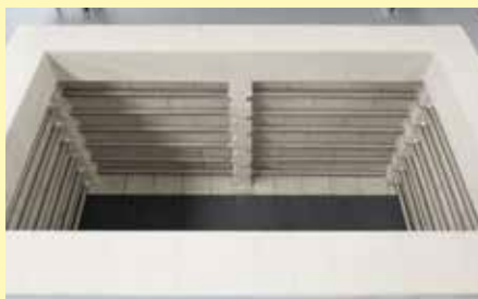
Cámara del horno S 430
