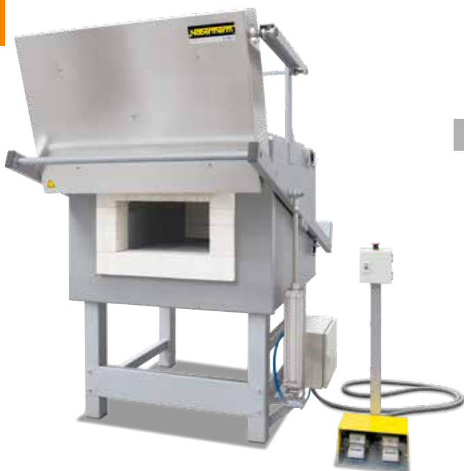
Horno de cámara N 81/13 con puerta de apertura neumática
