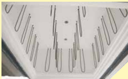
Calentamiento desde todos los lados y entre la pila para optimizar la homogeneidad de la temperatura
