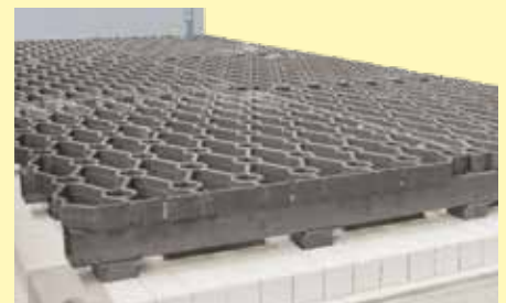
Superficie de carga en un horno de vagoneta con circulación de aire para una distribución uniforme de la carga
