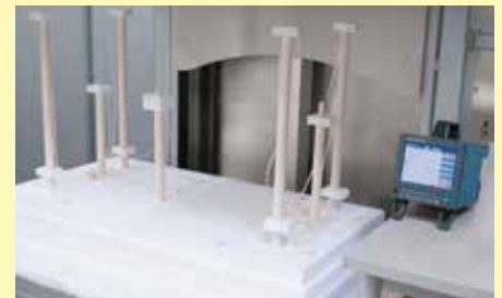
Dispositivo de medición para determinar la homogeneidad de la temperatura en un horno con elevador inferior de alta temperatura con dispositivo de elevación inferior
