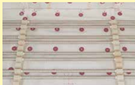
Cubierta de tejido para reducir el polvo de las fibras
