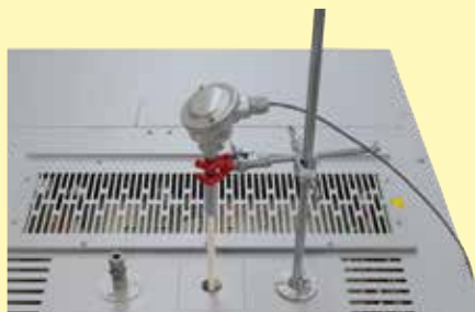
Orificio para termopar en el techo con soporte
