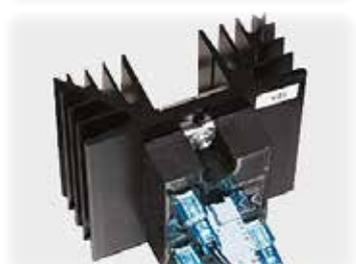
Conexión silenciosa de la calefacción con relé semiconductor
