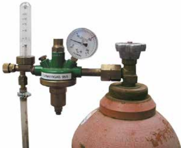
流量測定器のある減圧弁
