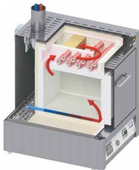
灰化炉 L 24/11 BO 内の空気供給の図
