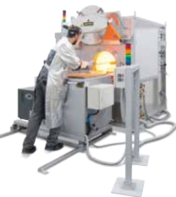
レトルト炉 NR 50/11 およびレール上の水焼入れ槽を備える半自動焼入れプラント
