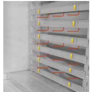
チャージへの空気供給を調節するための調節可能なエアシャッター
