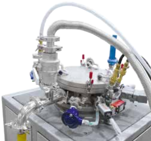
真空および保護ガス管、冷却水接続、熱電対および圧力センサーのあるレトルト
