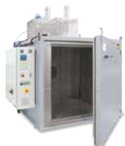
3D プリント後のバインダーの硬化用のチャンバー型乾燥機 KTR 2000
