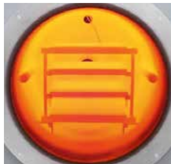
外付け槽での焼入れのために高温で取り出す際に使用できる装入フレームのある NR 50/11
