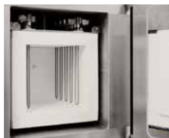
ファイバー断熱方式の二珪化モリブデン加熱装置
