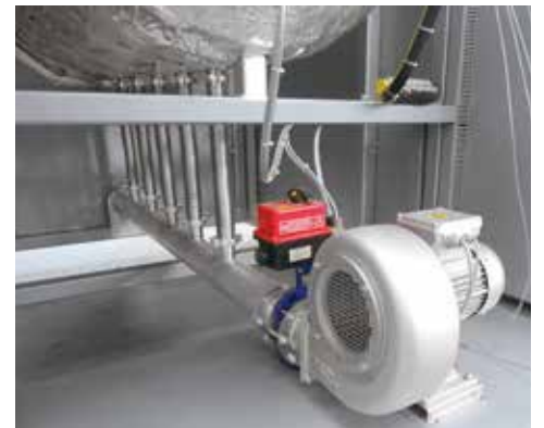
ファン冷却、高温壁レトルト炉 NRA 400/03
