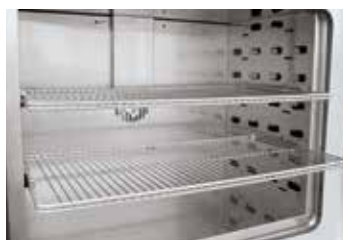
乾燥キャビネットをさまざまなレベルに取り付けるための引き出し可能な装入グリッド
