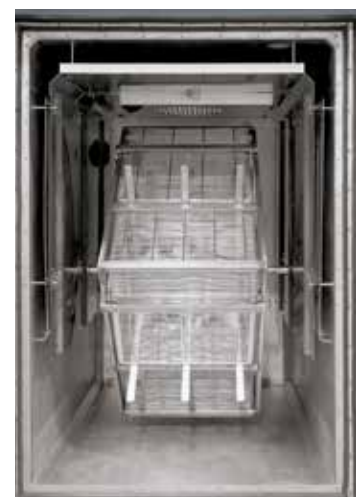
熱処理中は、チャージの移動用に、バスケットが取り付けられたモーター駆動式回転フレームを使用します。
