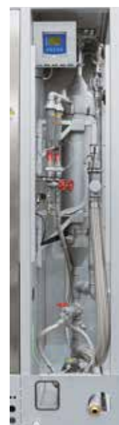
発生するプロセスガスを洗浄するための 排ガス浄化装置
