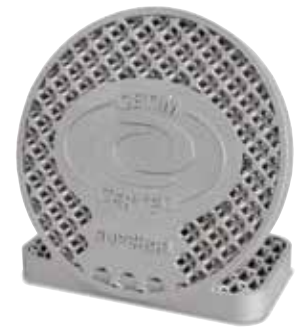
プリントされたアルミニウム製コンポーネント、N 250/85 HA モデル内で熱処理 (SUPCHAD プラットフォーム上のメーカー CETIM CERTEC)
