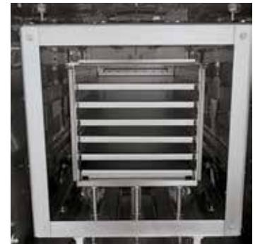
6つのチャージサポートのあるモリブデンプロセス容器
