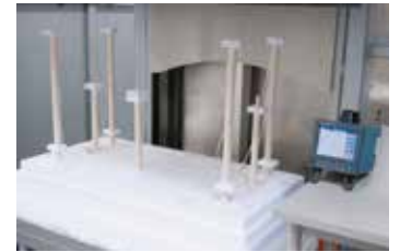
高温炉内の測定セットアップ
