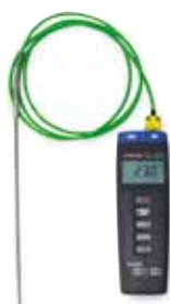
Temperaturmätningssenheter för RAKU-ugnar 100, enkel att hantera, temperatursensor NiCr-Ni, indikering för 20 °C - 1200 °C, Anslutningsmöjlighet för extra sensor med omkoppling av indikering
