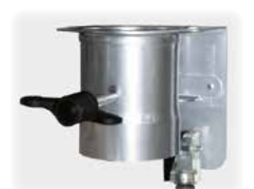
Halvautomatisk luftintagslucka för rest-torkningsfunktion hos kammarugnar upp till 300 liter. Luckan stängs automatiskt när den förinställda temperaturen har uppnåtts. Luftintagsluckan behöver alltså inte stängas manuellt efter torkningsfasen.
