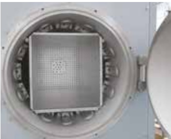
NRA .. /06型罐式炉的内置加热装置
