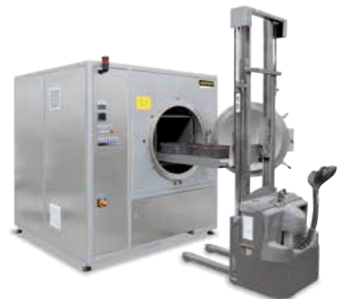
通过升降叉车给NRA 300/06 型罐式炉装料
