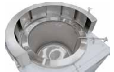
TS 90/80带有盐浴热电偶的型用于钢的热处理
