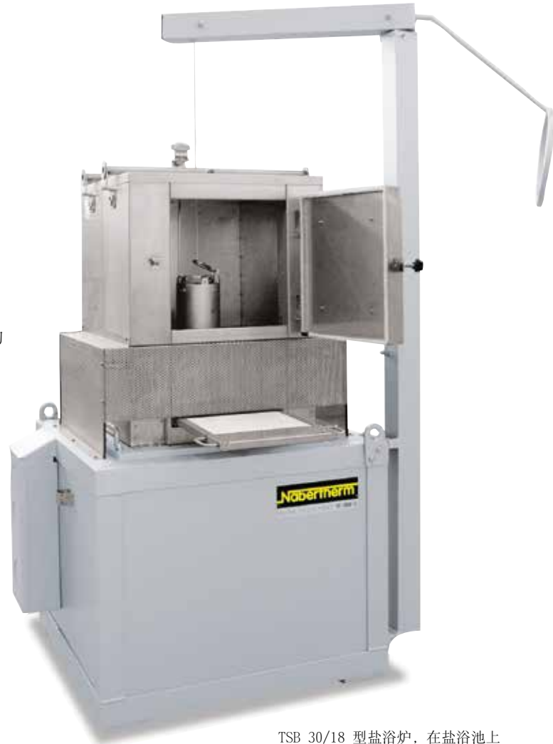
TSB 30/18 型盐浴炉，在盐浴池上方有预热腔和用于浸入炉料的装料辅助件
