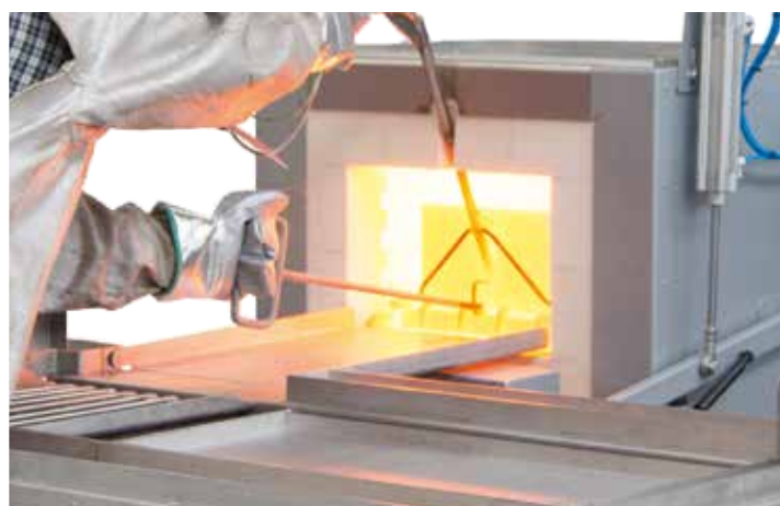
带N 41/H 型炉的保护气氛淬火系统
