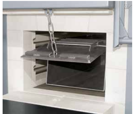
带盖子的退火盒会在炉门打开时一起打开
