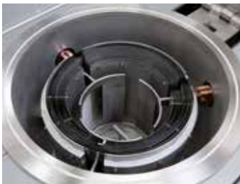
带钨丝加热装置的圆柱形气密罐
