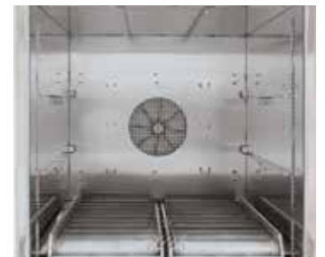
N 250/85HA 型空气循环箱式炉中的辊道
