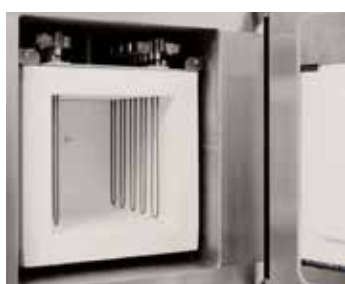
二硅化钼加热器和纤维保温层
