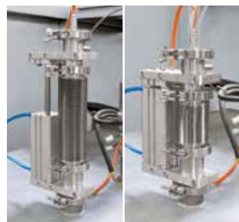
S 型热电偶，带有自动取出装置，确保了在较低温度范围内非常好的控温效果
