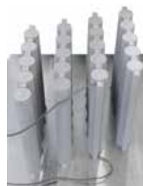
用NR 50/11型窑炉在氩气气氛中进行热处理后的钛拉伸棒
