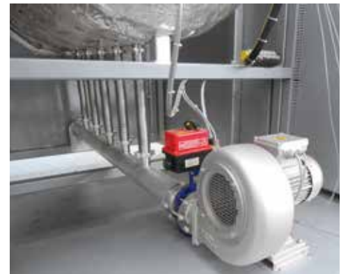
NRA 400/03型热壁罐式炉的鼓风机冷却
