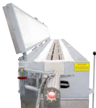
钢丝退火拉伸炉以管式炉为基础，长度为6米
