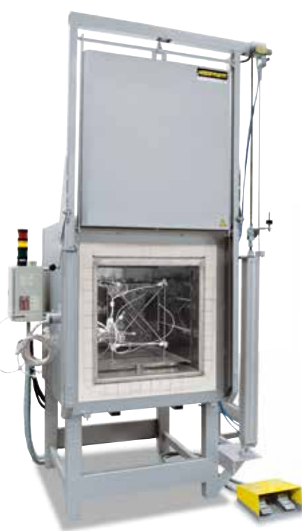
用来确定温度均匀性的测量架
