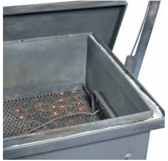
在带有炉料热电偶的供气盒中的保护气体气氛下进行热处理
