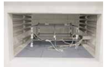
淬火炉内的测量结构
