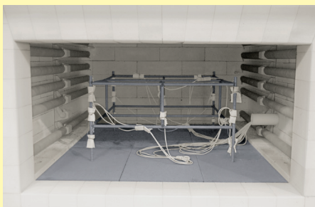
アニール炉での測定設置
