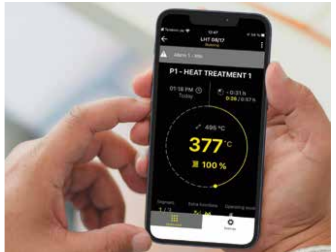
Notificaciones "push" en caso de anomalías
