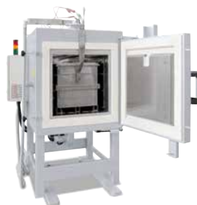
Камерная печь с циркуляцией воздуха N 250/85 HA с газационным коробом для тепловой обработки в атмосфере защитного газа
