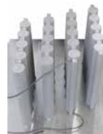
Растянутые стержни из титана после тепловой обработки в NR 50/11 в среде аргона
