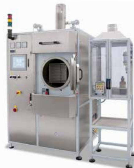
Ретортная печь NRA 40/02 CDB с приставным шкафом для кислотного насоса
