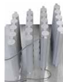
Barras de tracción de titanio después del tratamiento térmico en el modelo NR 50/11 en atmósfera de argón
