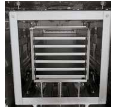
Caja de proceso de molibdeno con seis apoyos para la carga
