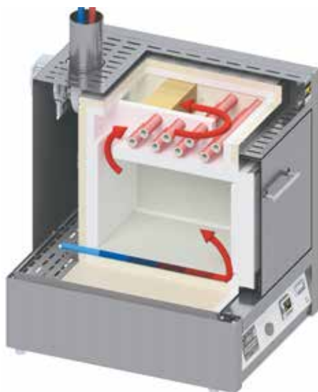
Presentación esquemática de la circulación de aire en el horno de incineración L 24/11 BO
