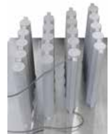
Barras de tracción de titanio después del tratamiento térmico en el modelo NR 50/11 en atmósfera de argón
