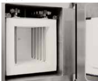
Elemento calefactor de molibdeno disilicio y aislamiento de fibras
