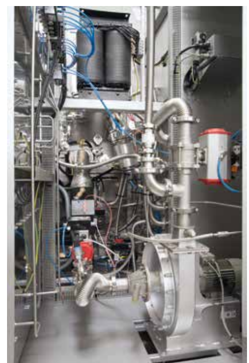
Refrigeración rápida por gas del horno de retorta de pared fría VHT 8/16-MO
