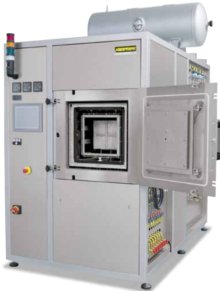
Horno de retorta VHT 40/16-MO H 2 paquete de ampliación de hidrógeno y caja de proceso
