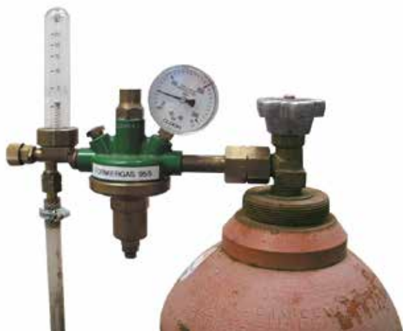
Válvula reductora de presión con medidor del volumen de paso
