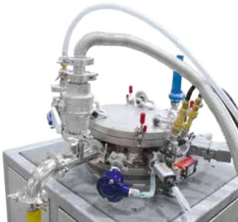
Retorta con conductos de vacío y de gas protector, conexiones de agua de refrigeración así como termopares y sensores de presión
