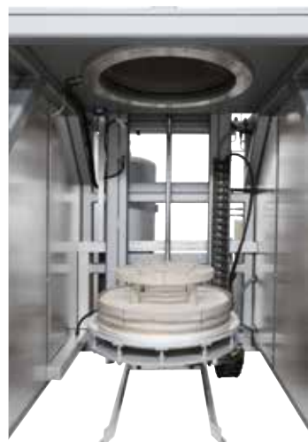
Horno de retorta de base elevable LBR 300/11 H 2 con técnica de seguridad para el funcionamiento con hidrógeno como gas de proceso
