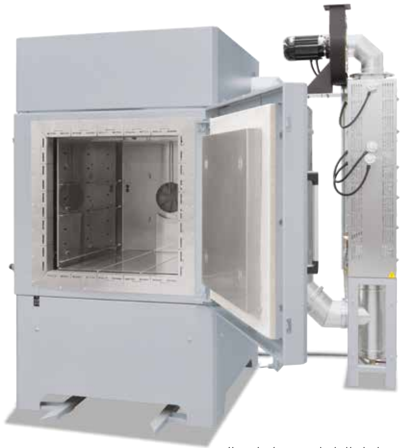
Horno de cámara con circulación de aire N 500/65 HA DB200 para debinding en aire con sistema de postcombustión catalítica
