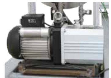
Bomba de vacío para evacuación en frío de la retorta
