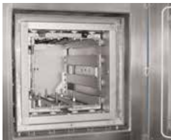
Elemento calefactor de molibdeno o wolframio
