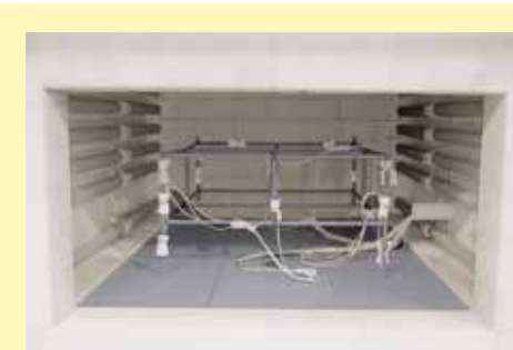
Estructura de medición en un horno de recocido
