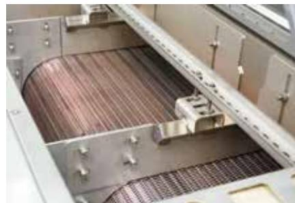
D 1100/3600/100/50 AS 型连续炉中的网带驱动装置
