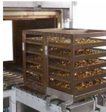
用于盘装散料热处理的连续炉
