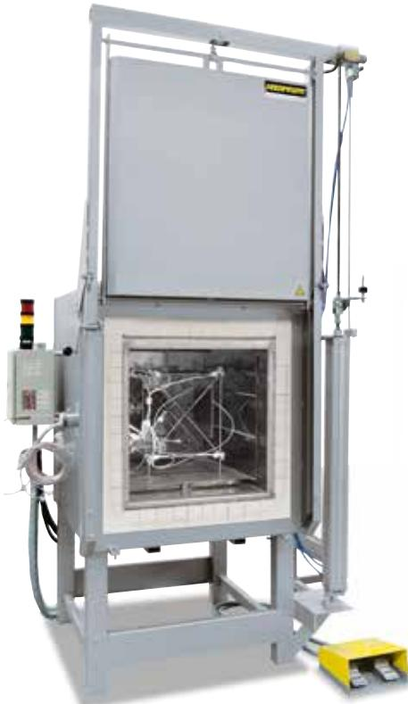
用来测量温度均匀性的测量架
