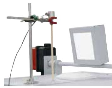
作为附加装备的排气门和带支架的炉料热电偶
