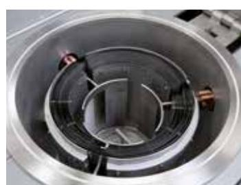
带钨丝加热装置的圆柱形气密罐
