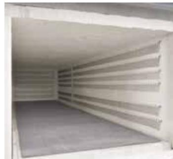
适于短时工艺的蜿蜒形加热元件
