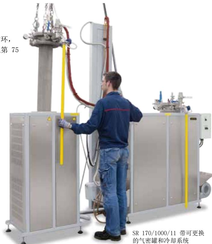
SR 170/1000/11 带可更换的气密罐和冷却系统
