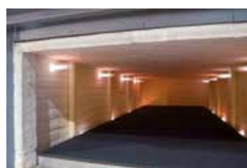
带有八个高速燃烧器的炉腔
