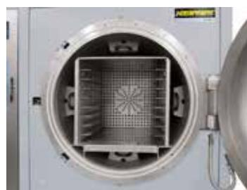
带有内加热装置和工艺腔的反应罐
