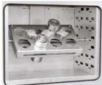
电动旋转装置作为额外装置
