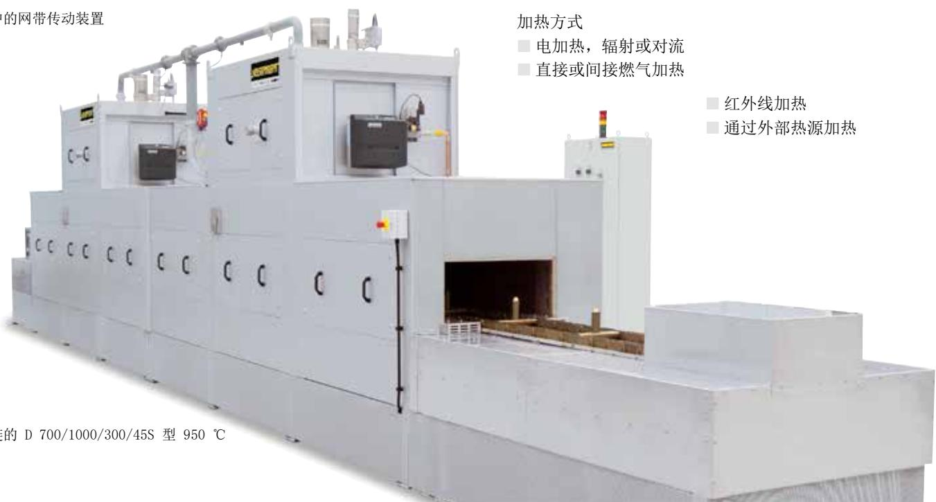
带输送链的 D 700/1000/300/45S 型 950 °C
