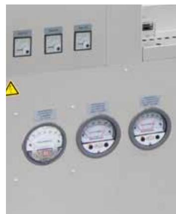
在排胶工序包 DB200 中显示压力和流量
