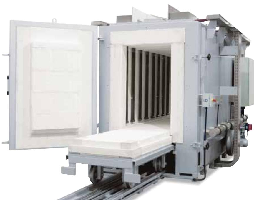
SiC 棒加热式台车炉可用于工业陶瓷的生产，尤其适用于最高工作温度为 1550 °C 的烧结过程。WHTC 系列电炉结构特别牢固，可以承受包含窑具的重载。炉膛配有由高温纤维块组成的优质保温层。台车拥有多层保温结构，在高温炉膛一侧由轻质耐火砖组成。
