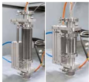
S 型热电偶，带有自动取出装置，确保了在较低温度范围内非常良好的控温效果
