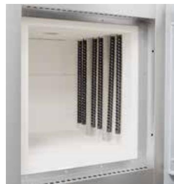
排胶系统的垂直悬挂式 SiC 棒和可选配的多孔进气管
