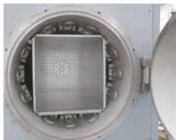
NRA .../06 炉型设有内置加热元件
