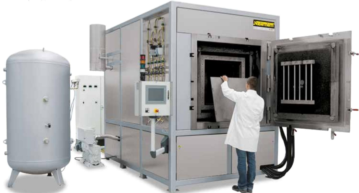
VHT 500/22-GR H<sub>2</sub> 连同扩展包和CFC 工艺盒，用于氢气环境下的操作
