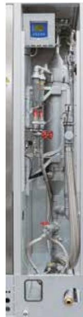
废气净化器，用于通过清洗来净化产生的过程气体
