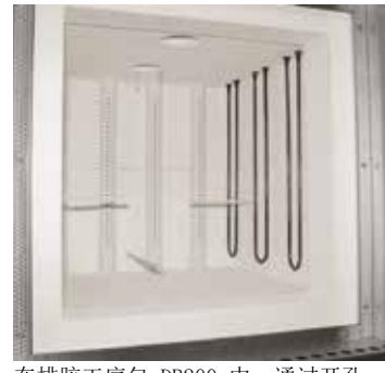
在排胶工序包 DB200 中，通过开孔的进气管导入新鲜空气
