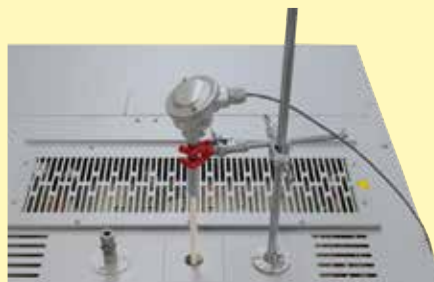
Thermoelement-Durchführung in der Decke mit Stativ
