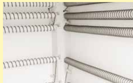
Ausführung als LF-Modell für kürzere Aufheiz- und Abkühlzeiten
