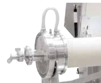
Wassergekühlter Vakuumflansch (Begasungspaket 2)
