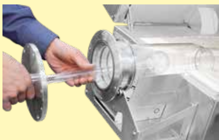
Gasdichter Verschlussstopfen für einseitig geschlossenes Quarzglasrohr als Zusatzausstattung
