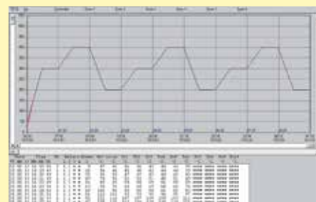
Software für Dokumentation der Temperaturkurve und des Glühverlustes per PC
