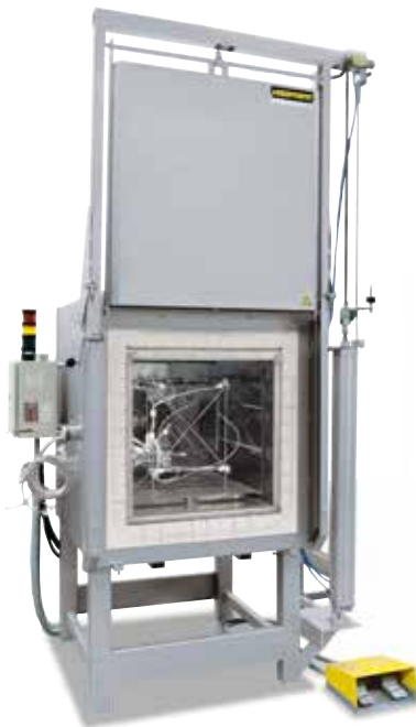
Messgestell zur Ermittlung der Temperaturgleichmäßigkeit
