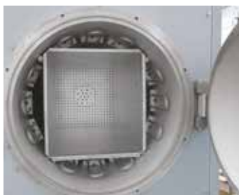
Innenbeheizung Retortenofen NRA ../06
