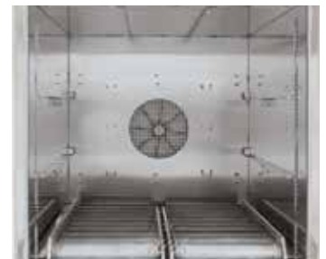
Rollgang im Umluft-Kammerofen N 250/85HA
