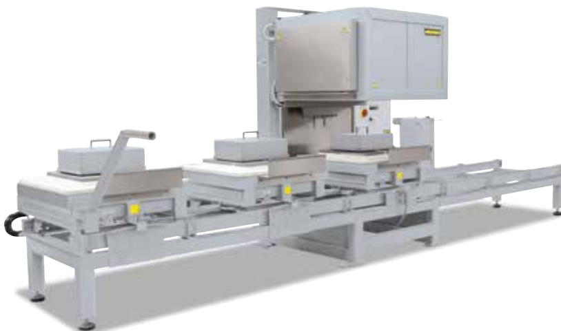
Haubenofenanlage mit drei Wechseltischen und Begasungskästen für die Wärmebehandlung unter nicht brennbaren Schutz- oder Reaktionsgasen
