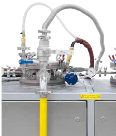
Wechselretorten mit Versorgungs- und Messleitungen
