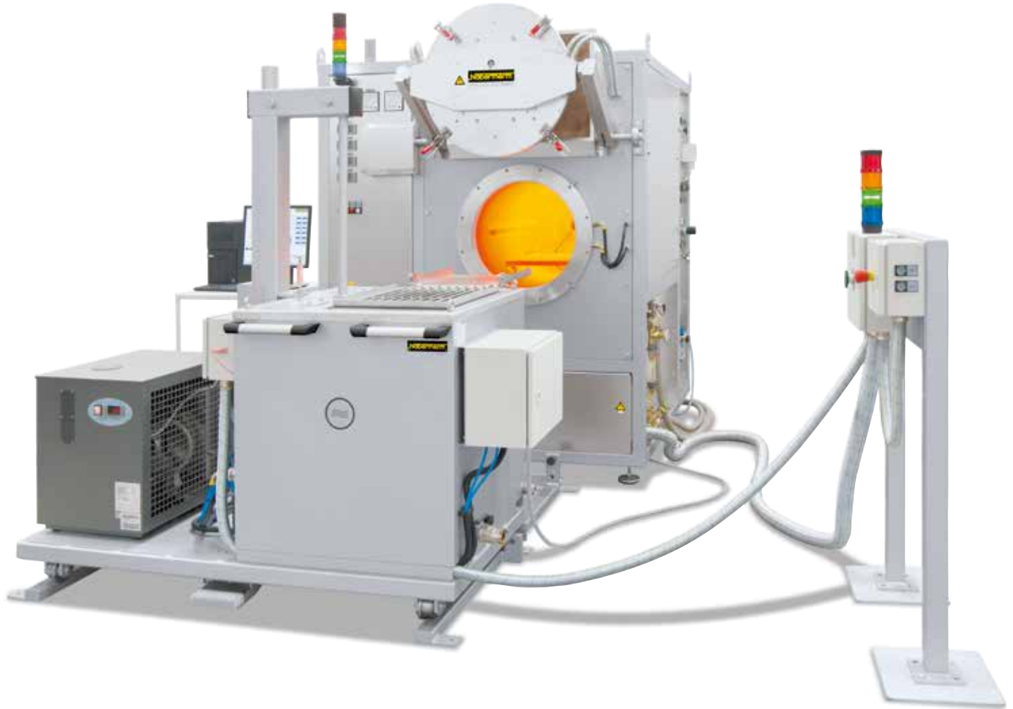
Halbautomatische Vergüteanlage mit Retortenofen NR 50/11 und Wasserabschreckbad auf einem Schienensystem
