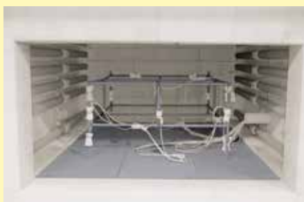
Messaufbau in einem Glühofen
