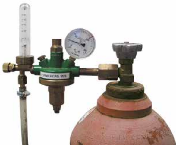
Druckreduzierventil mit Durchflussmengenmesser
