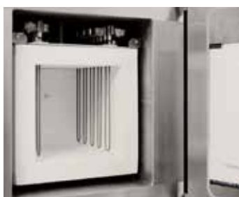
Molybdändisilizid-Heizer mit Faserisolierung
