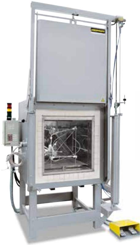
Messgestell zur Ermittlung der Temperaturgleichmäßigkeit
