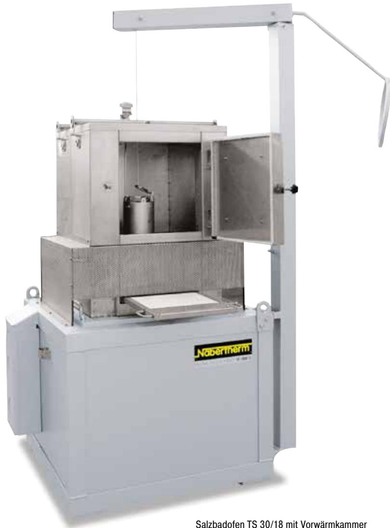
Salzbadofen TS 30/18 mit Vorwärmkammer oberhalb des Salzbad und Beschickungshilfe zum Eintauchen der Charge
