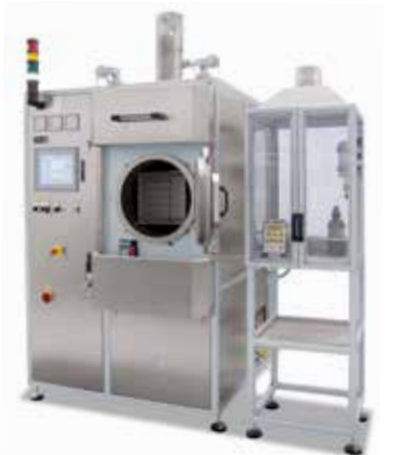
Retortenofen NRA 40/02 CDB mit Beistellschrank für die Säurepumpe
