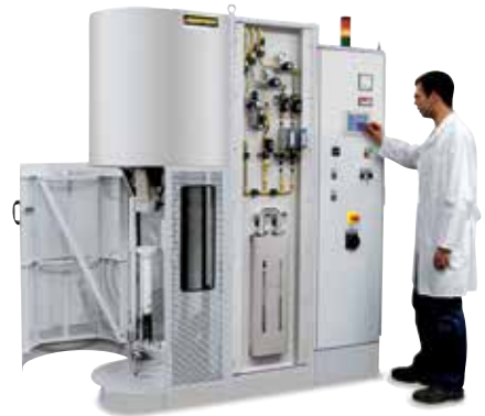
Rohrofen RHTV 120/480/16 LBS mit einseitig geschlossenem Arbeitsrohr, Schutzgas- und Vakuumsystem sowie elektrischem Spindeltrieb des Hubtisches
