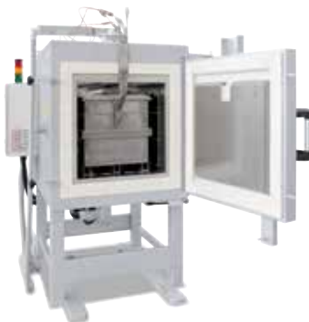
Umluft-Kammerofen N 250/85 HA mit Begasungskasten
