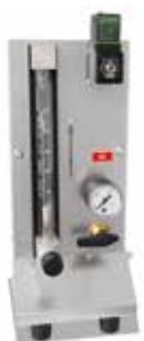
Begasungssystem für nicht brennbare Schutz- oder Reaktionsgase
