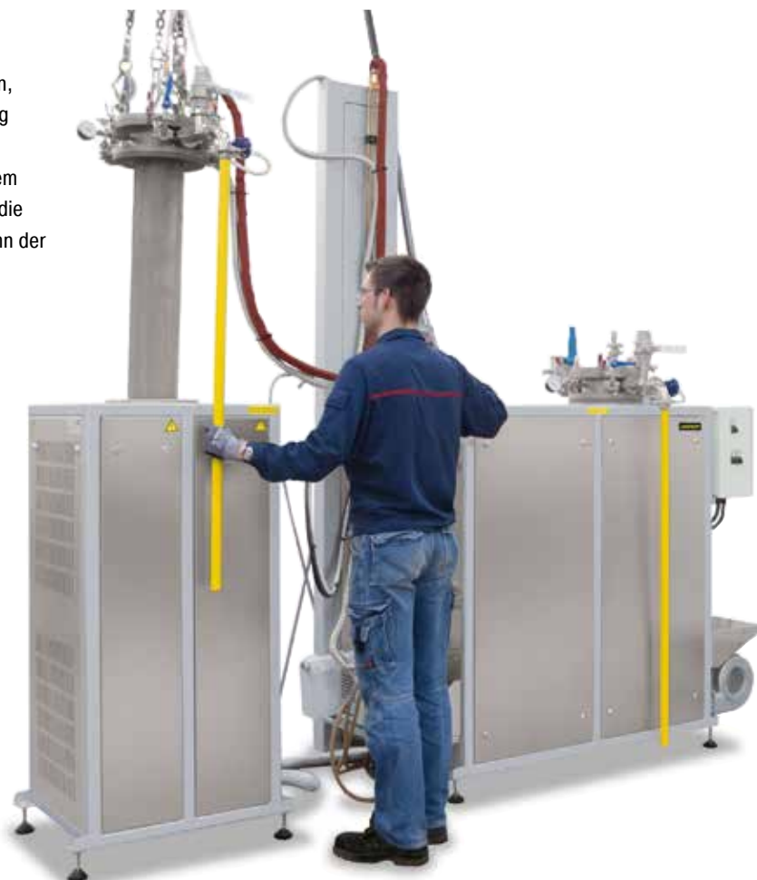
Retortenofen SR 170/1000/11 mit Wechselretorte und Kühlstation
