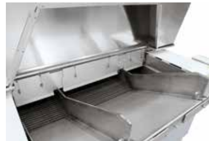
Förderband ausgeführt als Gliedergurt, alternativ als Band verfügbar
