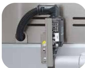
打开炉盖时会关闭加热器
