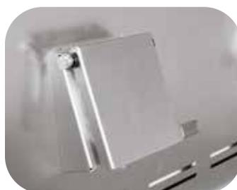
开口可以关闭，用于通风、冷却和观察炉料
