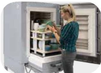
Altura de carga ergonómica con soporte de 780 mm (horno de cámara N 440 - N 660 = 500 mm)
