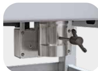
Válvula de entrada de aire semiautomática para el secado residual en hornos de cámara de hasta 300 litros. La válvula se cierra automáticamente a una temperatura predeterminada. Se elimina el cierre manual de la entrada de aire tras la fase de secado.
