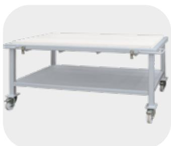
Tables complémentaires du système de four pour les modèles GFM ; système de changement de table pour l'exploitation de la chaleur résiduelle du four et la réduction des durées de cycles par un changement de table à l'état chaud.
