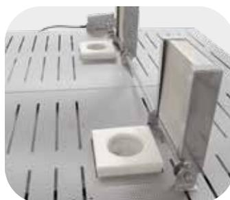
Trappe d'évacuation d'air automatique pour un refroidissement accéléré du four après achèvement de la cuisson
