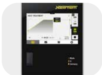
Manuel zoneregulering til optimal ensartet temperatur
