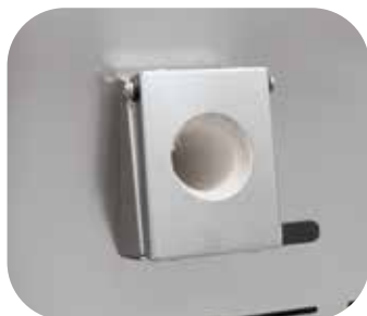
Wziernik w otworach powietrza dół- towego do obserwacji szkła.
