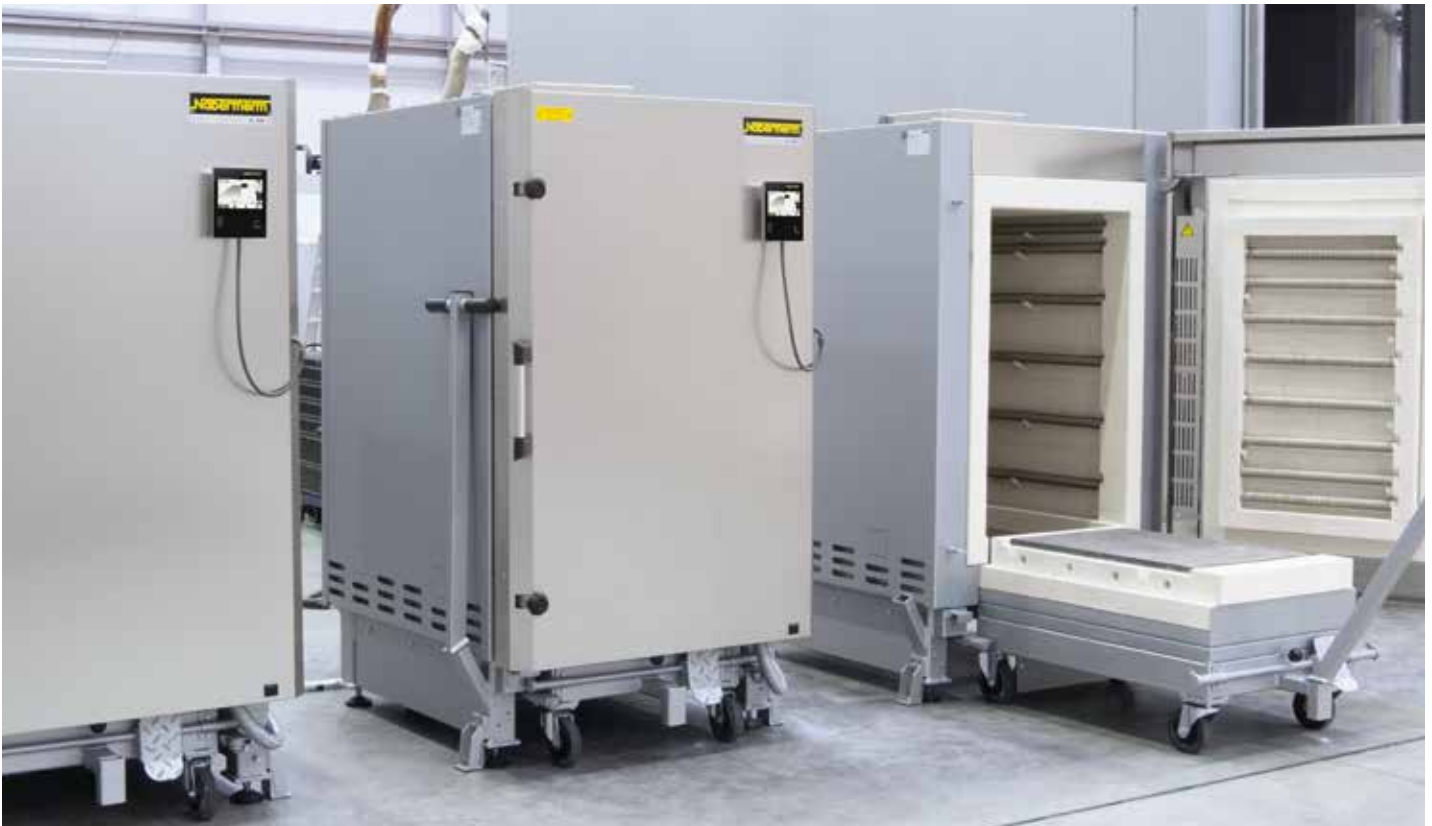
Piece komorowe z wysuwającym wózkiem do ergonomicznego załadunku komory paleniskowej
