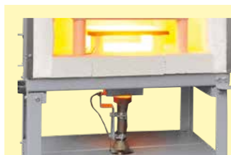
Пропановая горелка мощностью 15 кВт, установленная под печью
