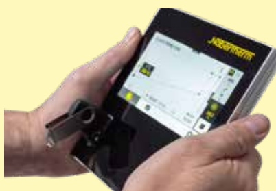
Запись технологических данных подключенного контроллера с помощью USB-накопителя
