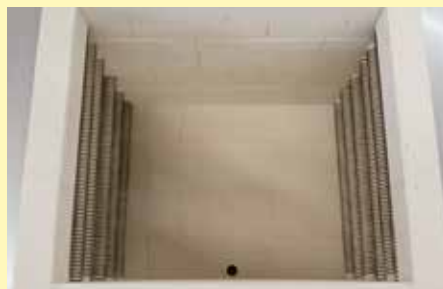
Нагревательные элементы на несущих трубах обеспечивают свободное тепловое излучение
