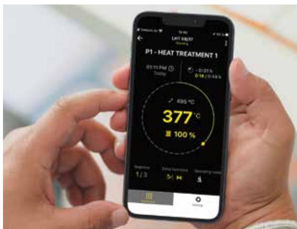
Индикация хода выполнения программы для каждой печи
