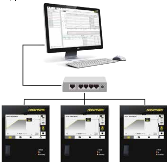
Пример конструкции с тремя печами
