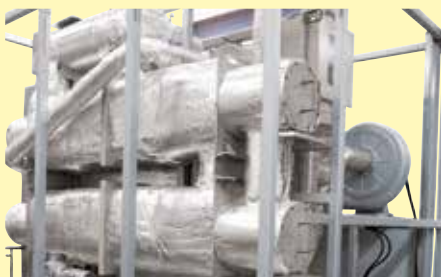
Gegenstrom-Wärmetauscher am Umluft-Kammerofen N 2560/26 ACLS
