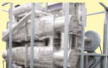
熱風循環式チャンバー炉に装備した逆流型熱交換器 N 2560/26 ACLS
