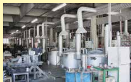
Рекуперативные горелки в плавильной печи для алюминия 16 x TBR 110/12 и 2 x TBR 180/12
