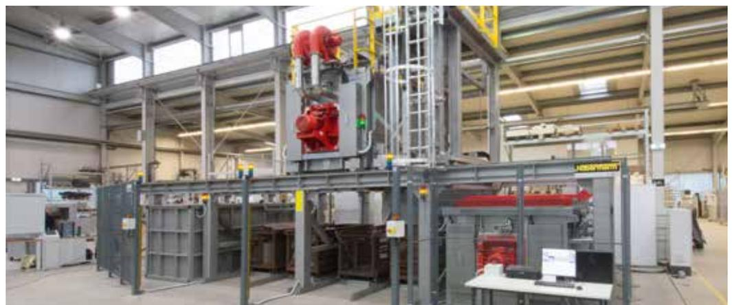
Fallschachtofenanlage für Aluminium
