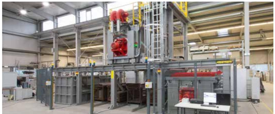
Impianto di forno a caduta per alluminio
