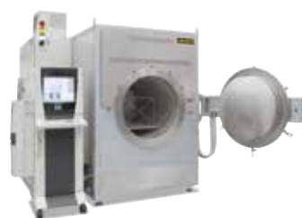
Forno a storte a pareti calde NR 300/09 per il trattamento di distensione di componenti metallici in atmosfera controllata o sottovuoto dopo la stampa 3D
