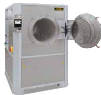
3D プリント後の金属コンポーネントの保護ガスまたは真空下での応力除去焼鈍用の高温壁レトルト炉 NR 80/11
