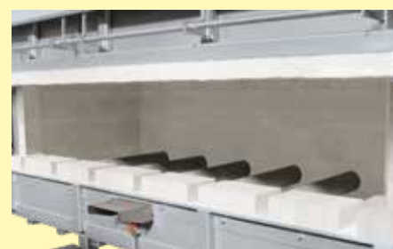
Calentamiento por gas indirecto con tubos de radiación
