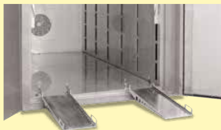
Rampas de entrada para secadores de cámara con aislamiento en el suelo
