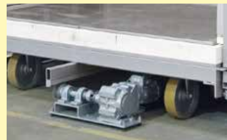
Vagonetas con ruedas de acero y engranajes de cremallera, sin colocación de rieles fuera del horno
