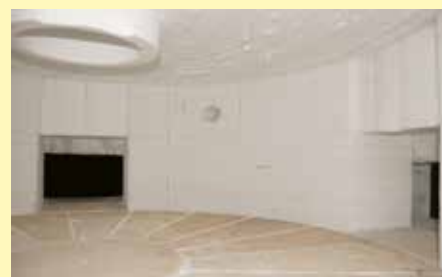
Mesa giratoria con placas de soporte de hormigón ignífugo para proteger el aislamiento
