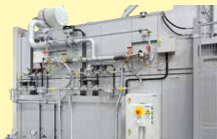
Horno de convección forzada por quemadores de gas, WB4000/85 con vagoneta
