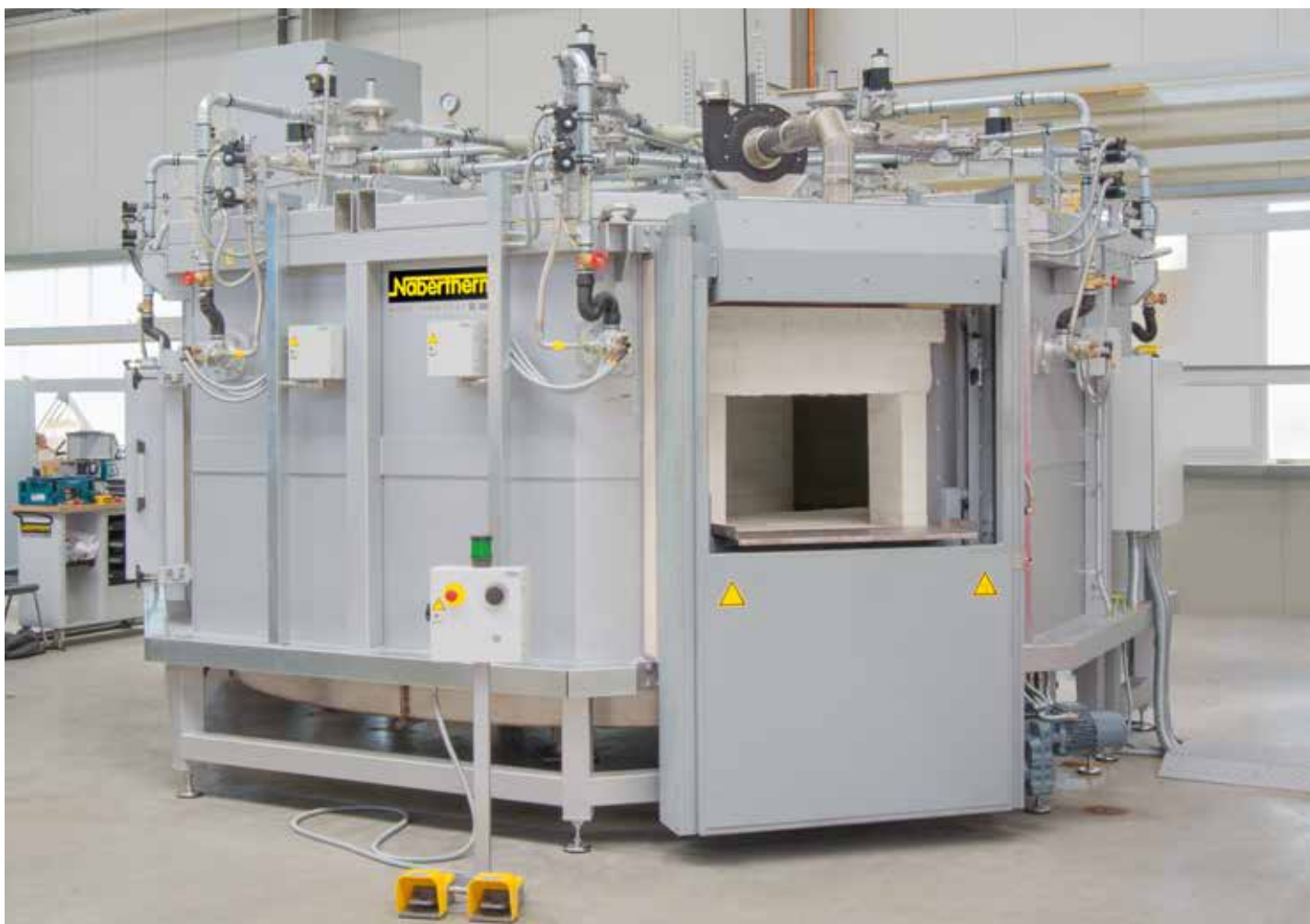
Horno de solera rotatoria calentado directamente a gas con Tmax 1100 °C para el precalentamiento de moldes
