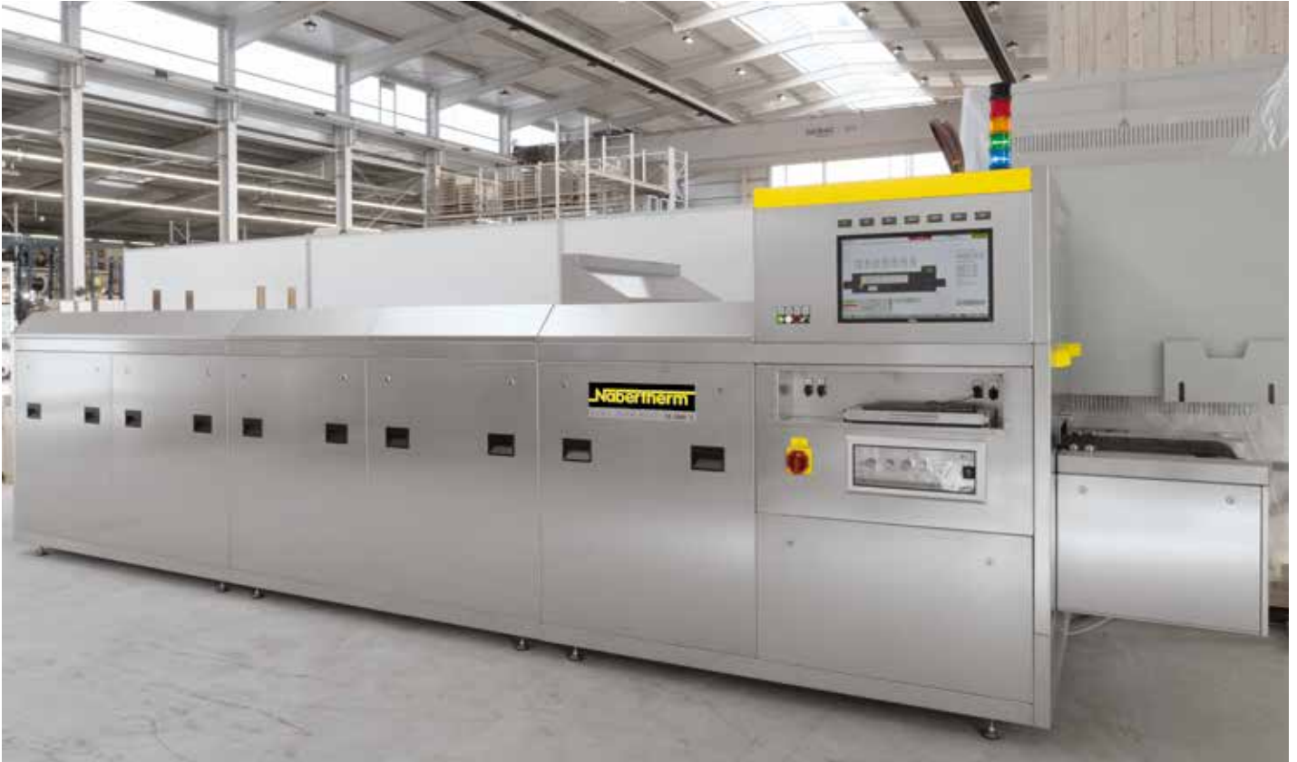
Horno continuo DF 36/320/5/10WK para quemado y cocción/sinterización en aplicaciones LTCC
