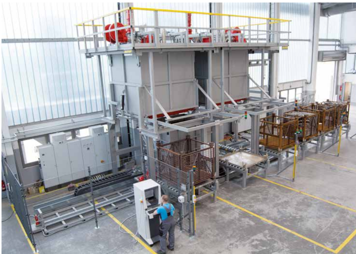
Instalación de horno con apertura inferior totalmente automatizada, compuesta por dos hornos con apertura inferior, baño de agua desplazable y varios puntos de carga y descarga.
