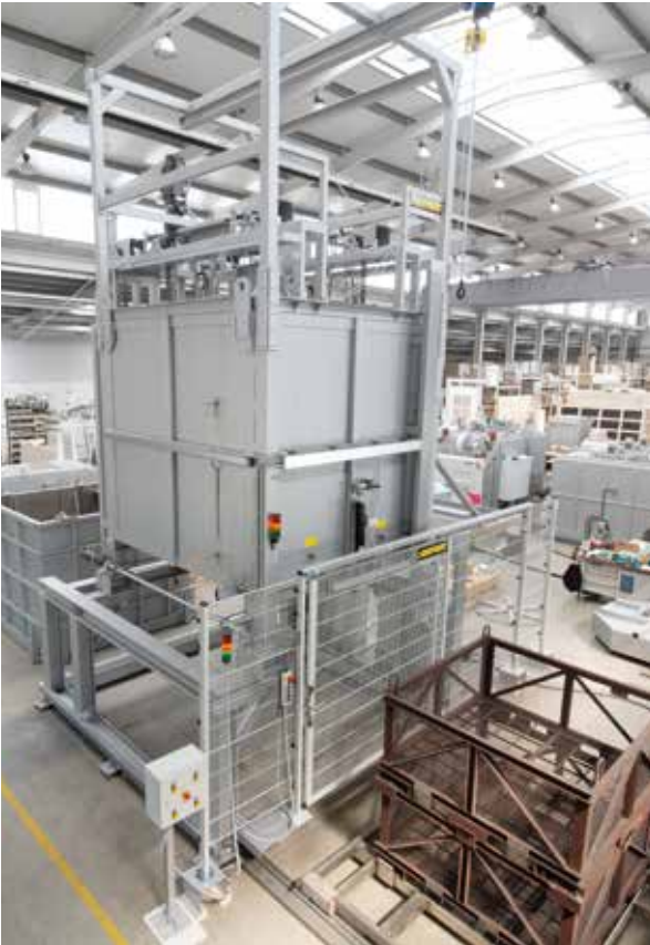
Horno de apertura inferior FS 5670/60AS con baño de enfriamiento integrado en el suelo (variante C)
