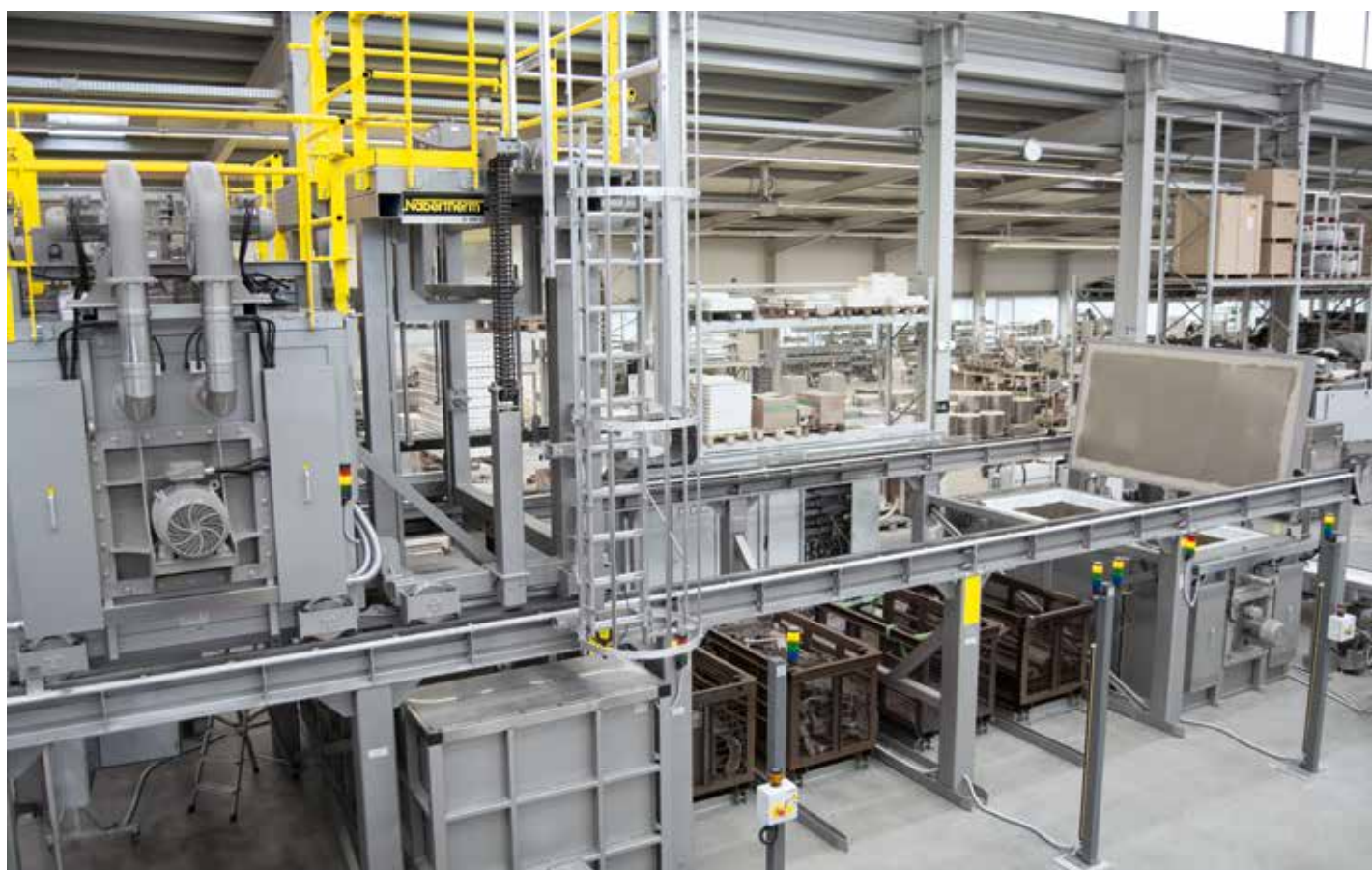
Horno con apertura inferior desplazable para el recocido por disolución con horno de cuba para el envejecimiento artificial con cuatro puestos de depósito
