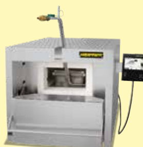
Horno de cámara N 7/H para el recocido para aliviar tensiones de piezas de metal bajo gas protector tras la impresión en 3D
