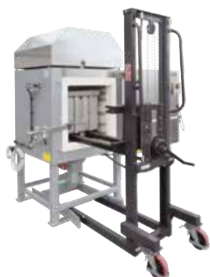
Horno de cámara LH 216/12 para el recocido para aliviar tensiones de piezas de metal bajo gas protector tras la impresión en 3D
