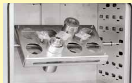
Sistema rotatorio (en este caso con un soporte personalizado para contenedores de autoclave PARR)
