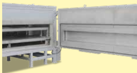
Puerta de mantenimiento del horno de cajones NA 5320/S
