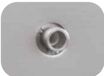
Schauloch in der Ofentür, Durchmesser 15 mm (nicht für Kammeröfen N .. E)
