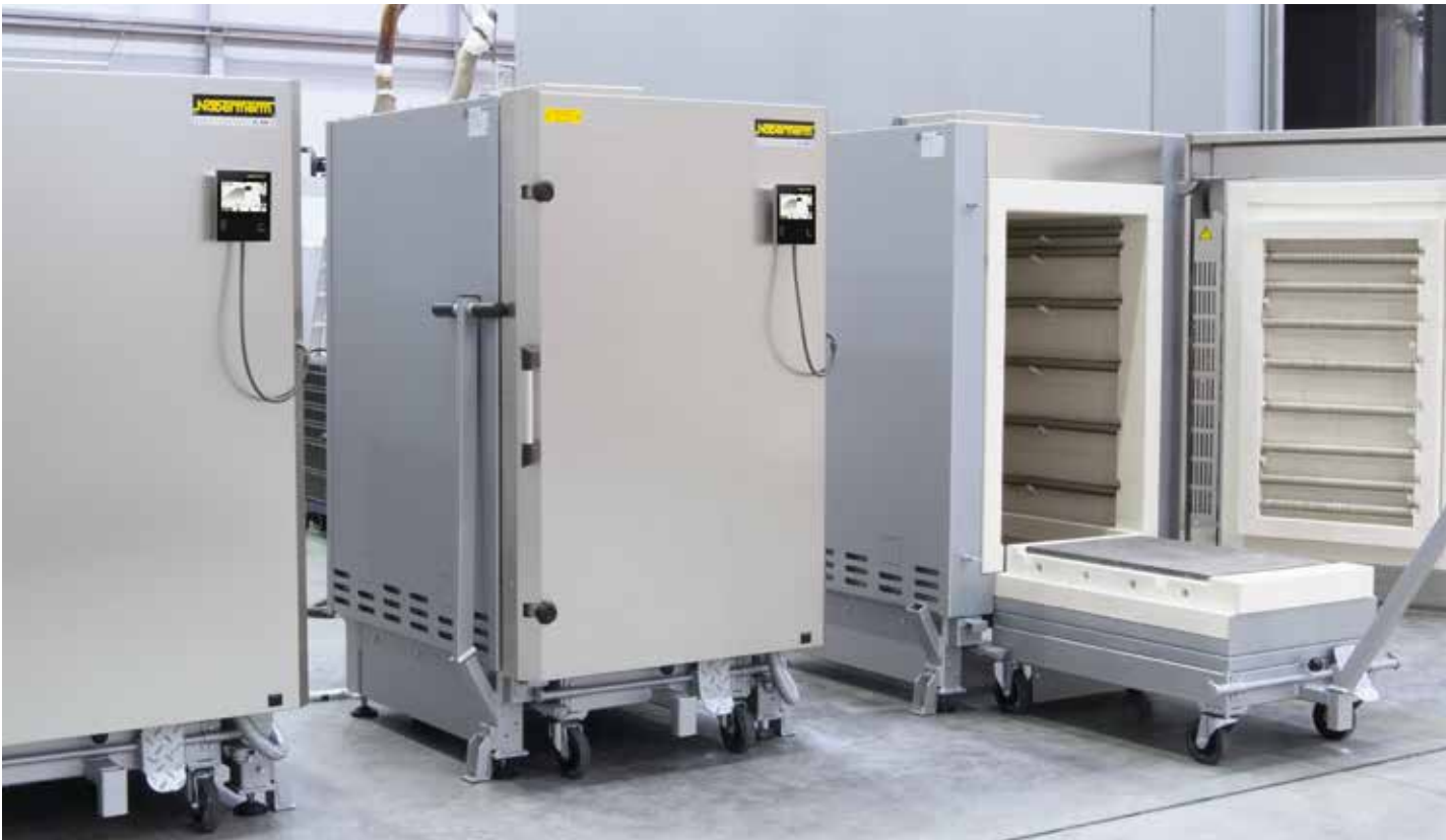
Kammeröfen mit herausziehbarem Wagen für ergonomisches Chargieren der Brennkammer
