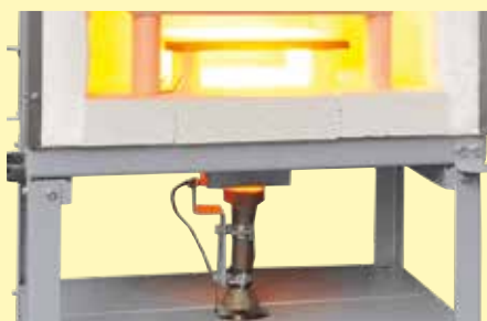
Propangasbrenner mit 15 kW unter dem Ofen montiert
