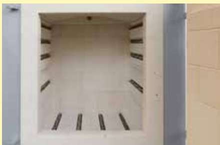
Dreiseitige Beheizung durch Heizelemente geschützt in Rillen
