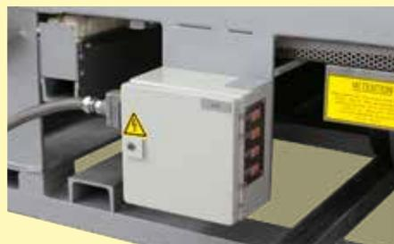
Anschluss Chargenthermoelemente mit Steckverbindung
