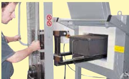
Arbeiten mit Begasungskasten für Schutzgasatmosphäre mit Hilfe eines Chargierwagens
