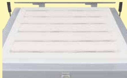
Bodenheizung für gleichmäßige Durchwärmung großer Objekte
