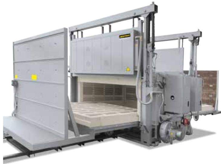
Kombiofenanlage, bestehend aus zwei Herdwagenöfen W 5000/H, Herdwagenverschiebesystem und zwei zusätzlichen Herdwagen inkl. der benötigten Abstellgleise
