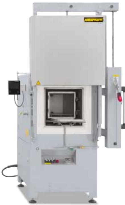
Umluft-Kammerofen NA 60/85 mit manueller Hubtür und Begasungskasten für Frontbeladung
