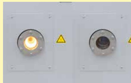
Gekühltes Schauglas aus Saphirglas (links bei Arbeitstemperatur, rechts bei Raumtemperatur)
