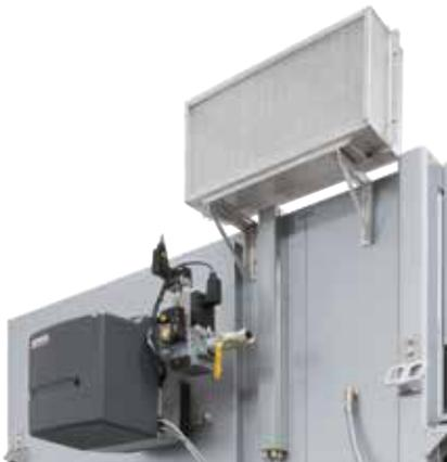
Direkte Gasbeheizung an einem Kammertrockner
