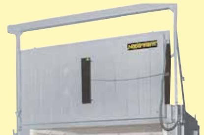
Elektrohydraulisch angetriebene Hubtür
