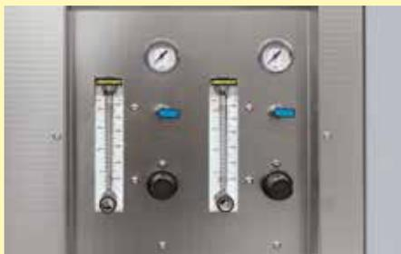
Automatisches Begasungssystem mit Magnetventil und Schwabekörper-Durchflussmesser
