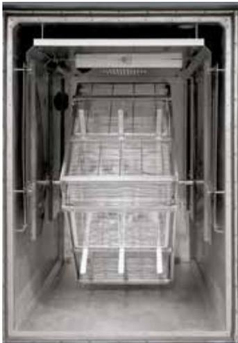
Motorisch angetriebenes Drehgestell mit eingesetzten Körben zum Bewegen der Charge während der Wärmebehandlung
