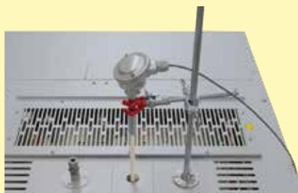
Thermoelement-Durchführung in der Decke mit Stativ
