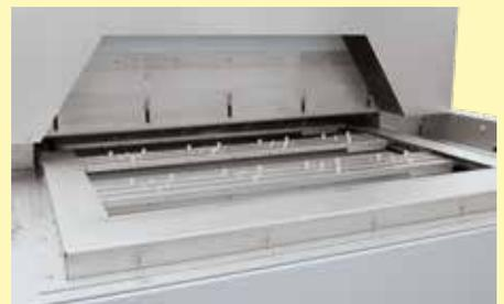
Durchlaufofen D 1000/1250/200/26AS zur Temperung von Spritzgussteilen
