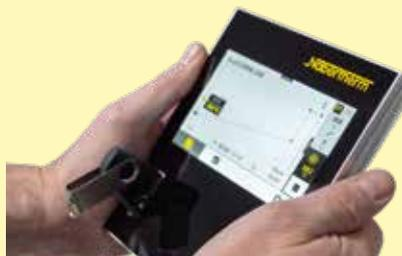
Registro de datos de proceso del controlador conectado a través de una memoria USB
