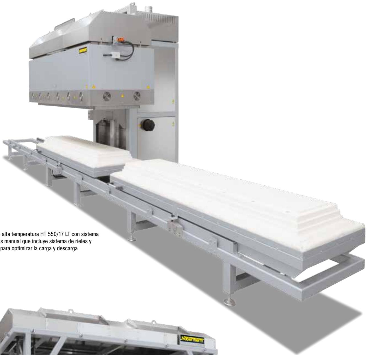
Horno de cúpula de alta temperatura HT 550/17 LT con sistema de cambio de mesas manual que incluye sistema de rieles y una segunda mesa para optimizar la carga y descarga
