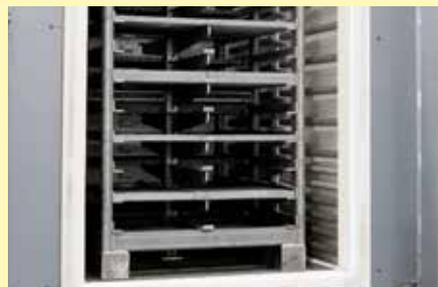
Bastidor de carga para horno de cámara N 2200
