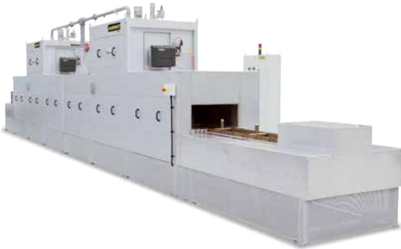
Horno continuo D 700/10000/300/45S con cadena de transporte para 950 °C, calentamiento por gas
