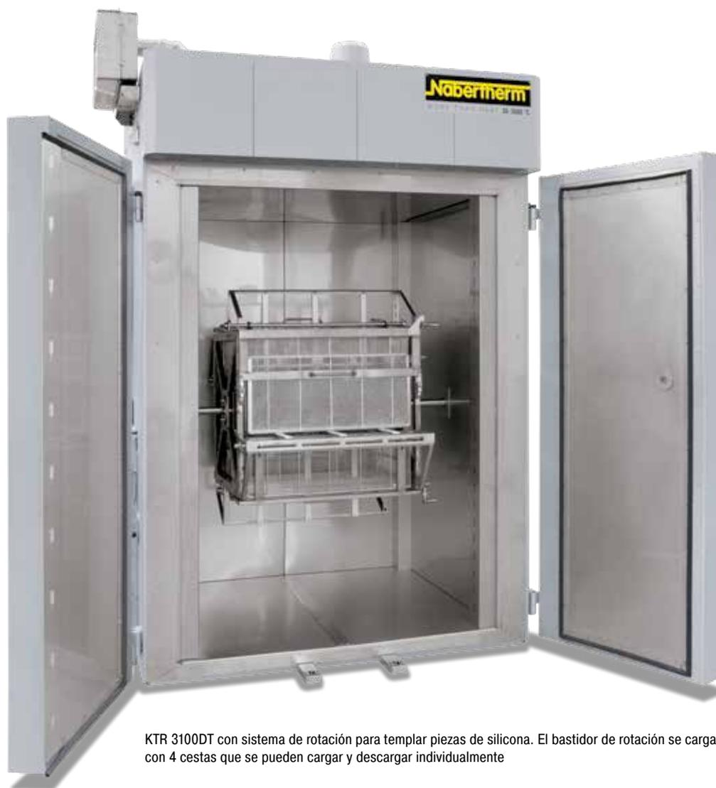
KTR 3100DT con sistema de rotación para templar piezas de silicona. El bastidor de rotación se carga con 4 cestas que se pueden cargar y descargar individualmente
