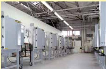
Horno de cámara N 200/14 para el sinterizado de
