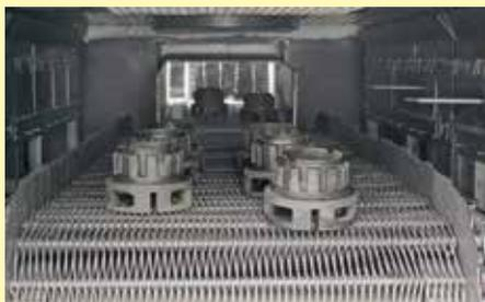
Banda transportadora de malla en horno continuo
