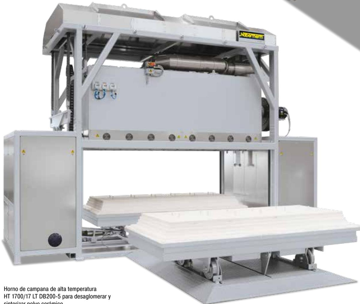
Horno de campana de alta temperatura HT 1700/17 LT DB200-5 para desaglomerar y sinterizar polvo cerámico
