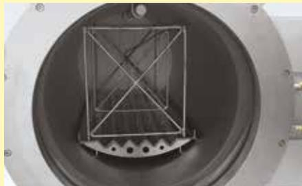
Superficie de carga y bastidor de medición TUS para horno de retorta NR 20/11
