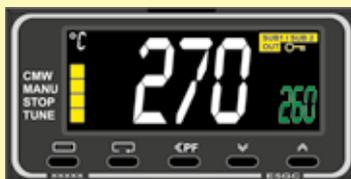
Ejemplo de un limitador de sobre-temperatura
