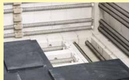
La calefacción del suelo se preserva con un revestimiento de placas de SiC (base plana para el soporte de carga).
