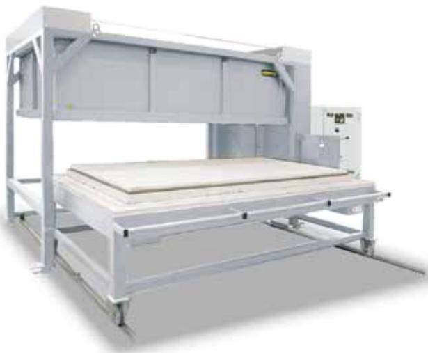
Horno de campana con mesa HG 1196/S con calentamiento de campana y mesa; calentamiento de mesa desconectable para trabajos de fusión.
