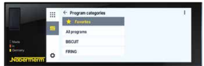
温度プログラムをお気に入りとしてカテゴリー別に保存できます
