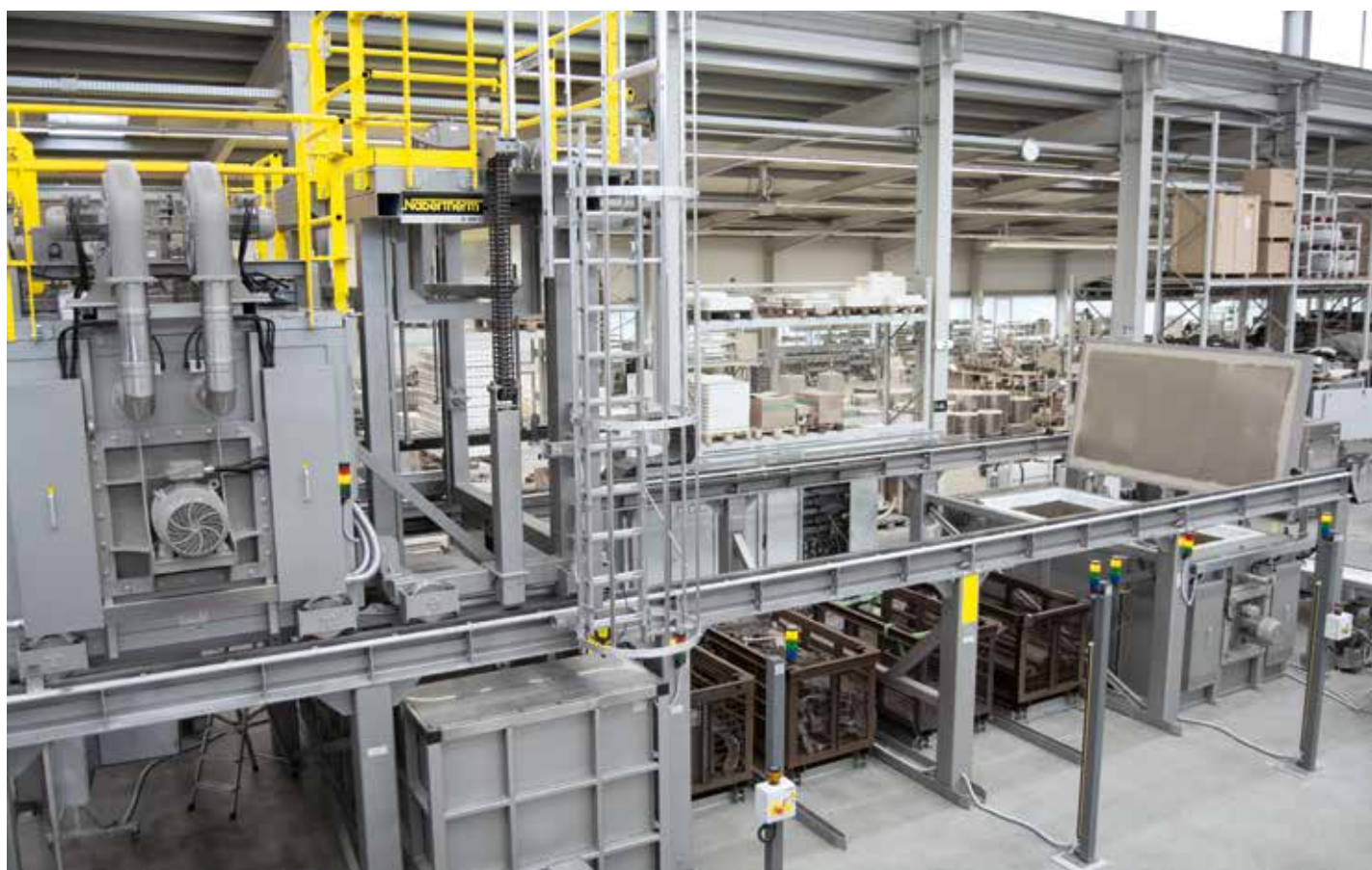
4つの停止位置がある人工時効用シャフト炉のある溶体化焼鈍用可動式投下型シャフト炉
