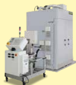
KTR 3100/S 真空サックの中の繊維強化複合材料の凝固用 ポンプおよび炉室の接続付き
