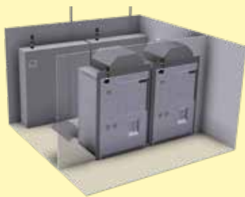
クリーンルームを装備した高温炉；スイッチと炉はグレイルームに設置
