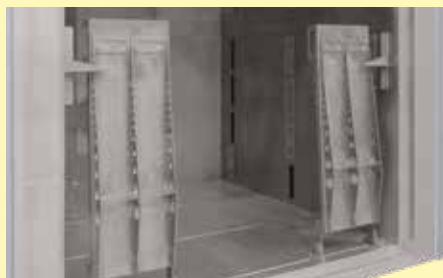
温度均一性の要求度が高いプロセス用の底断熱付き炉のドライブインランプ
