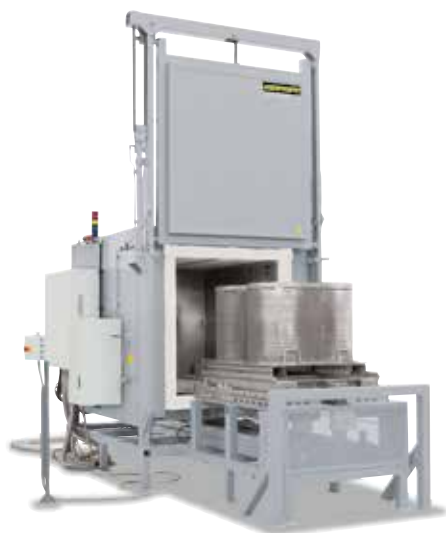
重量装入物のための電動チャージ装置付き熱風循環式チャンバー炉 N1500/85HA
