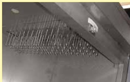
加熱レジスタによる電気加熱式タイプ、最高温度 450℃ と 600℃
