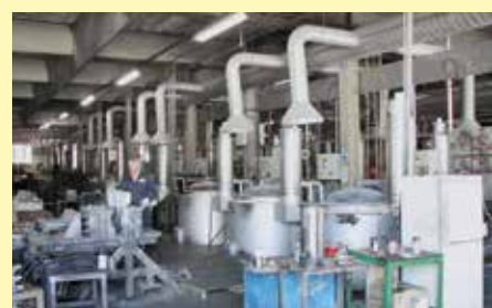
16 個の TBR 110/12 および 2 個の TBR 180/12 から成る復熱式バーナーを装備したアルミ溶解炉
