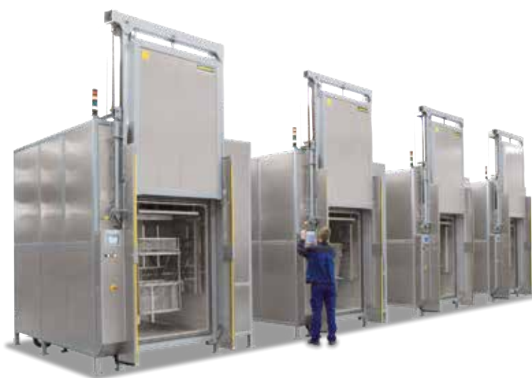
製造ユニット、熱処理中にワークを移動するための熱処理用チャンパー型乾燥機4台、エネルギー効率を最適化する三段階の熱交換器から成る。
