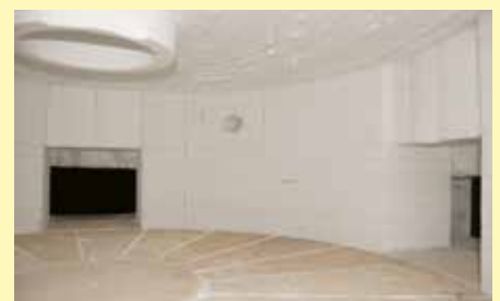
絶縁材を保護する耐火コンクリート製のサポートプレートのある回転テーブル
