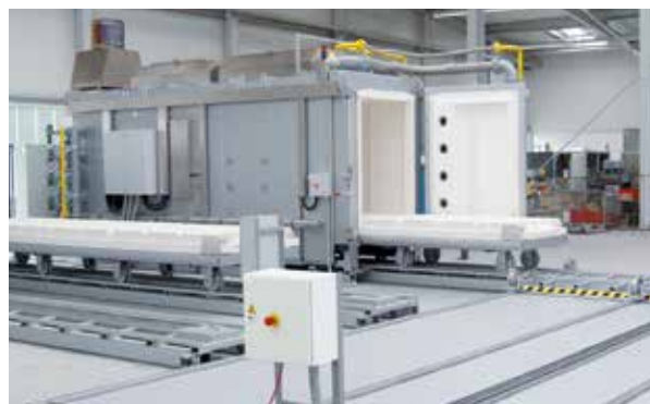
コンビネーション炉設備、ガス加熱ハースワゴン炉WB11000/HSとハースワゴン移送システムおよび補助ハースワゴン2台(待避レールも含む)から成る。
