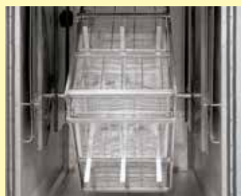
密封溶接された内室および充填用回転装置を装備したシリコン用アニール炉
