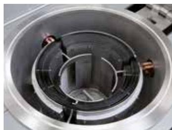
带钨丝加热装置的圆柱形气密罐
