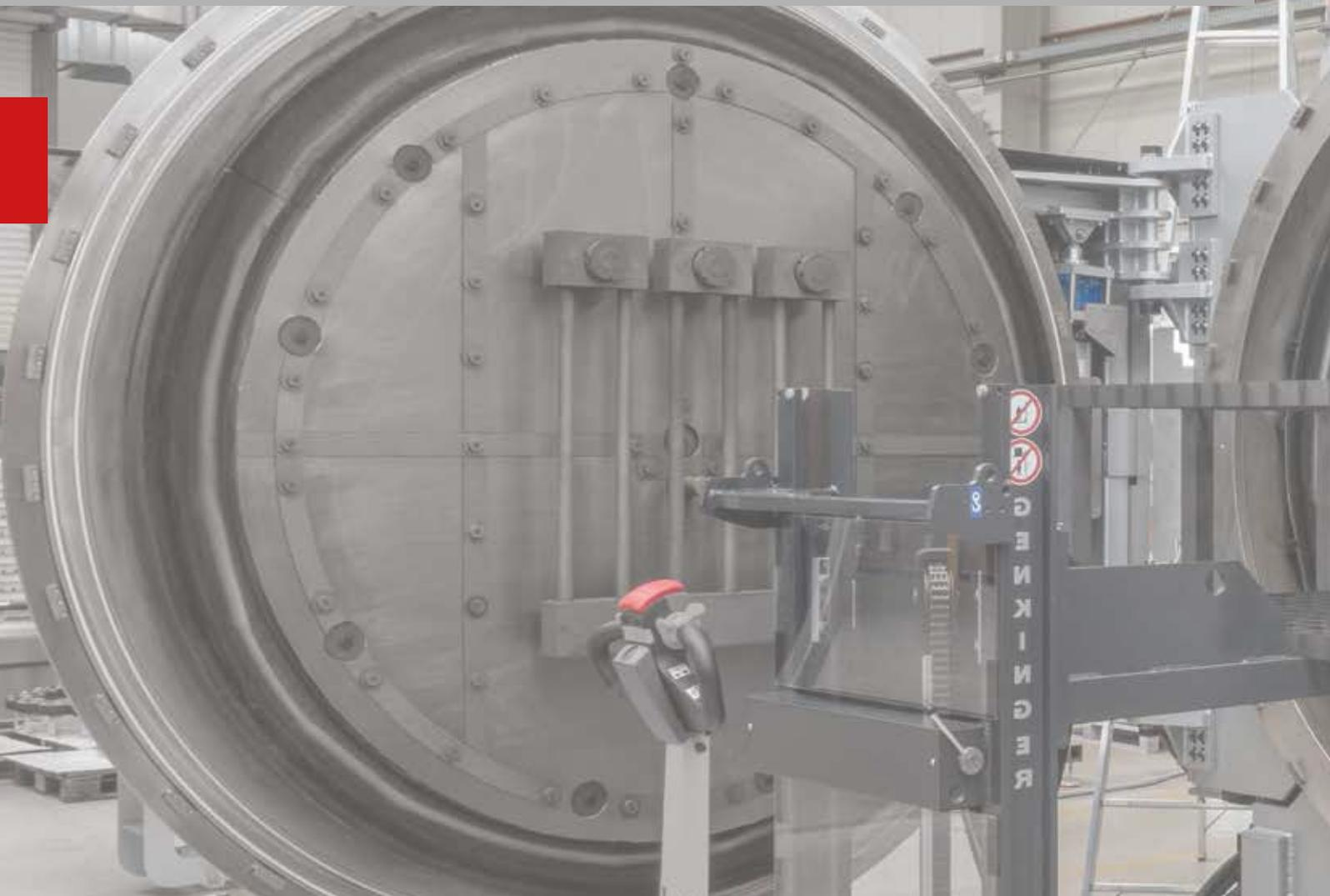
罐式炉用于明确的工艺气体气氛或在真空条件下的工艺，例如去应力退火。
