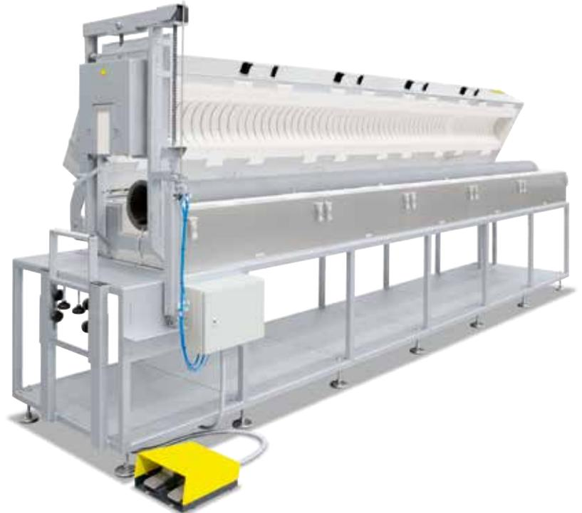
RS 200/4500/08带有升降门的用于对棒材进行热处理
