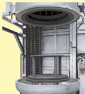
带石墨制加热炉腔的LBVHT型气密罐式炉
