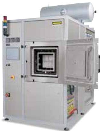
VHT 40/16-MO H型罐式炉带有氢气拓展工序包和工艺盒
