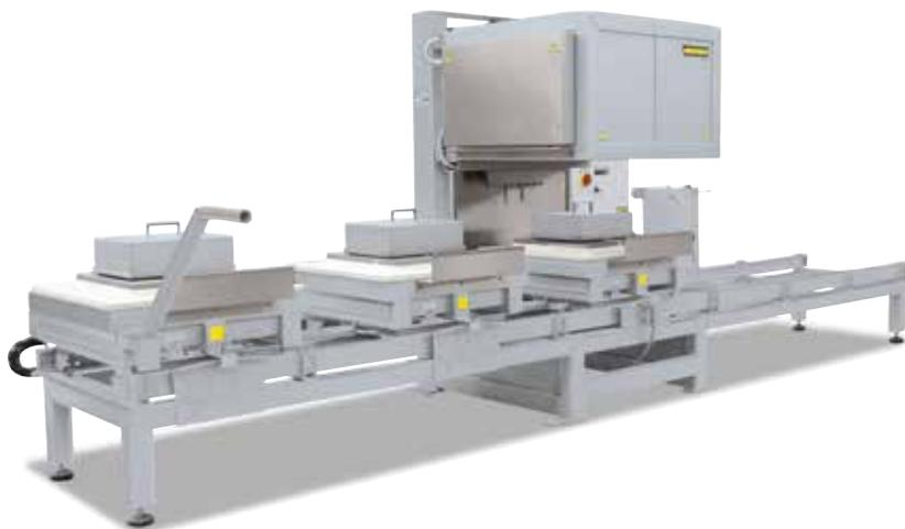
顶部升降炉系统带有三个更换的桌台和保护气盒，用于在不可燃保护气体或反应气体环境下进行热处理
