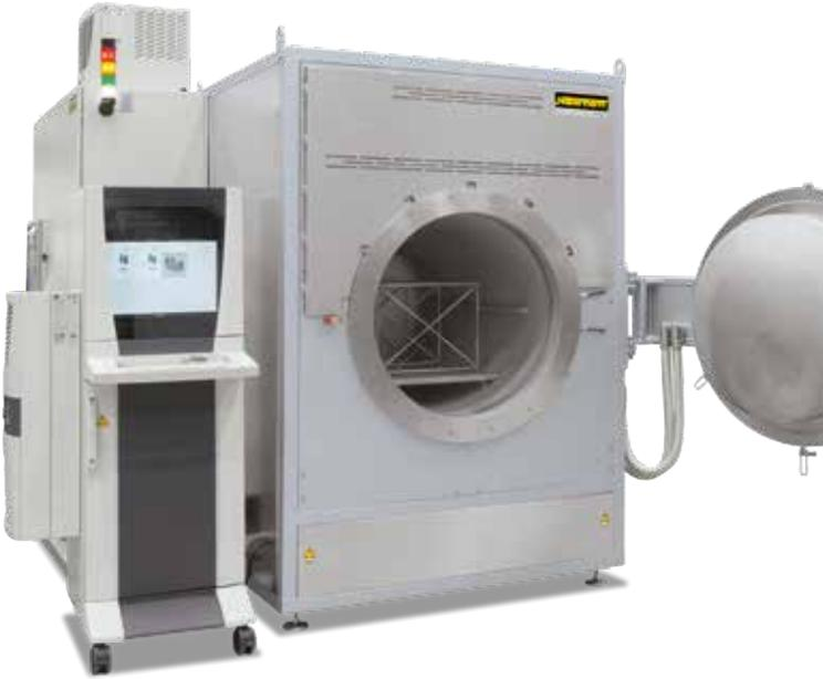
罐式炉NR 300/08用于高真空条件下的处理工艺，带有位于独立控制柜中的NCC软件
