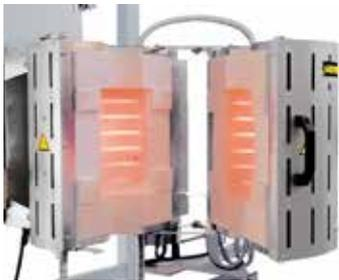
RS 100/250/11S，可折叠，可安装在一台检测试验装置内
