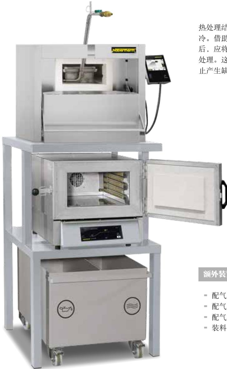
热处理结束后，将工件从淬火炉或供气盒中取出，然后放入油池或水池中骤冷。借助料筐，工件可以在池内不断移动，以确保均匀冷却。油池淬火结束后，应将工件放入水池中清洗、干燥，然后立即送入空气循环炉中进行回火处理。这样便可以使工件获得符合相应要求的最佳强度特性，减少变形并防止产生缺陷。
