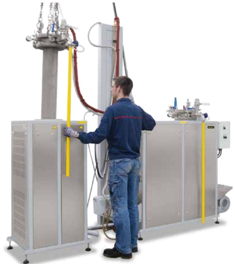
SR 170/1000/11型罐式炉，带可更换的气密罐和冷却系统
