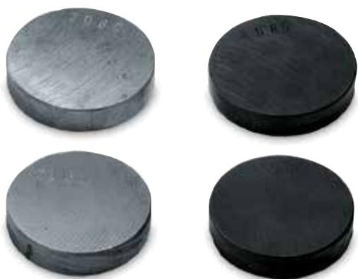
取自不同热处理工艺的试件
