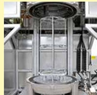
带测试架的罐式炉LBVHT 540/16-MO H<sub>2</sub>
