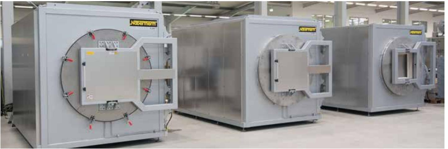
NR 1000/11型热壁罐式炉生产中的
