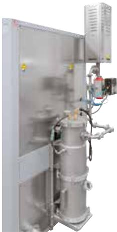
带有可选冷凝水收集器的高温二次燃烧装置
