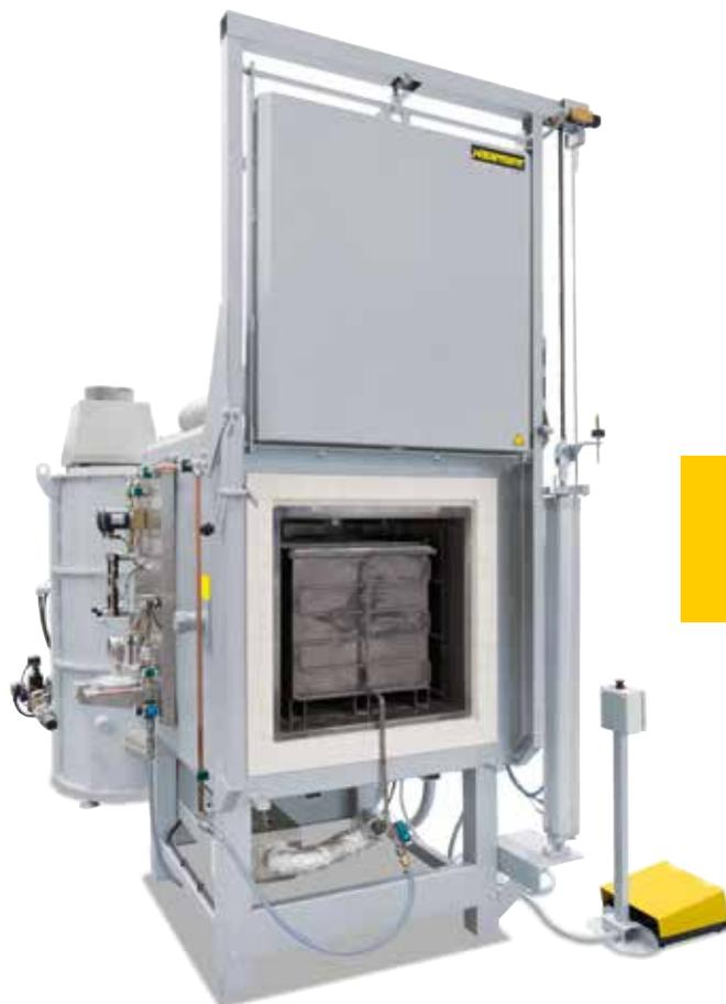
N 250/65 HA 1DB型空气循环箱式炉连同供气盒用于在保护气体下的惰性排胶，含热式式后燃系统（TNV）。也请参见先进材料目录册。
