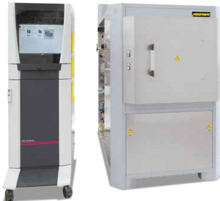
带IDB安全包的罐式炉NR 80/11，用于在不可燃保护气下的排胶，带有位于独立控制柜中的NCC软件
