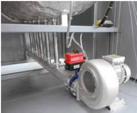
NRA 400/03型热壁罐式炉的鼓风机冷却
