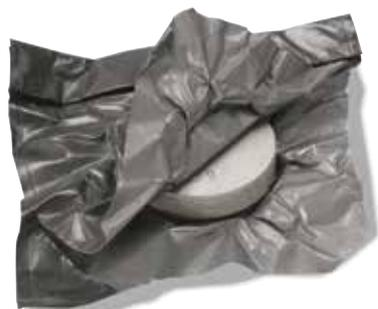
为防止单个工件发生脱碳，可以从不锈钢箔卷上取下一段箔膜包裹工件、或将工件装入预制好的封袋或封罩内。箔卷有不同的长度和宽度供应、封袋和封罩亦有不同的尺寸选择。
