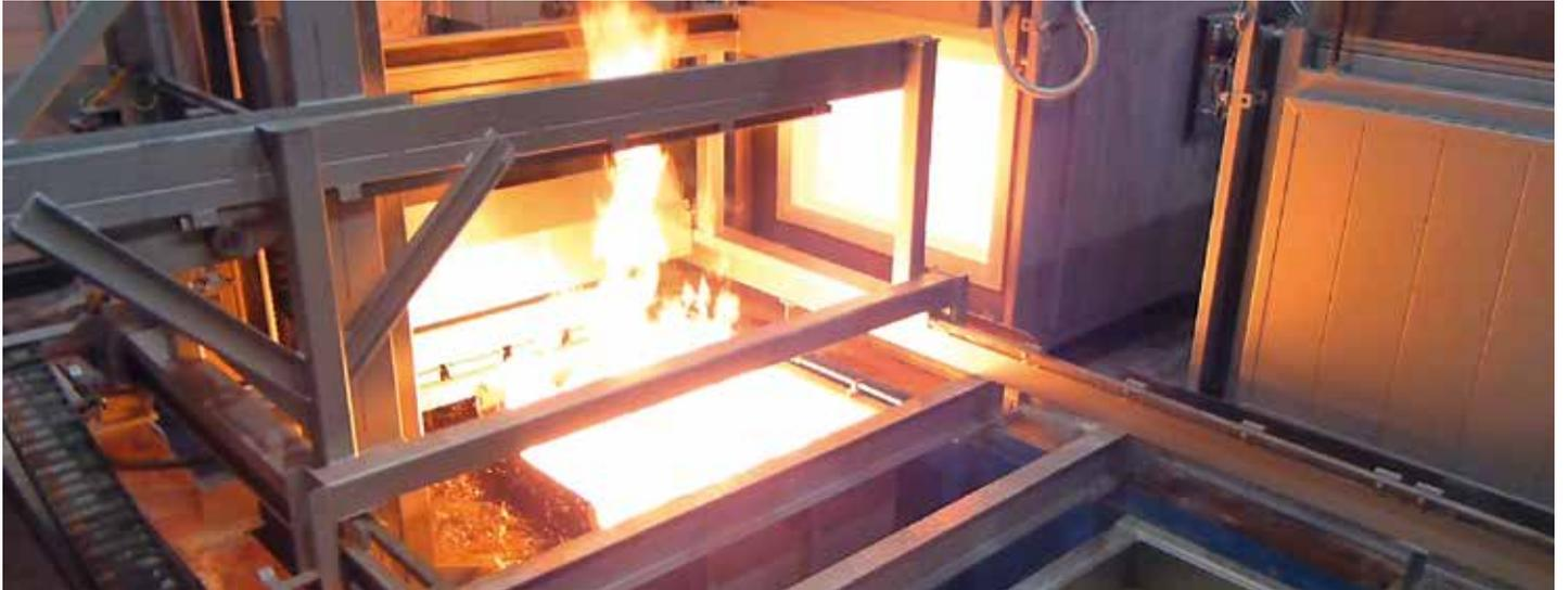
金属的热处理通常在保护气体、反应气体中或在真空中完成，这样就能避免部件氧化或将这种可能性降到最低限度。
