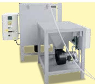
带保护气密封盖的SAL 120/85型井式炉以及炉旁的冷却站
