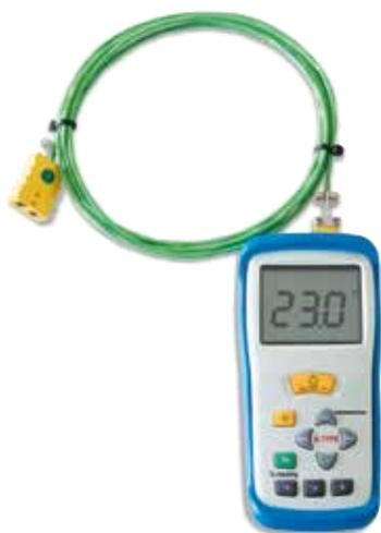
建议使用温度测量装置来测量供气盒或带支架的退火袋中的确切热处理温度。热电偶作为标准配置安装在纳博热供气盒或退火袋支架中。一个简单的带LCD显示器的手持测量设备可用于温度测量。该设备配备了一个两针连接器，用于连接热电偶。因此，如果需要，可以在控制器上确定和重新调整温度。
