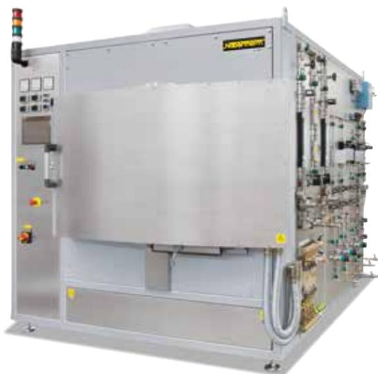
Retortenofen NRA 300/09 H<sub>2</sub> für die Wärmebehandlung unter Wasserstoff
