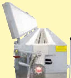
Drahtdurchziehofen auf Basis eines Rohr-ofens mit einer Länge von 6 Metern
