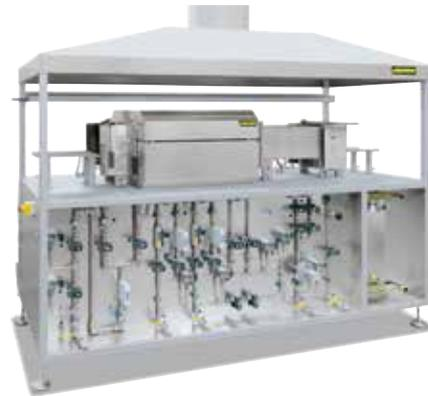
Manueller Durchschubofen mit Kühlkanal für Wasserstoff bis 1250 °C
