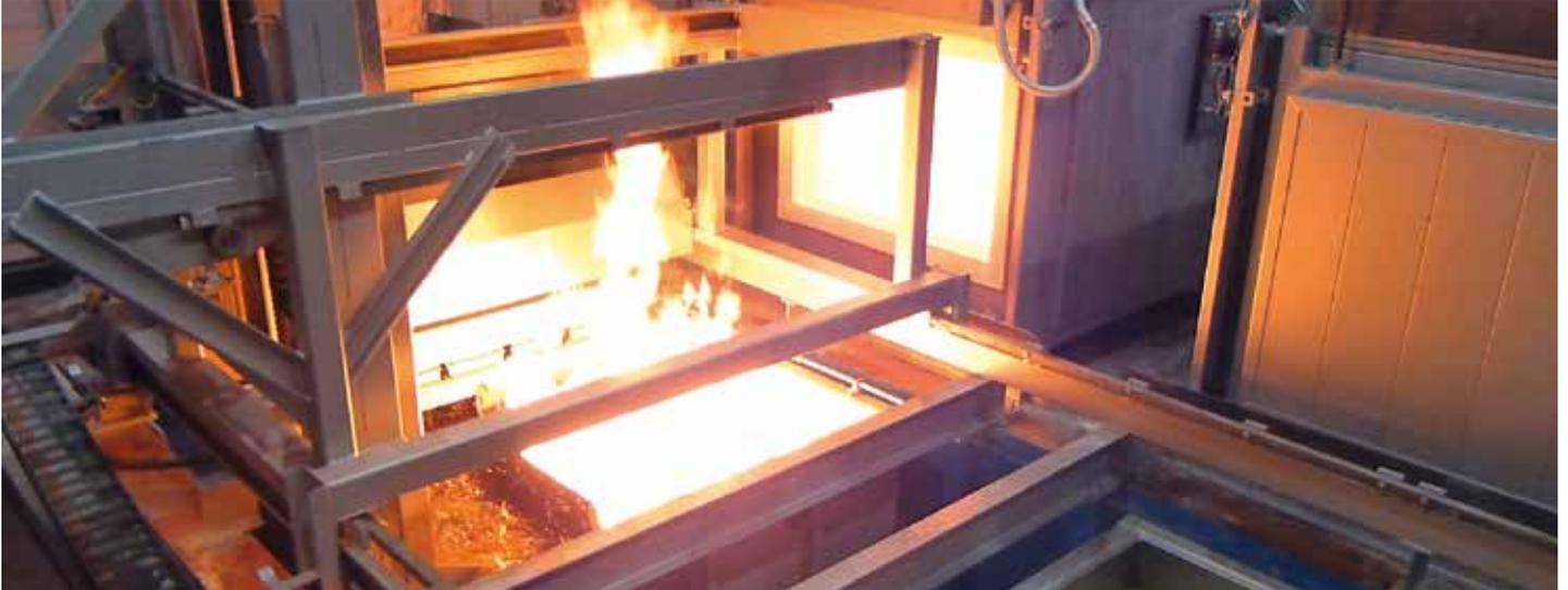
Wärmebehandlungen von Metallen erfolgen in der Regel unter Schutz-, Reaktionsgasen oder im Vakuum, um eine Oxidation der Bauteile zu verhindern bzw. zu minimieren.
