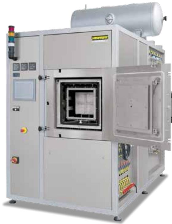
Retortenofen VHT 40/16-MO H<sub>2</sub> mit Erweiterungspaket für Wasserstoff und Prozesseinsatzkasten
