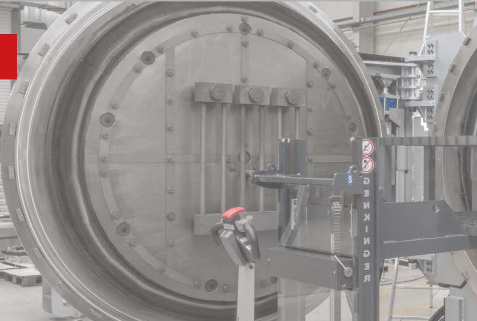
Retortenöfen für Prozesse mit einer definierten Prozessgasatmosphäre oder unter Vakuum wie zum Beispiel dem Spannungsarmglühen.
