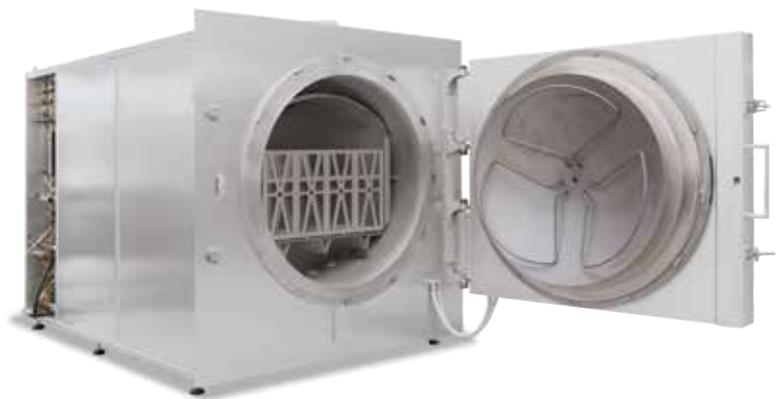
Heißwand-Retortenöfen NRA 1700/06 mit Beladegestell. Für die Installation im Grauraum mit Beladetür im Reinraum für die Wärmebehandlung von Glas unter Schutzgas.
