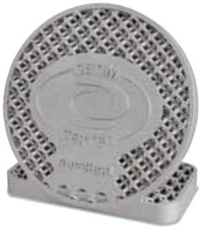
Gedrucktes Bauteil aus Aluminium, wärmebehandelt im Modell N 250/85 HA (Hersteller CETIM CERTEC auf SUPCHAD Plattform)
