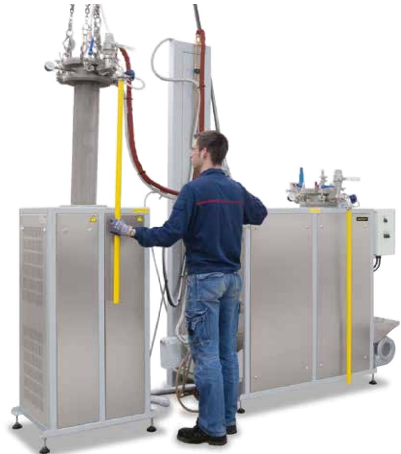
Retortenofen SR 170/1000/11 mit Wechselretorte und Kühlstation
