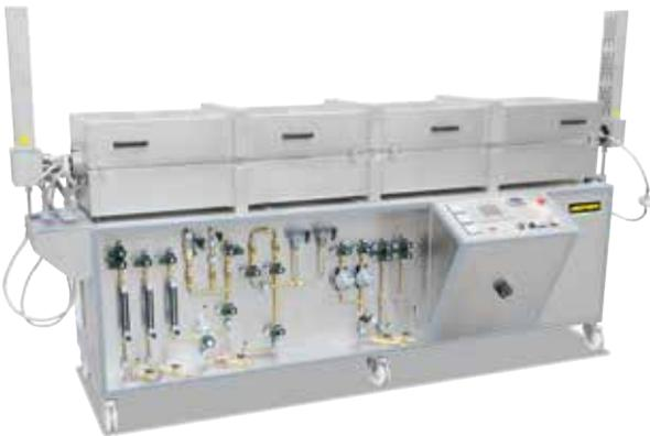
Durchziehofen in modularer Bauweise zum Betrieb unter Wasserstoffatmosphäre mit elektrisch beheizten Fackeln an den Enden
