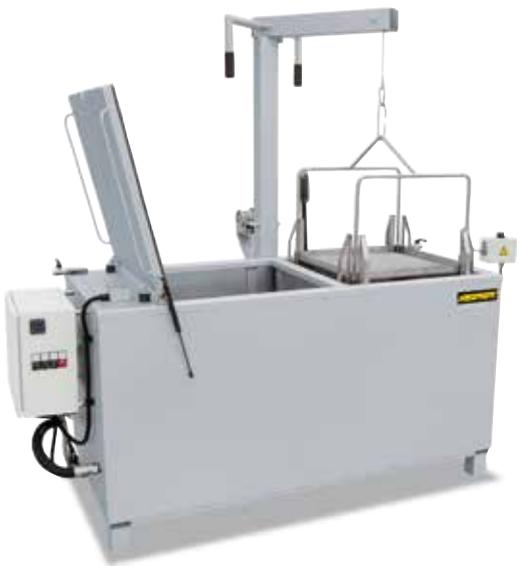
Bei den Kombibädern Q 200 D, Q 400 D und Q 600 D sind Öl- und Wasserbäder in einem Gehäuse zusammengefasst und durch eine Blechwand getrennt. Als Zusatzausstattung stehen Beschickungshilfen zur Verfügung. Das Kombibad Q 200 D wird mit Chargenträger geliefert, für die Modelle Q 400 D und Q 600 D ist dieses als Zusatzausstattung verfügbar. Für höhere Abschreckleistungen können die Bäder mit Ölkühlern ausgerüstet werden.
