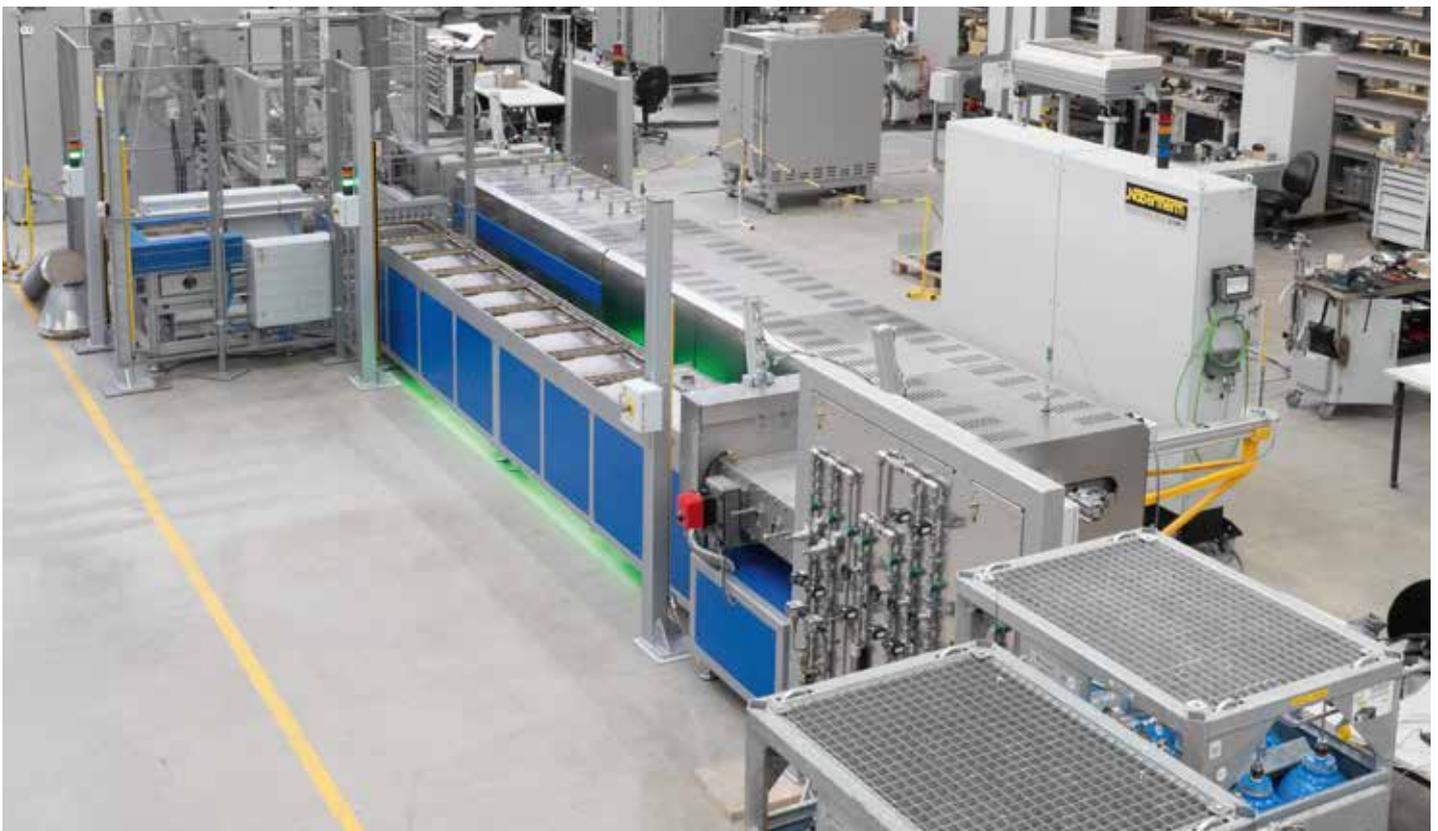
Durchstoßofenanlage D 520/2600/55-04 S zur Sinterung von Teflonbeschichtungen unter Schutzgas
