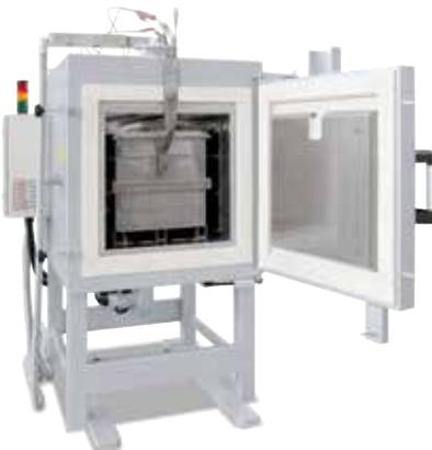
Umluft-Kammerofen NA 250/85 mit Begasungskasten für Wärmebehandlungen unter Schutzgasatmosphäre
