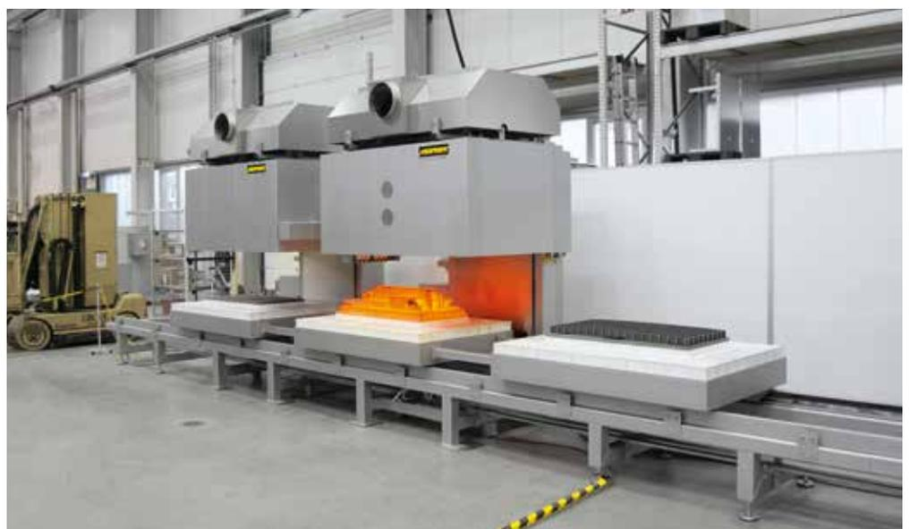
Automatische Vergüteanlage bestehend aus einem Haubenofen und zwei Kühlhauben zur forcierten Luftabkühlung (zweite Kühlhaube rechts nicht im Bild) mit Wechseltischsystem
