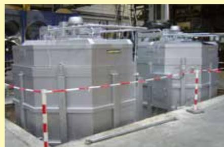
Umluft-Schachtöfen SAH 5600/75 S in der Produktion
