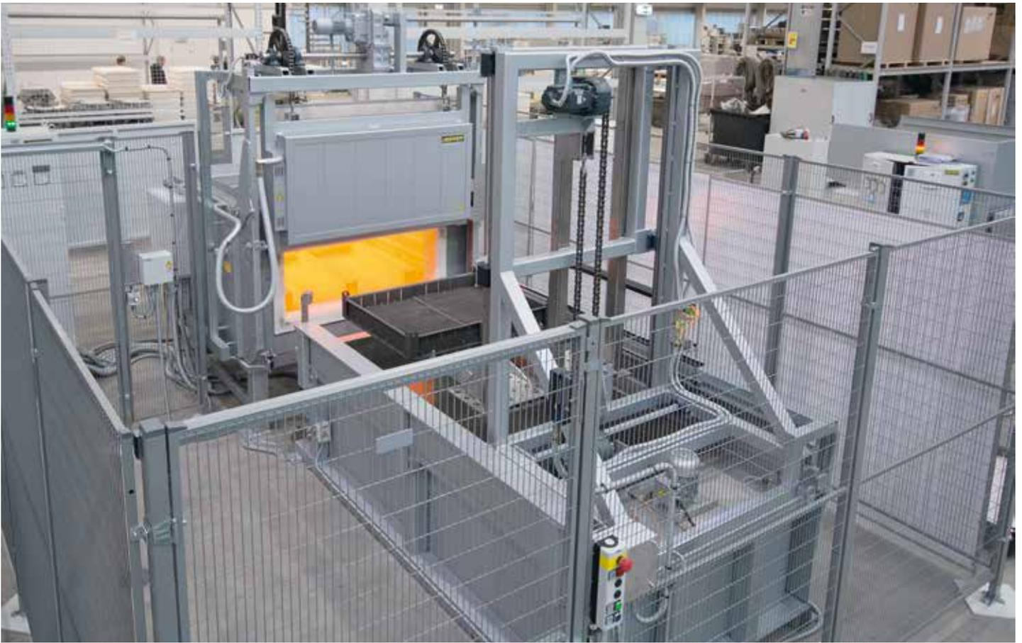
Vollautomatische Vergüteanlage bestehend aus einem Glühofen, einem Wasserabschreckbad und einem zweiachsigen Manipulator
