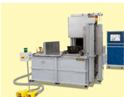
Halbautomatische Vergüteanlage für Aluminium
