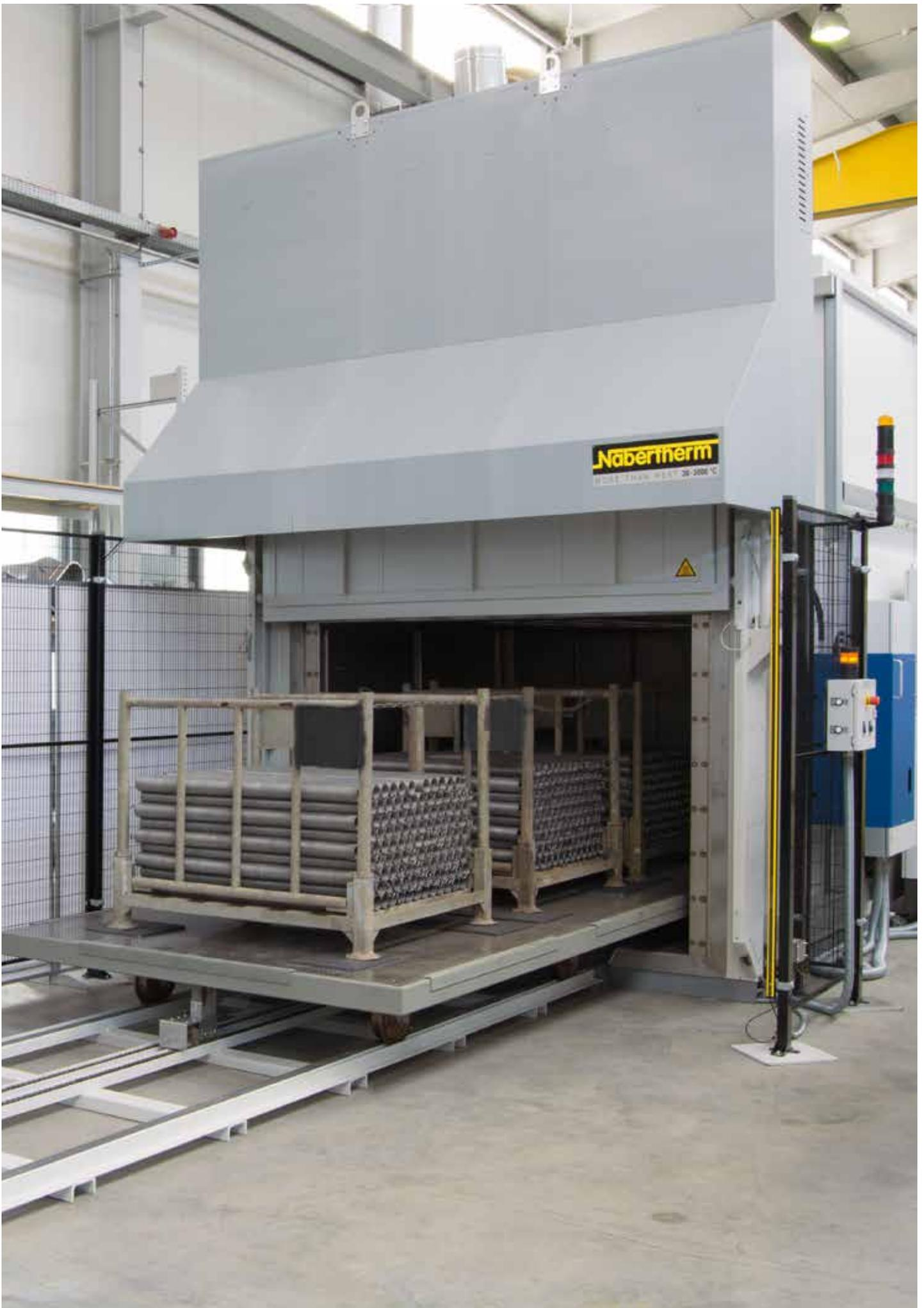
Direkt gasbeheizter Umluft-Kammerofen NB 10080/26HAS mit angetriebenem Chargenwagen
