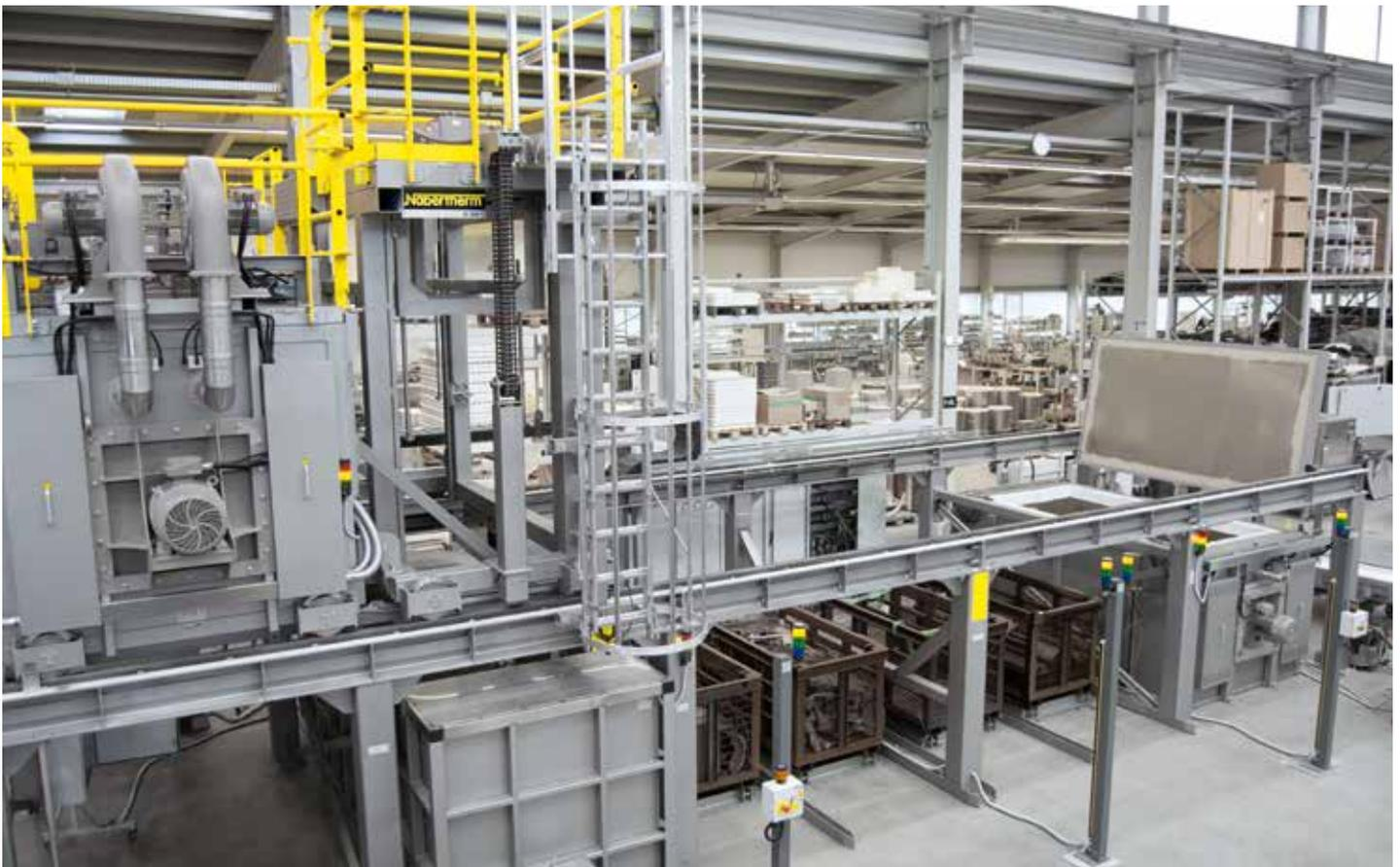
Verfahrbarer Fallschachtofen zum Lösungsglühen mit Schachtofen zum Warmauslagern mit vier Stellplätzen
