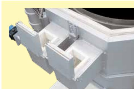
Motorische Frischluft- und Abluftklappensteuerung
