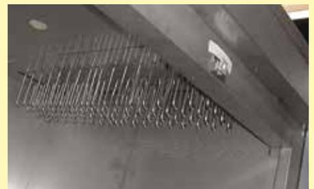
Heizregister bei elektrisch beheizter Ausführung mit Tmax 450 °C und 600 °C
