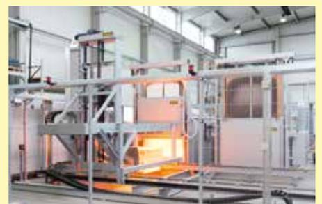
Vollautomatische Vergüteanlage für Stahl
