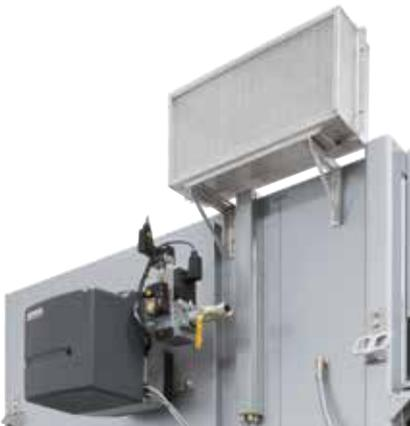
Direkte Gasbeheizung an einem Kammertrockner
