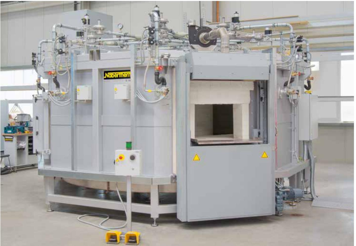
Direkt gasbeheizter Drehherdofen mit Tmax 1100 °C zum Vorwärmen von Formen
