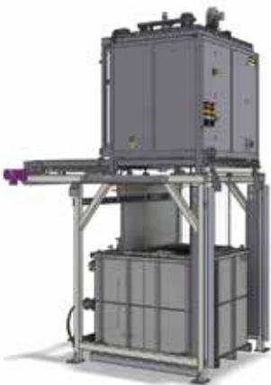
Abschreckbecken fest unter dem Fallschachtöfen. Beladung erfolgt manuell auf einem Rost zwischen Ofen und Bad. Prozess halbautomatisch.
