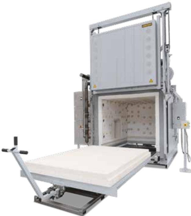
Gasbeheizter Herdwagenofen WB 6200/12 BO zum Ausbrennen von keramischen Isoliermaterialien
