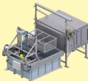
Vollautomatische Vergüteanlage für Glas
