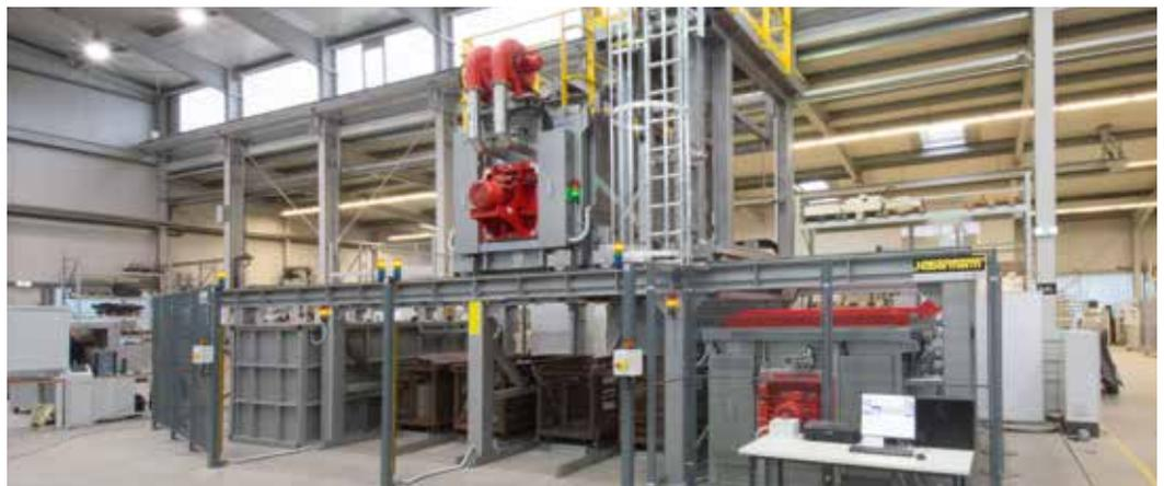
Fallschachtofenanlage für Aluminium
