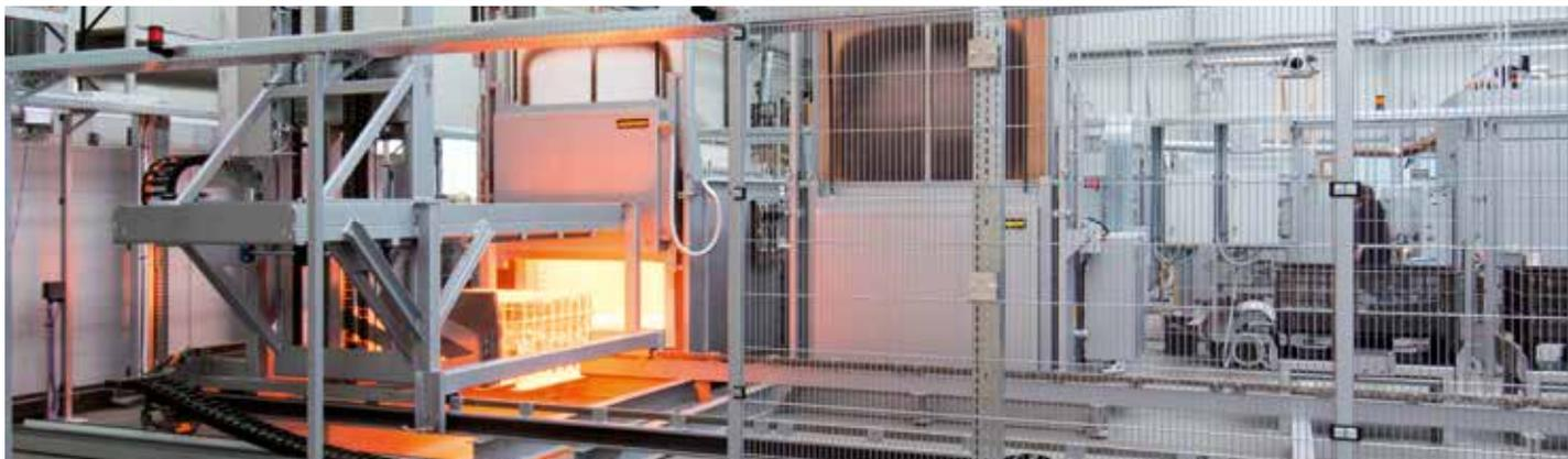
Für Prozesse wie die T6-Wärmebehandlung von Aluminium (Lösungsglühen, Abschrecken und Auslagern) oder das Härten von Stahl kommen Vergüeanlagen zum Einsatz. Durch den Aufbau aus einem oder mehreren Öfen in Kombination mit einem Abschreckbecken bzw. einer Kühlstation kann der Vergüteprozess manuell, teilautomatisiert oder auch vollautomatisch durchgeführt werden.
