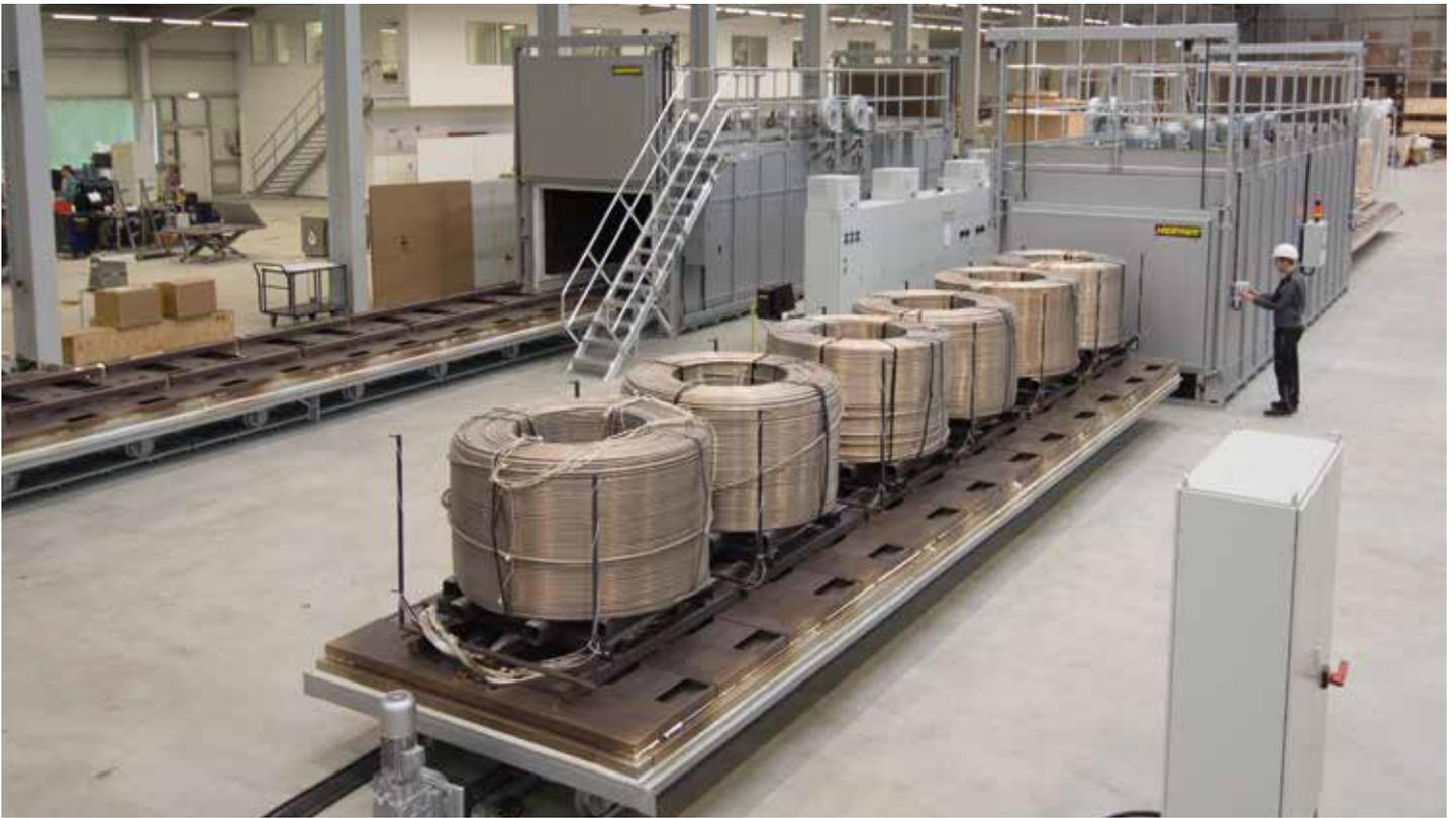
Umluft-Herdwagenofen W 24750/60AS für die Wärmebehandlung von Coils aus Aluminium
