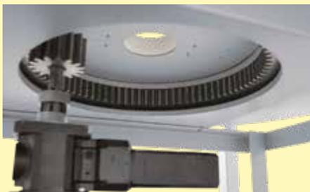
Zahnkranztrieb unter dem Drehherdofen
