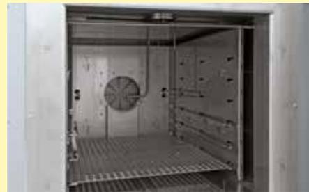
Innenraum mit Einlegeblech, Thermoelementen und Drucküberwachung
