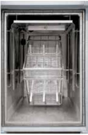
Motorisch angetriebenes Drehgestell mit eingesetzten Körben zum Bewegen der Charge während der Wärmebehandlung
