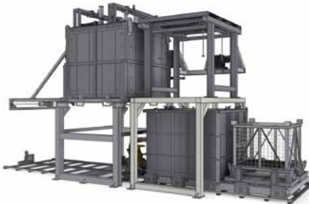
Fallschachtöfenanlage mit Abschreckbecken auf schienengeführten und Stellplatz für vollautomatische Prozesse mit Transferzeiten bis zu fünf Sekunden.
