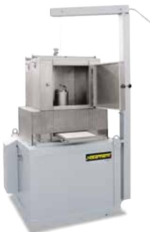
Salzbadofen TS 30/18 mit Vorwärmkammer oberhalb des Salzbad und Beschiebungshilfe zum Eintauchen der Charge
