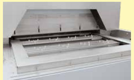
Durchlaufofen D 1000/1250/200/26AS zur Temperung von Spritzgussteilen
