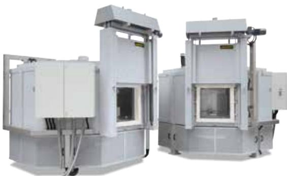
Elektrisch beheizte Umluft-Drehherdöfen mit Tmax 450 °C, vorbereitet für Automatikbetrieb
