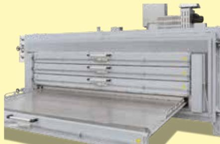
Schubladenofen NA 6700/26HAS mit 4 Schubladen zur Wärmebehandlung von flächigen Bauteilen
