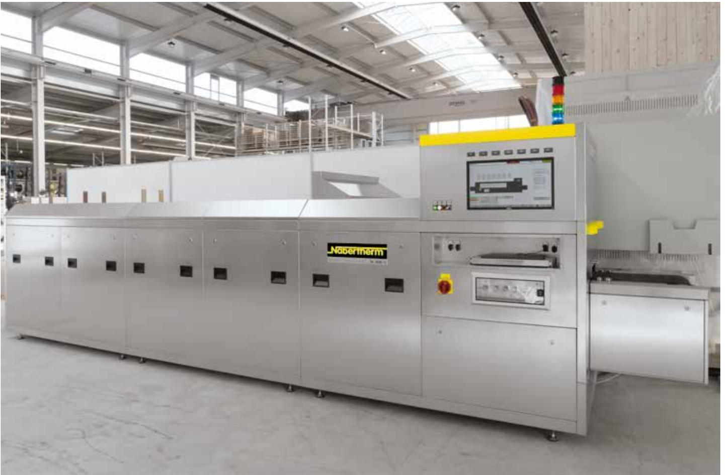
Durchlaufofen DF 36/320/5/10WK zum Ausbrennen und Einbrennen/Sintern bei LTCC-Anwendungen
