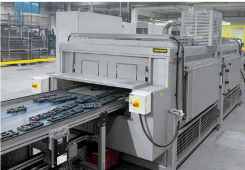
Banddurchlaufofen D 1000/4000/140/35 AS zur Trocknung von Schlichte auf Sandkernen
