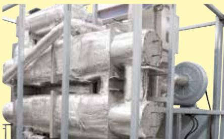
Gegenstrom-Wärmetauscher am Umluft-Kammerofen N 2560/26 ACLS
