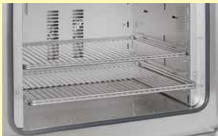
Herausziehbare Gitterroste zur Beladung des Trockenschranks in verschiedenen Ebenen
