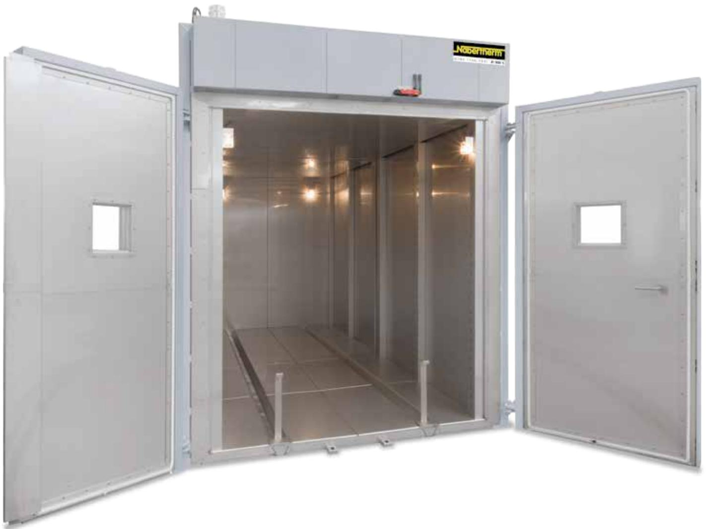
Kammertrockner KTR 22500/S mit Ofenraumbelichtung und Einfahrspuren mit Dichtschuhen zur Optimierung der Temperaturgleichmäßigkeit
