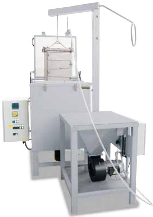
Schachtofen SAL 120/85 mit Schutzgaskasten und Kühlstation neben dem Ofen
