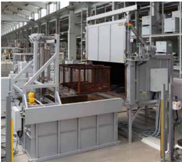
Horizontale Vergüteanlage bestehend aus Umluft-Kammerofen, zweiachsigen Manipulator und Wasserabschreckbad
