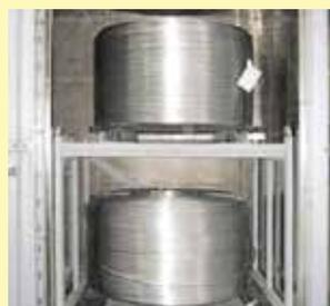
Wärmeübertragung zwischen einer warmen und einer kalten Charge
