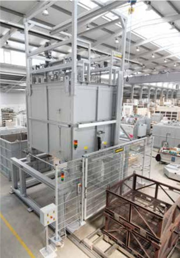
Fallschachtofen FS 5670/60AS mit eingelassenem Abschreckbad im Boden (Variante C)
