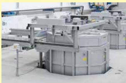
Umluft-Schachtöfen S 10400/75 AS in der Produktion
