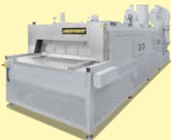
Durchlaufofen D 1500/3000/300/14 mit Maschengurt und nachgeschalteter Kühlstation
