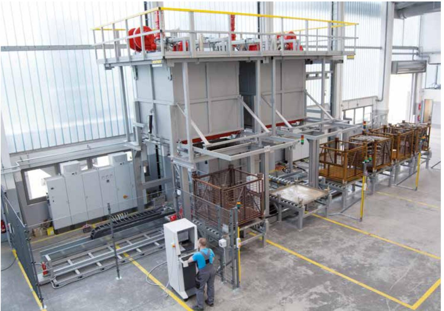
Vollautomatische Fallschachtofenanlage, bestehend aus zwei Fallschachttöfen, verfahrbarem Wasserbad und mehreren Belade- und Entnahmeplätzen
