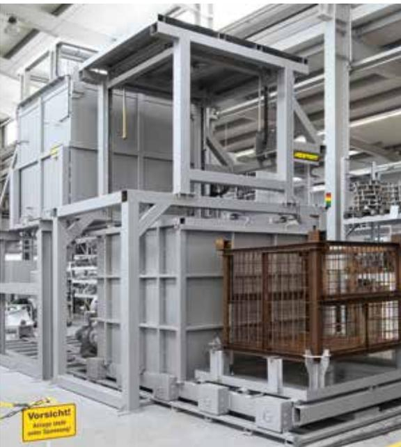
Vollautomatische Fallschachtofenanlage mit Endladekran (Variante B)
