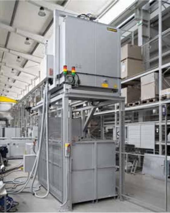
Fallschachtofenanlage mit feststehendem Abschreckbad (Variante A)
