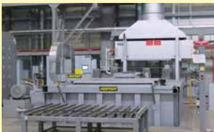
Ölabschreckbad OAB 67000 mit Wärmetauscher mit einem Inhalt von 67.000 Litern Öl
