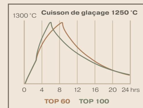
\*Cuisson de biscuit 950 °C, cuisson de glaçage 1250 °C. Poids de la charge y compris le support de cuisson : Top 60 - 18 kg, Top 100 - 30 kg. Prix de l'énergie calculé : 0,30 €/kWh.
