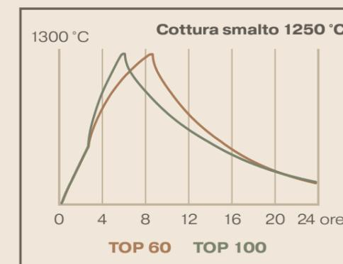
\*Prima cottura 950 °C, cottura smalto 1250 °C. Peso della carica inclusi i materiali ausiliari per la cottura: Top 60 - 18 kg, Top 100 - 30 kg. Ipotesi dei costi energetici di lavorazione: 0,30 €/kWh.
